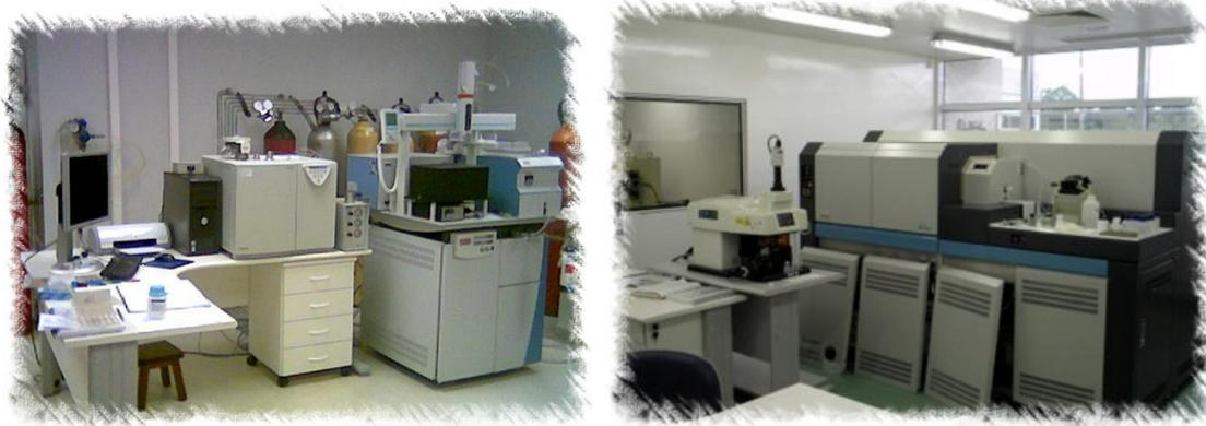
**Figura 3.1- Fotos dos Espectrometros Delta Advantage e Neptune respectivamente**
