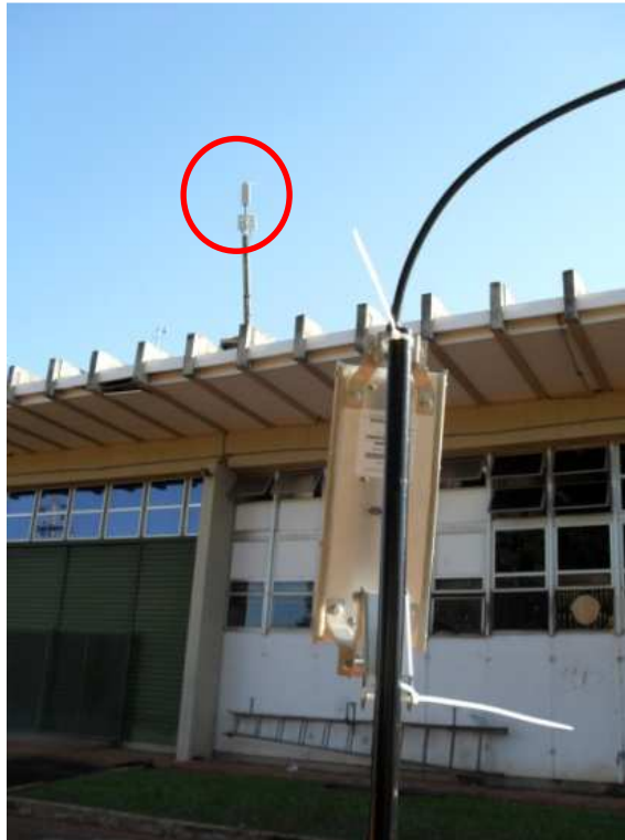
Figura 6.10 - Antenas diretivas na transmissão e na recepção, com uma distância de 24,662 metros entre transmissão e recepção
