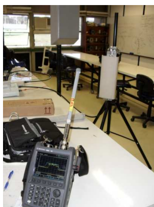
Figura 6.6 - Antena diretiva na transmissão e omni na recepção, distância de 1 metro entre transmissão e recepção
