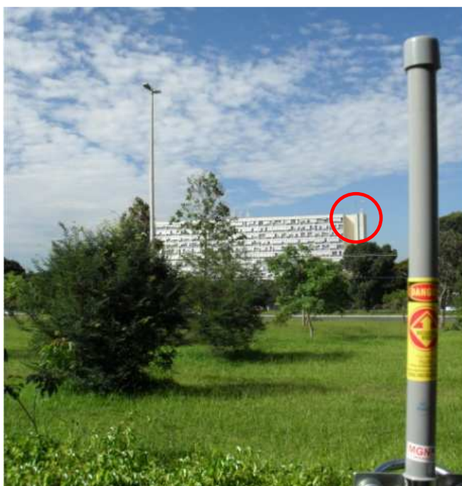
Figura 6.12 – Antena transmissora localizada no alto do prédio (marcado de vermelho) e antena receptora HG5808U da Hyperlink
