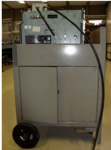
Figura 4.3 – Transmissor que se conecta a antena padrão (opera em frequência até 2GHz MHz)
