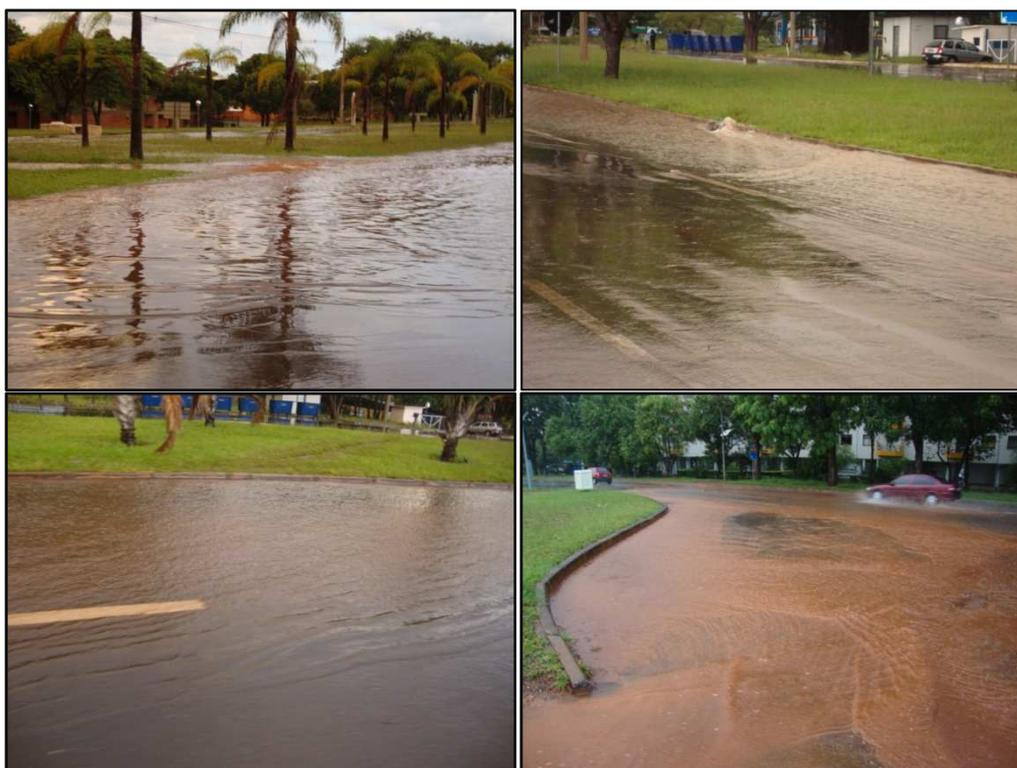
Figura 35: escoamento superficial em áreas impermeáveis na unidade hidrográfica do Lago Paranoá.
