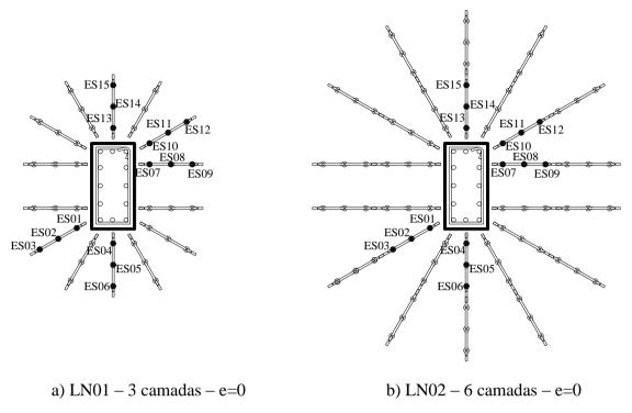
Figura 3.28 – Extensômetros monitorados nas armaduras de cisalhamento dos modelos N.
