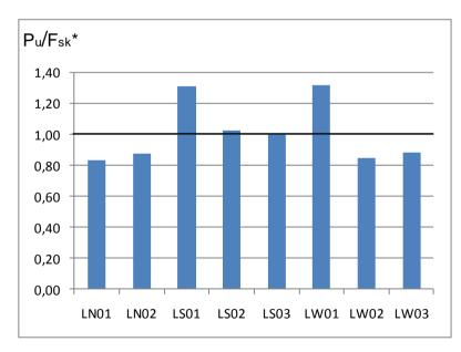
Figura 5.5 – Relação carga última de ensaio, P<sub>u</sub>, dividida pela carga estimada dentro da zona de armadura de cisalhamento sem restrição, F<sub>sk\*</sub>, pela NBR\* 6118:2003 para todos os modelos.
