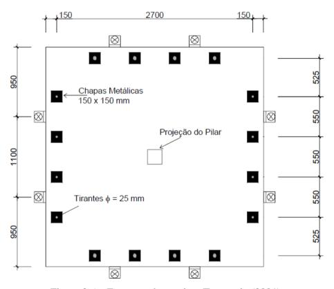
Figura 2.6 – Esquema de ensaio – Trautwein (2001).
