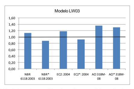
Figura 5.22 – Relação de carga última de ensaio e carga última estimada em todas as normas para o modelo LW03.
