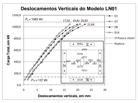
Figura 4.17 – Carga *versus* deslocamento do modelo LN01.
