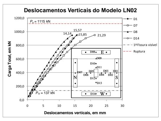
Figura 4.18 – Carga *versus* deslocamento do modelo LN02.
