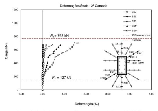
Figura 4.48 – Deformações na 2ª camada de studs do modelo LS02.
