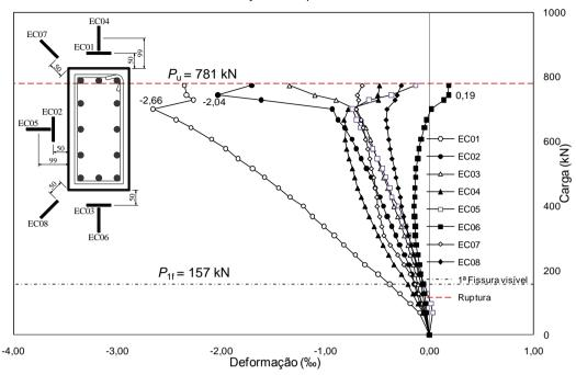
Figura 4.69 – Deformações na superfície do concreto do modelo LS03.
