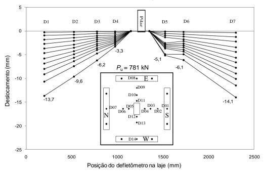
Figura 4.9 – Deslocamentos verticais na direção S-N do modelo LS03.
