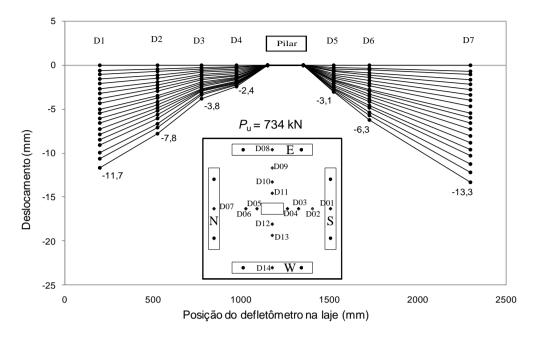
Figura 4.15 – Deslocamentos verticais na direção S-N do modelo LW03.
