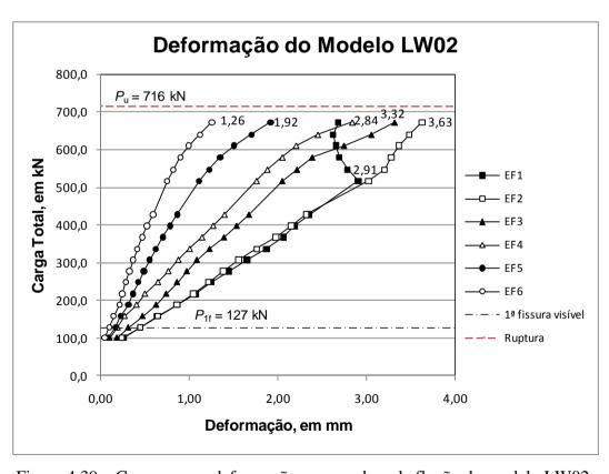
Figura 4.39 – Carga *versus* deformação na armadura de flexão do modelo LW02.
