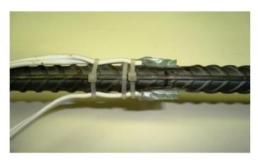
Figura 3.23 – Posição dos extensômetros da armadura de flexão.
