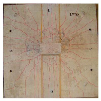
Figura 4.79 – Padrão de fissuração do modelo LW02.
