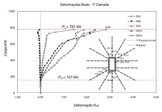
Figura 4.50 – Deformações na 1ª camada de *studs* do modelo LS03.
