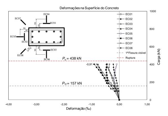
Figura 4.70 – Deformações na superfície do concreto do modelo LW01.
