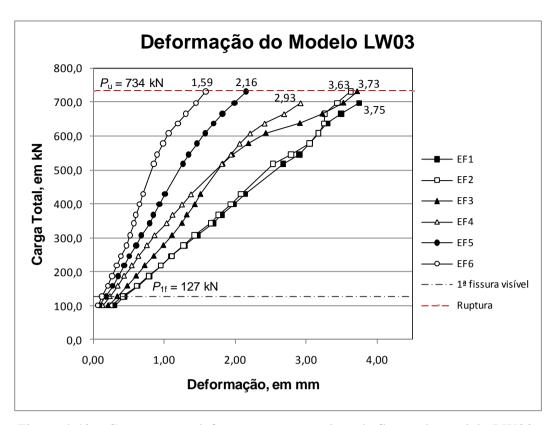
Figura 4.40 – Carga versus deformação na armadura de flexão do modelo LW03.
