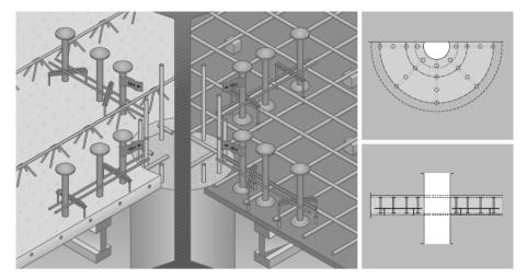
Figura 3.5 – Detalhes dos sistema de armaduras – SCHÖCK BOLE.
