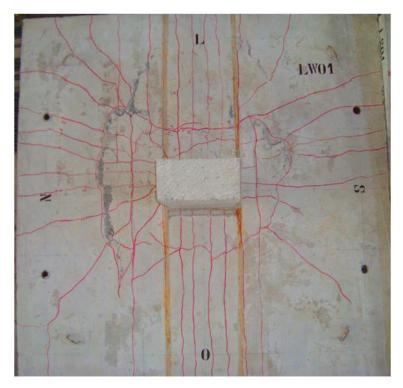
Figura 4.78 – Padrão de fissuração do modelo LW01.
