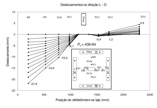
Figura 4.12 – Deslocamentos verticais na direção L-O do modelo LW01.
