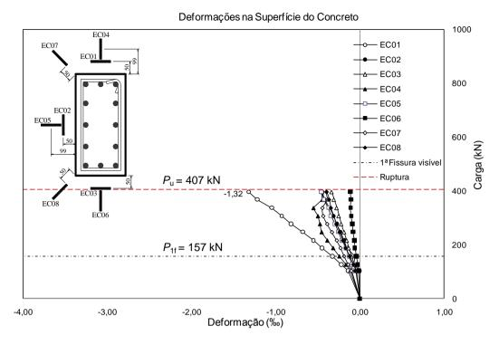
Figura 4.67 – Deformações na superfície do concreto do modelo LS01.
