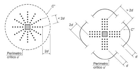
Figura 2.14 – Disposição da armadura de punção em planta e contorno da superfície crítica C" segundo a NBR 6118:2003
