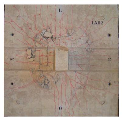
Figura 4.74 – Padrão de fissuração do modelo LN02.
