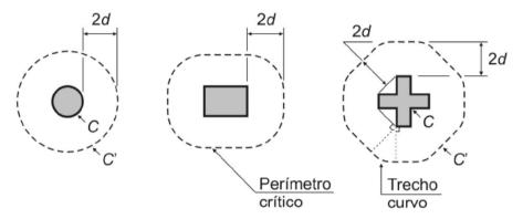
Figura 2.13 – Perímetro crítico em pilares internos segundo a NBR 6118:2003
