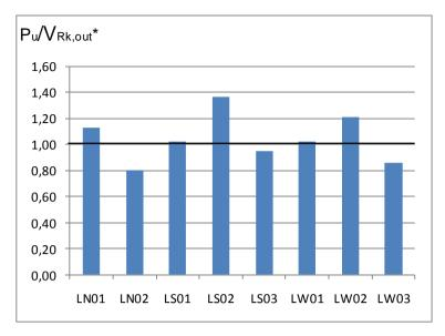
Figura 5.10 – Relação carga última de ensaio,  $P_u$ , dividida pela carga estimada fora da zona de armadura de cisalhamento sem obedecer restrições,  $V_{Rk,out}^*$ , pelo EUROCODE\* 2:2004 para todos os modelos.
