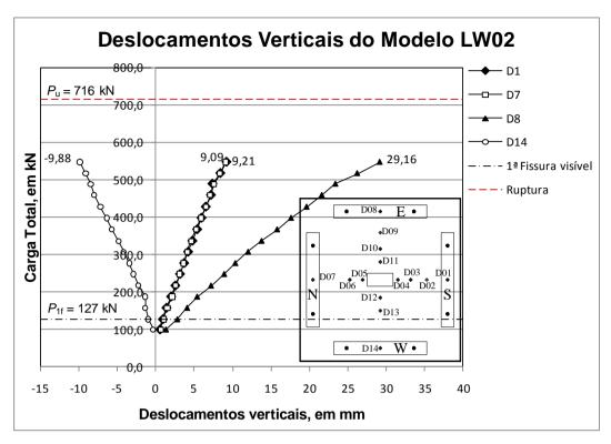
Figura 4.23 – Carga *versus* deslocamento do modelo LW02.
