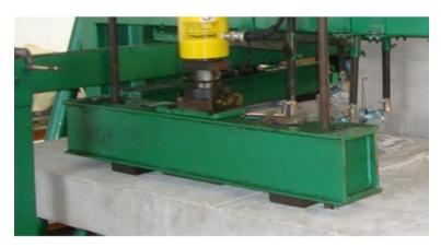
Figura 3.44 – Viga de distribuição da carga.
