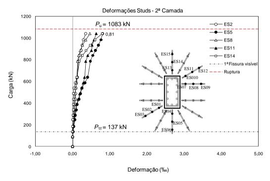
Figura 4.42 – Deformações na 2ª camada de studs do modelo LN01.
