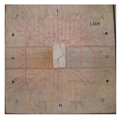
Figura 4.73 – Padrão de fissuração do modelo LN01.
