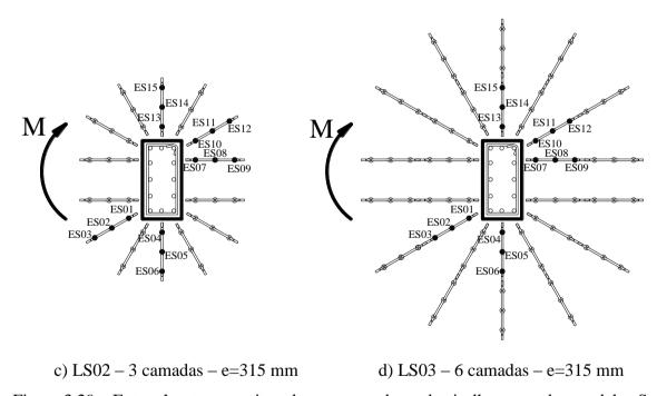
Figura 3.29 – Extensômetros monitorados nas armaduras de cisalhamento dos modelos S.
