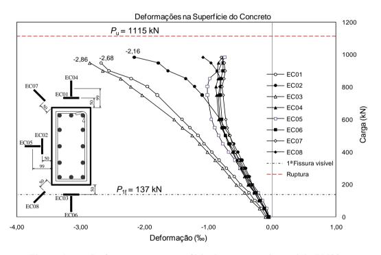
Figura 4.66 – Deformações na superfície do concreto do modelo LN02.
