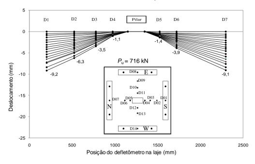
Figura 4.13 – Deslocamentos verticais na direção S-N do modelo LW02.
