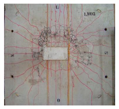
Figura 4.80 – Padrão de fissuração do modelo LW03.
