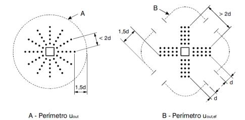
Figura 2.11 – Perímetro de controle externo à região com armaduras de cisalhamento segundo EUROCODE 2:2004
