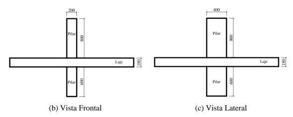
Figura 3.2 – Geometria básica de todos os modelos (em mm)
