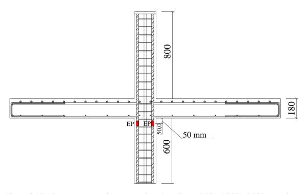
Figura 3.13 – Seção transversal com armadura dos pilares (LS01, LS02 e LS03) e posição dos EER.
