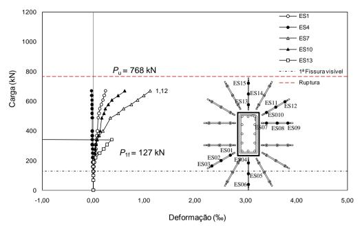
Figura 4.47 – Deformações na 1ª camada de *studs* do modelo LS02.
