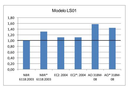
Figura 5.17 – Relação de carga última de ensaio e carga última estimada em todas as normas para o modelo LS01.
