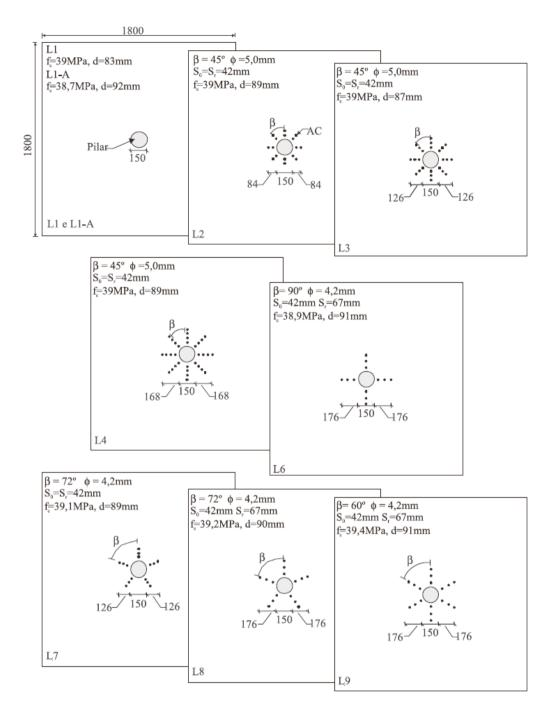
Figura 2.8 – Características das lajes ensaiadas – Vaz (2009)
