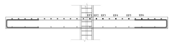
Figura 3.25 – Seção transversal com armadura de flexão (LN01,LN02, LS01, LS02 e LS03).
