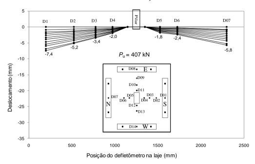
Figura 4.5 – Deslocamentos verticais na direção S-N do modelo LS01.
