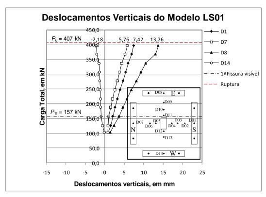
Figura 4.19 – Carga *versus* deslocamento do modelo LS01.
