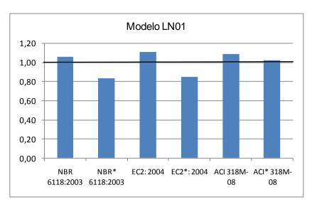
Figura 5.15 – Relação de carga última de ensaio e carga última estimada em todas as normas para o modelo LN01.
