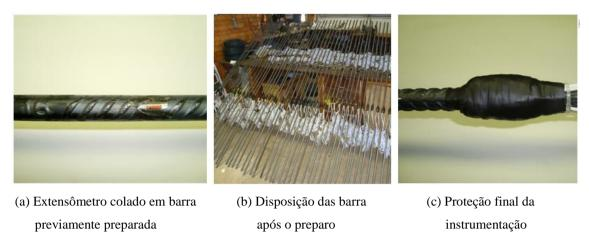
Figura 3.24 – Preparação da instrumentação.
