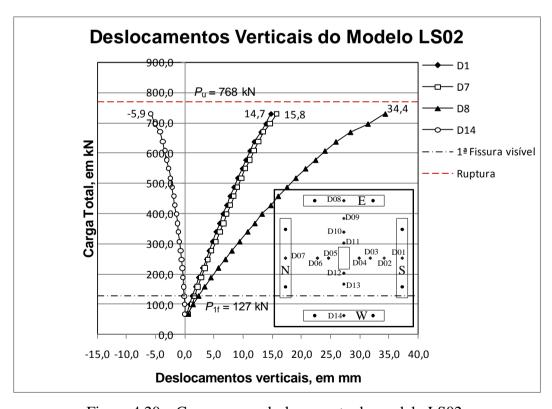
Figura 4.20 – Carga *versus* deslocamento do modelo LS02.
