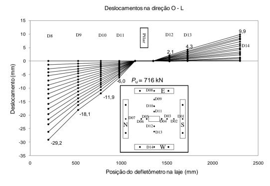
Figura 4.14 – Deslocamentos verticais na direção L-O do modelo LW02.
