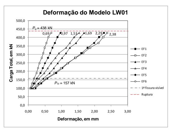
Figura 4.38 – Carga versus deformação na armadura de flexão do modelo LW01.
