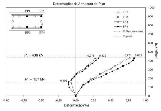
Figura 4.62 – Deformações na armadura do pilar do modelo LW01.
