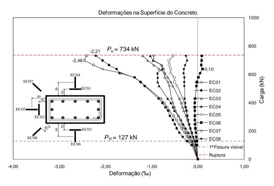
Figura 4.72 – Deformações na superfície do concreto do modelo LW03.
