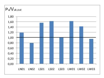
Figura 5.13 – Relação carga última de ensaio, P<sub>u</sub>, dividida pela carga estimada fora da zona de armadura de cisalhamento, V<sub>uk,out</sub>, pelo ACI 318M-08 para todos os modelos.
