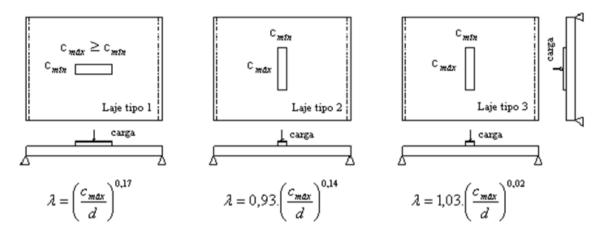
Figura 2.5 – Proposta para classificação das lajes com pilares retangulares e o fator de flexão – Oliveira (2003)
