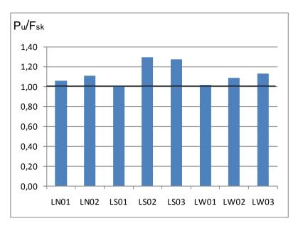
Figura 5.4 – Relação carga última de ensaio, P<sub>u</sub>, dividida pela carga estimada dentro da zona de armadura de cisalhamento, F<sub>sk</sub>, pela NBR 6118:2003, para todos os modelos.
