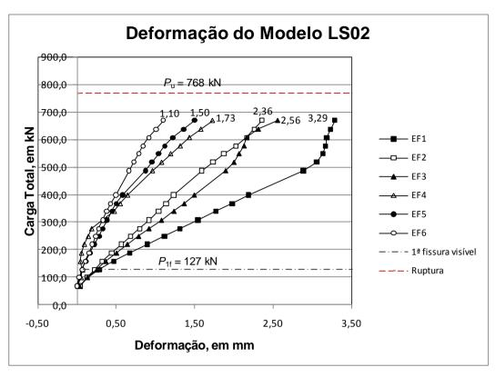
Figura 4.36 – Carga versus deformação na armadura de flexão do modelo LS02.
