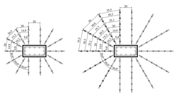
(a) Espaçamento dos *studs* para 3 camadas (b) Espaçamento dos *studs* para 6 camadas Figura 3.10 – Espaçamento da armadura de cisalhamento dos modelos LW01, LW02 e LW03.
