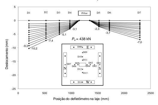
Figura 4.11 – Deslocamentos verticais na direção S-N do modelo LW01.
