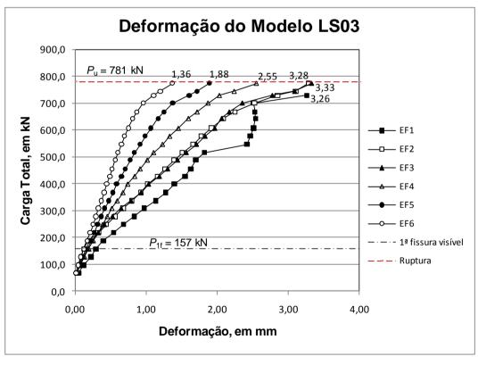
Figura 4.37 – Carga versus deformação na armadura de flexão do modelo LS03.
