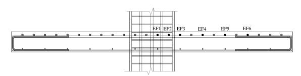
Figura 3.26 – Seção transversal com armadura de flexão (LW01, LW02 e LW03).
