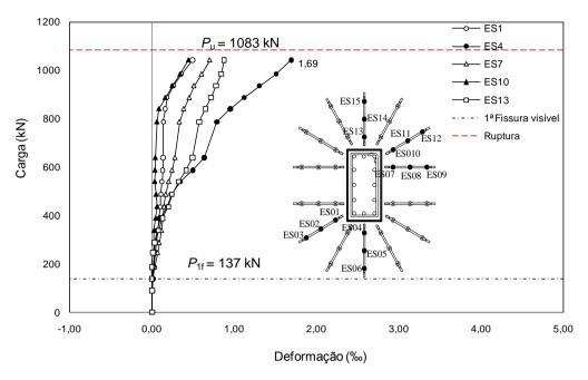
Figura 4.41 – Deformações na 1ª camada de studs do modelo LN01.
