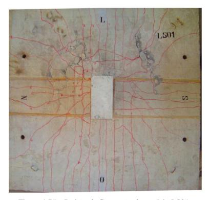
Figura 4.75 – Padrão de fissuração do modelo LS01.
