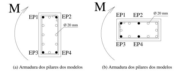
Figura 3.12 – Detalhamento da armadura dos pilares na seção transversal, com indicação das barras instrumentadas com EER.
