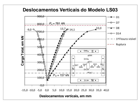
Figura 4.21 – Carga *versus* deslocamento do modelo LS03.
