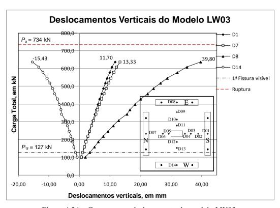
Figura 4.24 – Carga *versus* deslocamento do modelo LW03.
