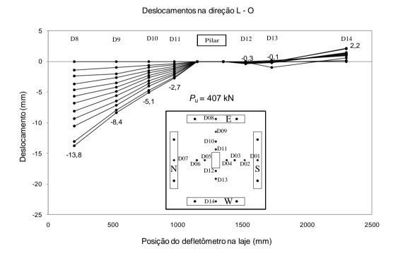
Figura 4.6 – Deslocamentos verticais na direção L-O do modelo LS01.
