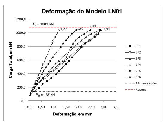
Figura 4.33 – Carga versus deformação na armadura de flexão do modelo LN01.
