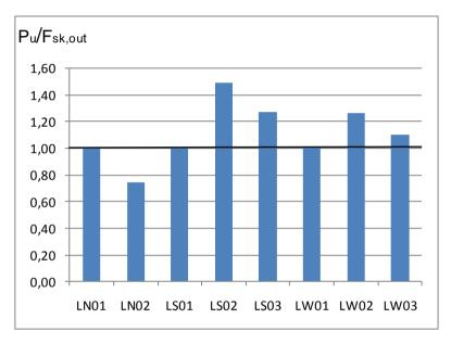
Figura 5.6 – Relação carga última de ensaio,  $P_u$ , dividida pela carga estimada fora da zona de armadura de cisalhamento,  $F_{sk,out}$ , pela NBR 6118:2003 para todos os modelos.
