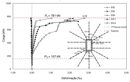
Figura 4.51 – Deformações na 2ª camada de *studs* do modelo LS03.
