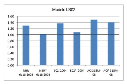
Figura 5.18 – Relação de carga última de ensaio e carga última estimada em todas as normas para o modelo LS02.
