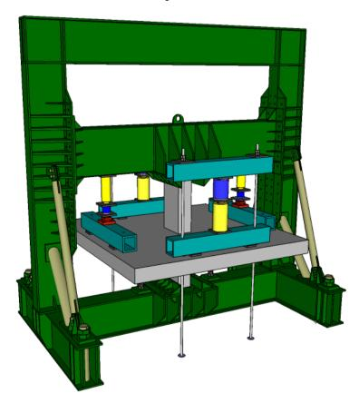
Figura 3.36 – Esquema de ensaio do pórtico metálico.
