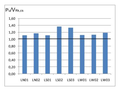
Figura 5.7 – Relação carga última de ensaio,  $P_u$ , dividida pela carga estimada dentro da zona de armadura de cisalhamento,  $V_{Rk,cs}$ , pelo EUROCODE 2:2004 para todos os modelos.
