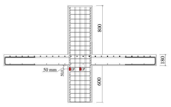
Figura 3.14 – Seção transversal com armadura dos pilares (LW01, LW02 e LW03) e posição dos EER.
