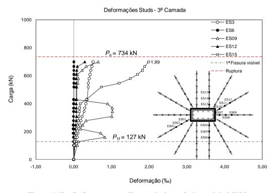
Figura 4.58 – Deformações na 3ª camada de studs do modelo LW03.
