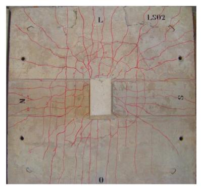
Figura 4.76 – Padrão de fissuração do modelo LS02.
