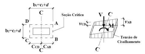
Figura 2.12 – Localização da seção crítica para pilar interno e suposta distribuição das tensões de cisalhamento pelo ACI 318M-02
