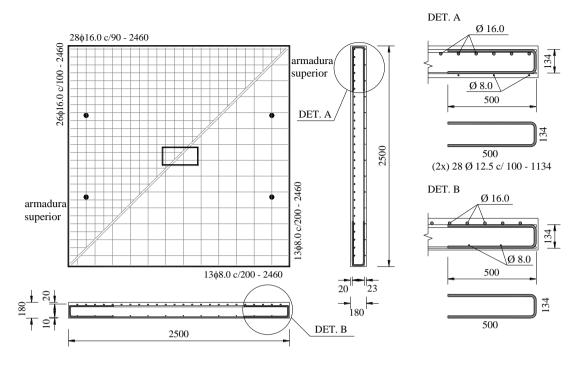
Figura 3.4 – Armadura inferior para todas as lajes dos modelos LW01, LW02 e LW03.
