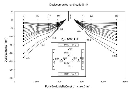
Figura 4.1 – Deslocamentos verticais na direção S-N do modelo LN01.
