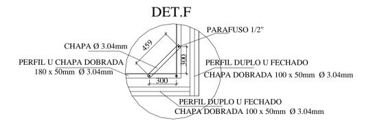
Figura 3.16 – Detalhe F do projeto da fôrma metálica.
