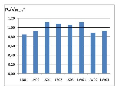
Figura 5.8 – Relação carga última de ensaio,  $P_u$ , dividida pela carga estimada dentro da zona de armadura de cisalhamento sem obedecer restrições,  $V_{Rk,cs}$ \*, pelo EUROCODE\* 2:2004 para todos os modelos.
