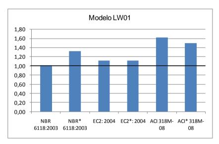
Figura 5.20 – Relação de carga última de ensaio e carga última estimada em todas as normas para o modelo LW01.
