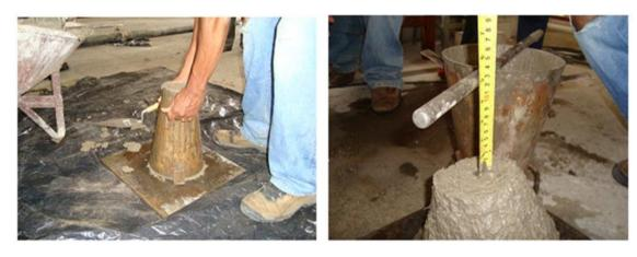
Figura 3.20 – Teste de abatimento do tronco de cone.
