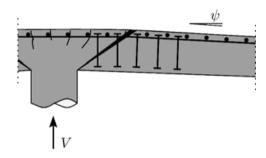
(b) Laje cinemática com abertura de fissura de cisalhamento crítica.
