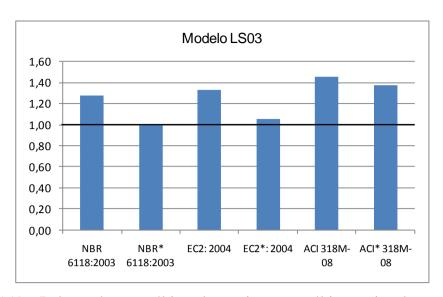
Figura 5.19 – Relação de carga última de ensaio e carga última estimada em todas as normas para o modelo LS03.
