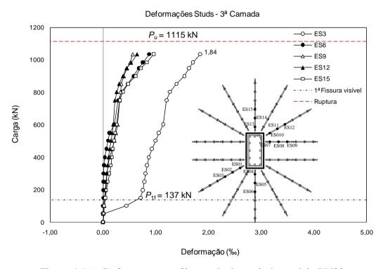
Figura 4.46 – Deformações na 3ª camada de studs do modelo LN02.
