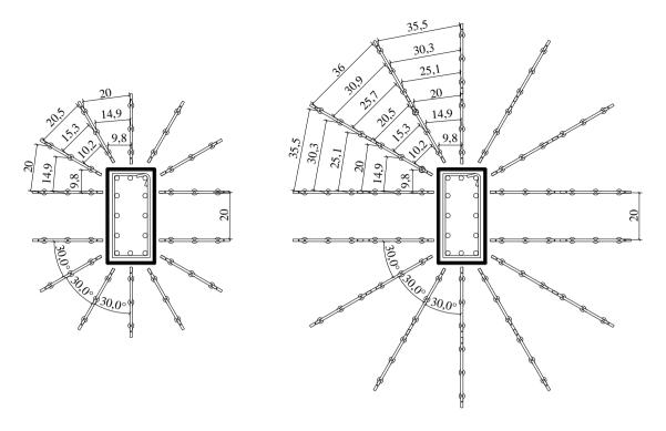
(a) Espaçamento dos *studs* para 3 camadas (b) Espaçamento dos *studs* para 6 camadas Figura 3.9 – Espaçamento da armadura de cisalhamento dos modelos LN01, LN02, LS01, LS02 e LS03.
