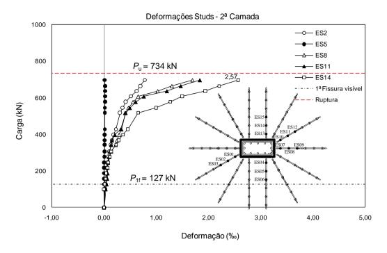
Figura 4.57 – Deformações na 2ª camada de studs do modelo LW03.
