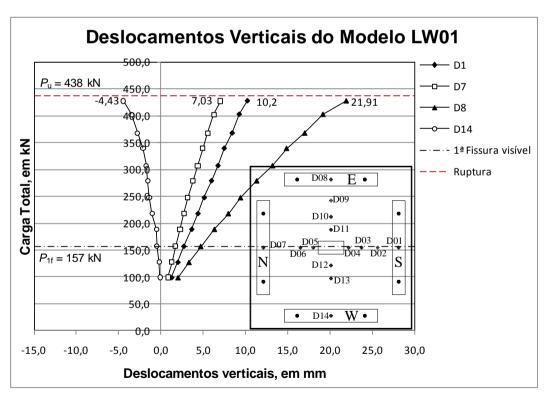
Figura 4.22 – Carga *versus* deslocamento do modelo LW01.
