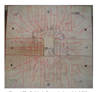
Figura 4.77 – Padrão de fissuração do modelo LS03.
