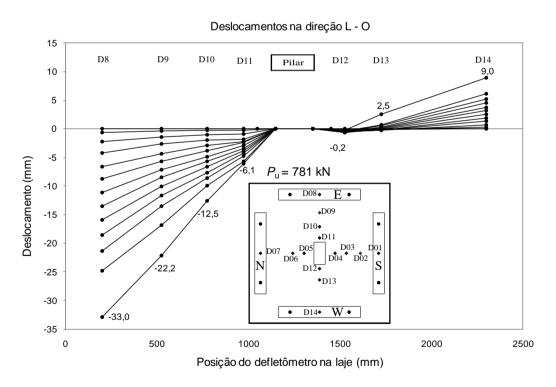
Figura 4.10 – Deslocamentos verticais na direção L-O do modelo LS03.
