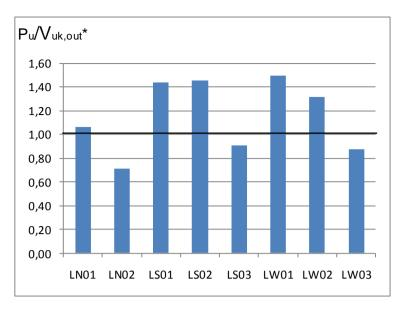
Figura 5.14 – Relação carga última de ensaio, P<sub>u</sub>, dividida pela carga estimada fora da zona de armadura de cisalhamento sem obedecer restrições, V<sub>uk,out</sub>\*, pelo ACI\* 318M-08 para todos os modelos.
