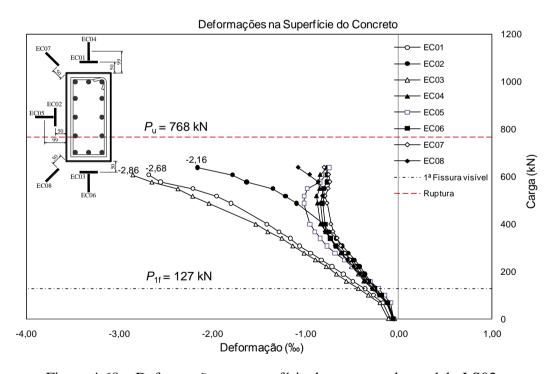
Figura 4.68 – Deformações na superfície do concreto do modelo LS02.
