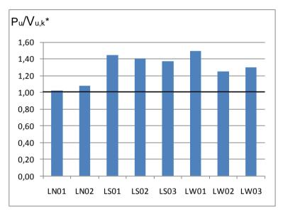
Figura 5.12 – Relação carga última de ensaio,  $P_u$ , dividida pela carga estimada dentro da zona de armadura de cisalhamento sem obedecer restrições,  $V_{u,k}^*$ , pelo ACI\* 318M-08 para todos os modelos.
