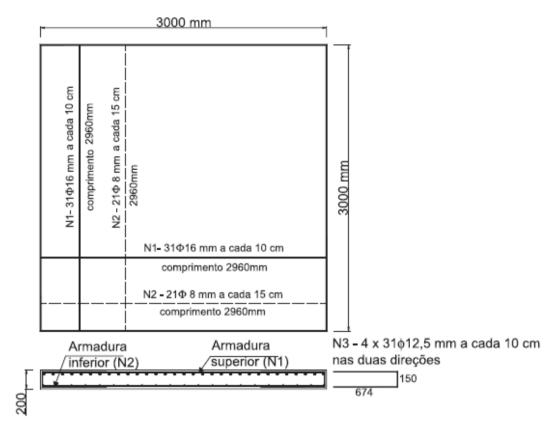
Figura 2.7 – Detalhamento da armadura de flexão – Trautwein (2001)
