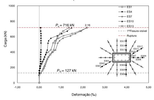
Figura 4.53 – Deformações na 1ª camada de studs do modelo LW02.
