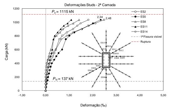
Figura 4.45 – Deformações na 2ª camada de *studs* do modelo LN02.
