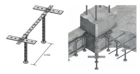
Figura 3.6 – Detalhes do sistema de armaduras – HALFEN DEHA (2007).
