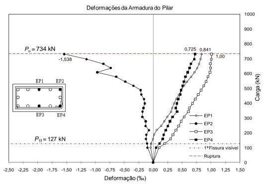
Figura 4.64 – Deformações na armadura do pilar do modelo LW03.
