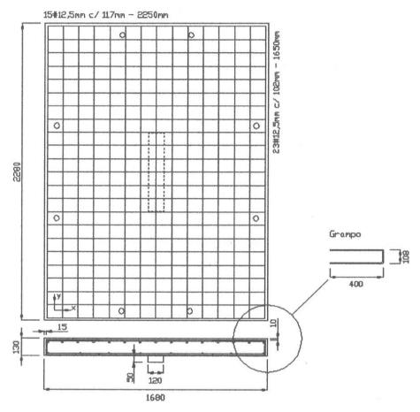
Figura 2.4 – Armadura superior e grampos de ancoragem – Oliveira (2003)
