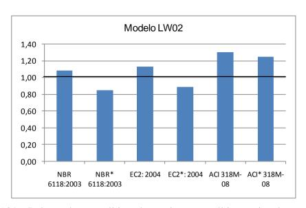
Figura 5.21 – Relação de carga última de ensaio e carga última estimada em todas as normas para o modelo LW02.
