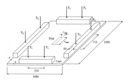
Figura 2.3 – Posição do carregamento nas lajes – Oliveira (2003)
