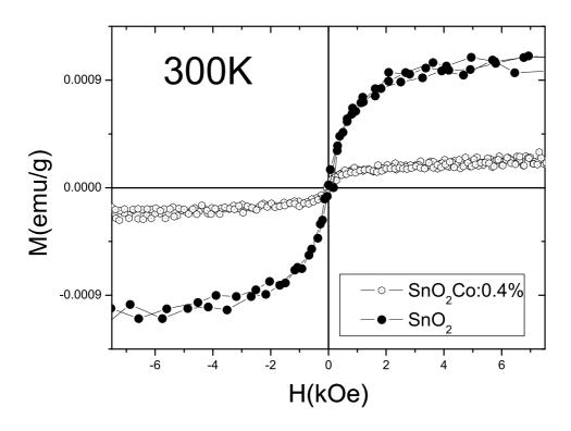
Figura 5.15: Comparação do ordenamento ferromagnético de  $SnO_2$  com  $SnO_2$  dopado com 0.4% de cobalto.
