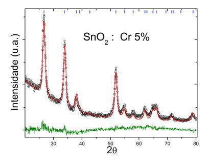
Figura 4.16: Ajuste pelo método de Rietveld para a amostra de  $SnO_2$  dopada com 5% de Cr.
