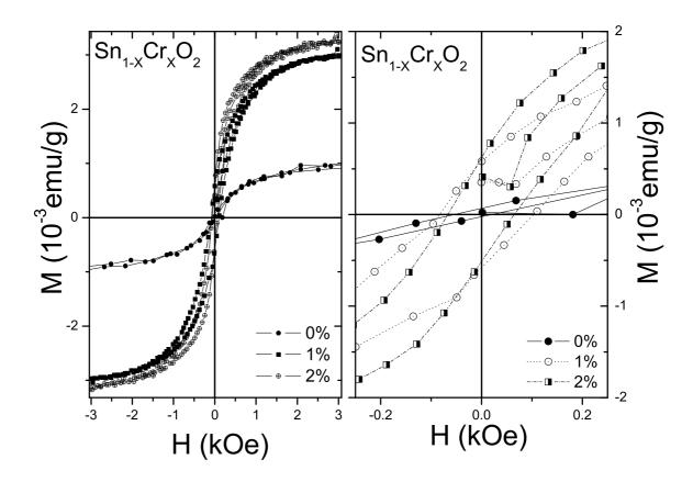
Figura 5.21: Medidas de magnetização em função do campo magnético obtidas a 300K.
