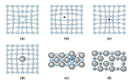
Figura 2.5: Defeitos pontuais: (a)vacância, (b) átomo intersticial, (c) átomo substitucional pequeno, (d) átomo substitucional grande, (e) Defeito Frenkel, (f) Defeito Schottky.
