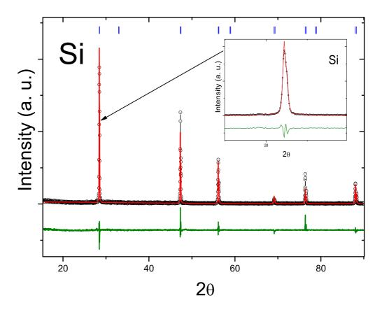
Figura 4.2: Difração de raios X para a amostra de silício utilizada para a calibração do aparelho de raios X. Os pontos são os dados experimentais, a linha continua é o ajuste e a linha inferior é a diferença entre as duas.
