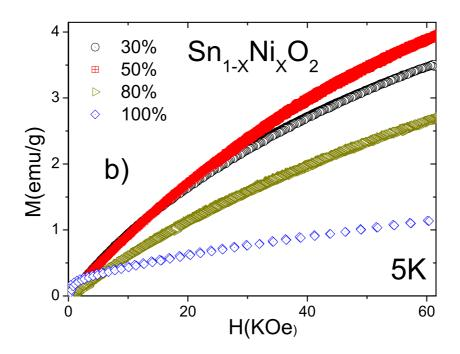
Figura 5.9: Magnetização em função do campo magnético aplicado para a serie de amostras de  $SnO_2$  dopado com níquel a) <10% e b) >10%.
