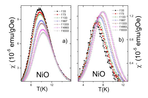
Figura 5.30: Medidas da susceptibilidade AC a)parte real e b) parte imaginária para a amostra de NiO (as frequências são em Hz), campo aplicado de 19 Oe.
