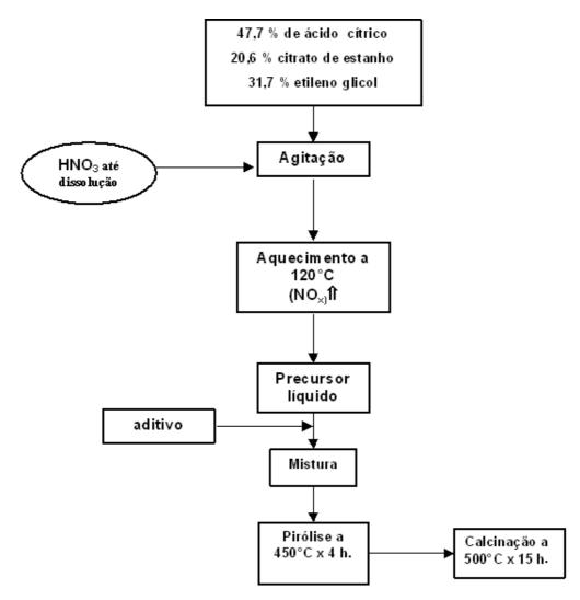
Figura 3.2: Rota de preparação do pó à base de  $SnO_2$
