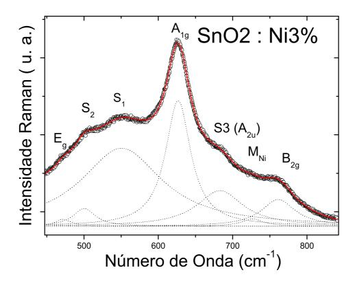
Figura 6.6: Ilustração de um ajuste do espectro Raman, obtido a temperatura ambiente para a amostra de  $SnO_2$  dopado com 3% Ni.
