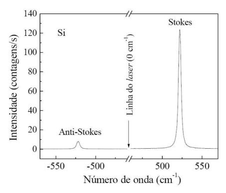
Figura 6.2: Espectro Raman Stokes e anti-Stokes de um monocristal de silício. A intensidade do sinal Stokes é perto de 12 vezes maior que o anti-Stokes.
