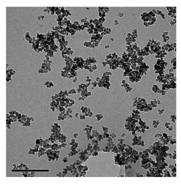
Figura 4.18: Microscopia eletrônica de transmissão para uma amostra de  $SnO_2$  dopado com 5% de Ni
