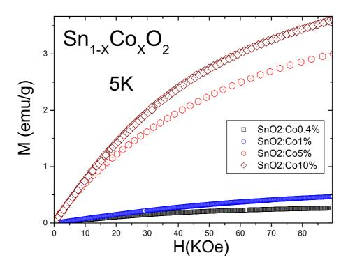
Figura 5.17: Medidas de magnetização a 5K para as amostras de  $SnO_2$  dopadas com cobalto.
