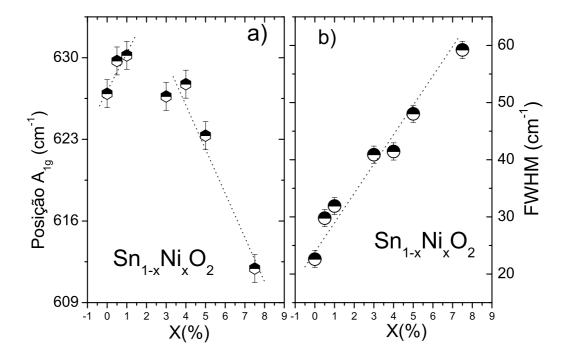
Figura 6.7: Resultados obtidos por espectroscopia Raman: a) variação da posição em função da concentração e b) variação de FWHM em função da concentração, as linhas tracejadas servem apenas de guia.
