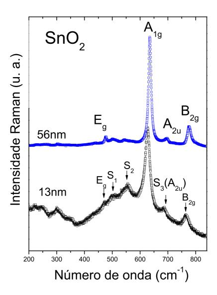
Figura 6.4: Espectro Raman obtidos à temperatura ambiente para nanopartículas de tamanhos médios de 13nm e 56nm  $SnO_2$ .
