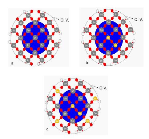
Figura 5.27: Modelo de Core-Shell, a) representação das vacâncias de oxigênio nas nanopartículas de  $SnO_2$ , b) Ingresso majoritário do MT no núcleo (solução sólida), c) acontece a segregação majoritária dos MT na superfície.
