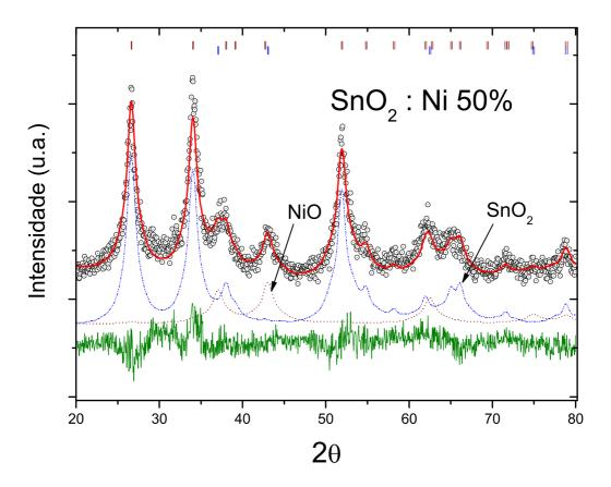
Figura 4.6: Difração de Raios X da amostra de  $SnO_2$  dopado com 50% de Ni, onde pode observar-se a contribuição da fase de  $SnO_2$  e a contribuição da fase de NiO.
