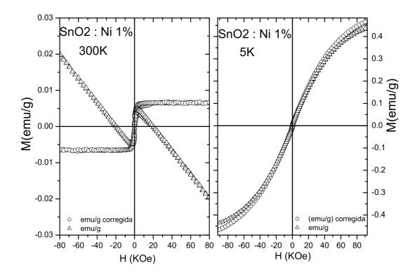
Figura 5.6: Magnetização em função do campo obtidas a 300K e 5K para a amostra de  $SnO_2$  dopado com 1% de níquel. Após a correção devido ao sinal da cápsula se observa que o comportamento da curva corregida à temperatura ambiente é claramente ferromagnética.
