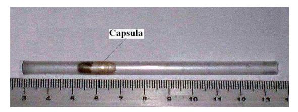
Figura 5.4: Cápsula onde colocou-se a mostra para realizar as medidas.
