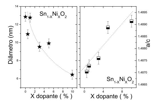
Figura 4.8: Diâmetro médio e a razão a/c em função da concentração para nanopartículas de  $SnO_2$  dopado com níquel (as linhas tracejadas servem apenas de guia).
