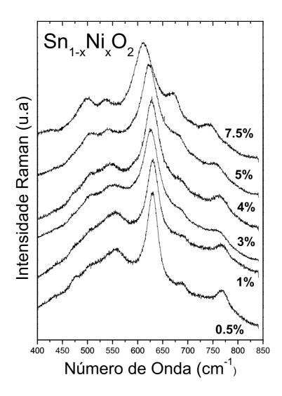
Figura 6.5: Espectro Raman de nanopartículas de  $SnO_2$  dopadas com Ni.
