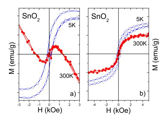
Figura 5.1: Curvas de M vs. H de nanopartículas de  $SnO_2$  a) sem e b) com a correção do sinal diamagnético da cápsula.
