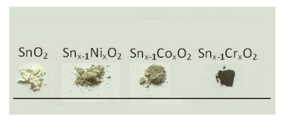
Figura 3.1: Pós de  $SnO_2$  sintetizados pelo método de Pechini
