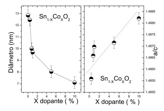
Figura 4.13: Diâmetro médio e a/c em função da concentração para nanopartículas de  $SnO_2$  dopado com cobalto (a linha tracejada serve apenas de guia).
