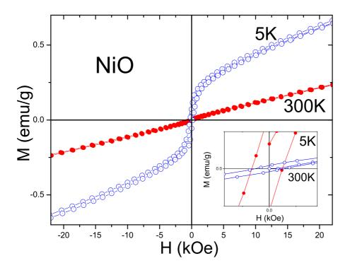
Figura 5.28: Medidas de M vs.H obtidas a 5 e 300K. A Figura inserida mostra uma ampliação do campo coercivo.
