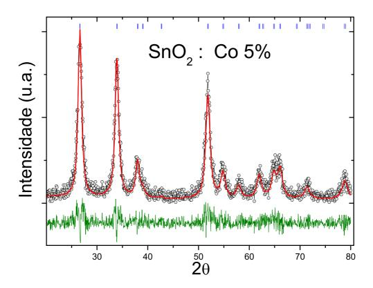
Figura 4.11: Ajuste pelo método de Rietveld com a equação 4.7 para as amostras de 5% de Co.
