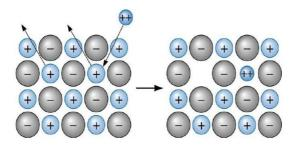
Figura 2.6: Defeito pontual produzido pela substituição de um íon de carga +1 por um de carga +2
