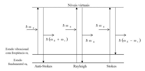
Figura 6.1: Espalhamento de um fóton de energia  $\hbar\omega_E$
