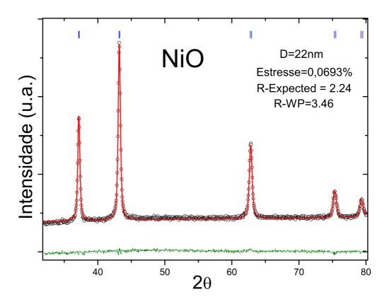
Figura 4.9: Ajuste pelo método de Rietveld para a amostra de NiO.
