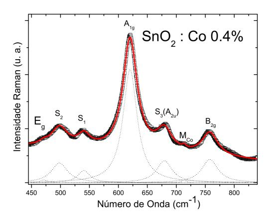
Figura 6.9: Ajuste do espectro Raman, obtido a temperatura ambiente para  $SnO_2$  dopado com 0.4% Co. observa-se os principais picos  $A_{1g}$ ,  $E_g$ ,  $A_{2g}$  e  $B_{2g}$  na faixa de 450 a 850  $cm^{-1}$ . Além disso, as bandas  $S_1$ ,  $S_2$ ,  $S_3$  e o modo de vibração local  $M_{Co}$ .
