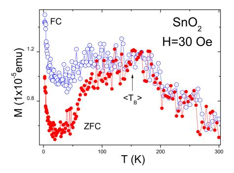
Figura 5.3: Curvas de ZFC e FC obtidas em campo magnético de 30 O<br/>e para as nanopartículas de  $SnO_2$ .
