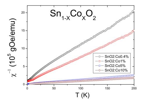
Figura 5.19: Medidas da inversa da susceptibilidade para a serie de  $SnO_2$  dopadas com cobalto
