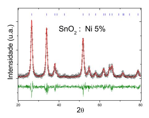
Figura 4.5: Ajuste pelo método de Rietveld com a função 7 para as amostras com 0.5% e 5% de Ni.
