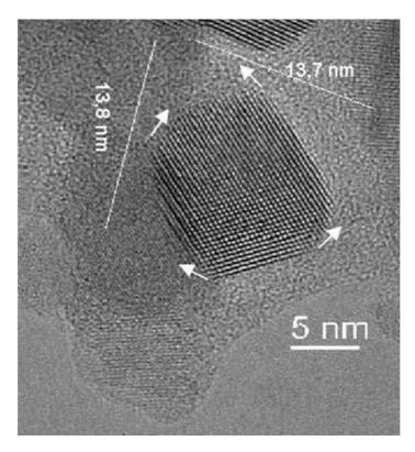
Figura 2.3: Micrografia de uma nanopartícula de  $SnO_2$  sintetizada pelo método de Pechini, micrografia tomada da referência [7].
