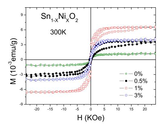
Figura 5.7: Medidas de magnetização em função do campo obtidas em 300K mostram que o ingresso do níquel favorece o ordenamento ferromagnético até 1% de Ni.
