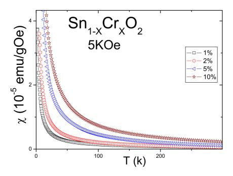
Figura 5.24: Medidas da susceptibilidade em função da temperatura para as amostras de  $SnO_2$  dopadas com cromo.
