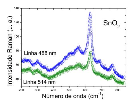
Figura 6.3: Comparação de espectros Raman obtidos com comprimento de onda 488 e 514nm. explorada em um trabalho posterior. A região estudada neste trabalho é entre 400 e  $850cm^{-1}$ .
