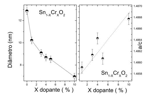
Figura 4.17: Diâmetro médio e a razão a/c em função da concentração para nanopartículas de  $SnO_2$  dopado com Cr (a linha tracejada serve apenas de guia).
