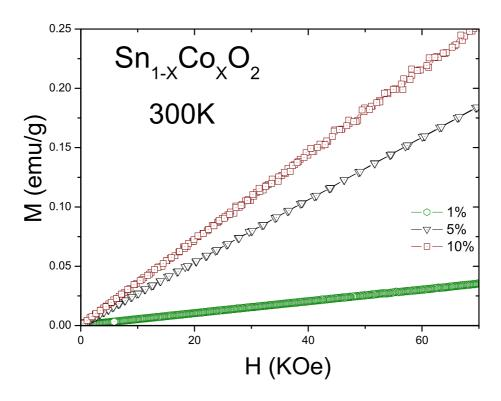
Figura 5.16: Medidas de M vs.H a 300K para amostras de  $SnO_2$  dopadas com cobalto.
