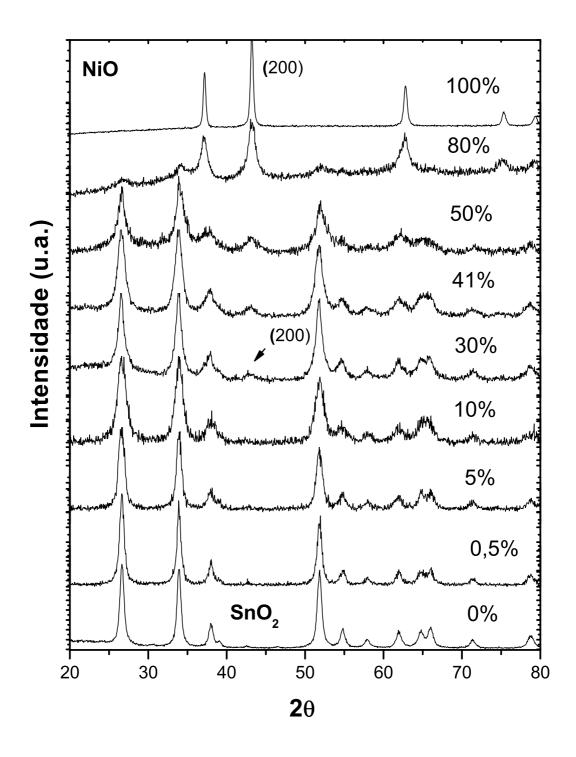
Figura 4.4: Evolução do comportamento de  $SnO_2$  dopado com níquel.
