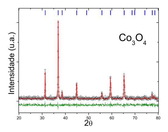
Figura 4.14: Refinamento pelo método de Rietveld para a amostra de  $Co_3O_4$ .
