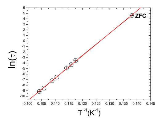
Figura 5.31: Dependência lineal de  $ln(\tau)$  vs  $1/T_B$ , segundo a lei de Néel-Arrhenius.
