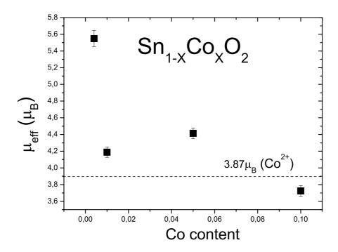
Figura 5.20: Momento magnético efetivo em função da concentração de Co.
