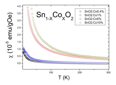
Figura 5.18: Medidas da susceptibilidade em função da temperatura para as amostras de  $SnO_2$  dopadas com cobalto.
