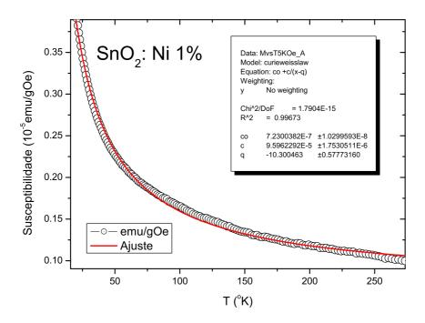
Figura 5.12: Ajuste da susceptibilidade em função da temperatura pela lei de Curie-Weiss para a amostra de  $SnO_2$  dopado com 1% de níquel.
