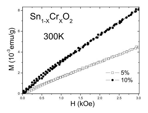
Figura 5.22: Medidas da magnetização em função do campo magnético obtidas a 300K para amostras de  $SnO_2$  dopadas com cromo.
