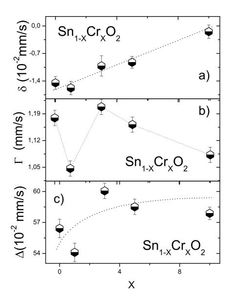
Figura B.2: Parâmetros obtidos dos ajustes dos espectros Mössbauer a temperatura ambiente. Desvio isomerico  $(\delta)$ ,FWHM  $(\Gamma)$  e desdobramento quadrupolar  $(\Delta)$ .
