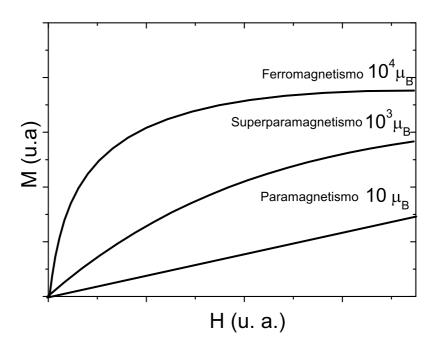
Figura 2.1: Magnetização (M) versus campo magnético aplicado (H) representando o comportamento de substâncias paramagnéticas, superparamagnéticas e ferromagnéticas.
