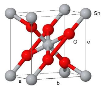
Figura 2.2: Estrutura do  $SnO_2$  com parâmetros de rede  $a=b=4,737\mathring{A}$  e  $c=3,185\mathring{A}$  [6].
