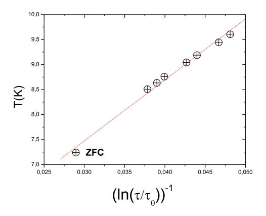
Figura 5.32: Ajuste mediante a lei de Vogel-Fulcher.
