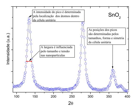
Figura 4.1: Descrição da informação que proporciona a intensidade, a posição e a largura dos picos de um espectro de raios X.
