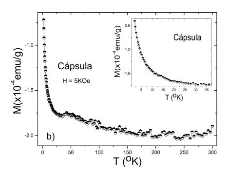
Figura 5.5: Medidas de magnetização (M) em função, a) do campo e b) da temperatura para a cápsula (a Figura inserida é a ampliação da curva Mvs.T em temperaturas  $< 40 \mathrm{K}$ ).
