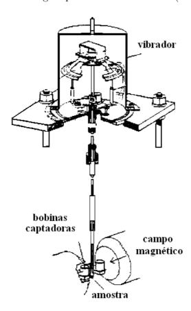
Figura 3.3: Diagrama do magnetômetro de amostra vibrante (VSM).
