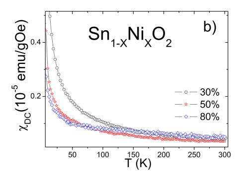
Figura 5.11: Medidas da susceptibilidade em função da temperatura para a serie de  $SnO_2$  dopada com níquel para a) $\leq 10\%$  e b)>10%.
