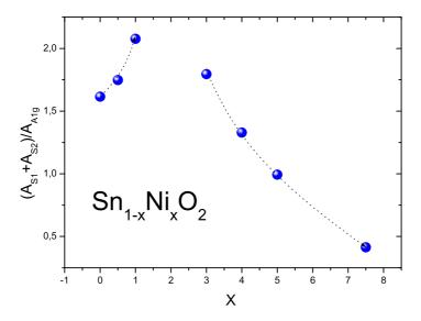
Figura 6.8: Razão entre as áreas das bandas  $S_1$  e  $S_2$  e a área do pico mais intenso  $A_{1g}$ .
