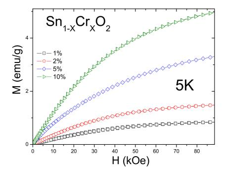
Figura 5.23: Medidas de magnetização a 5K para as amostras de  $SnO_2$  dopadas com cromo.
