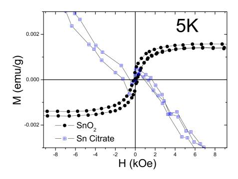
Figura 5.2: Curvas de M vs. H do precursor e das nanopartículas de  $SnO_2$ .
