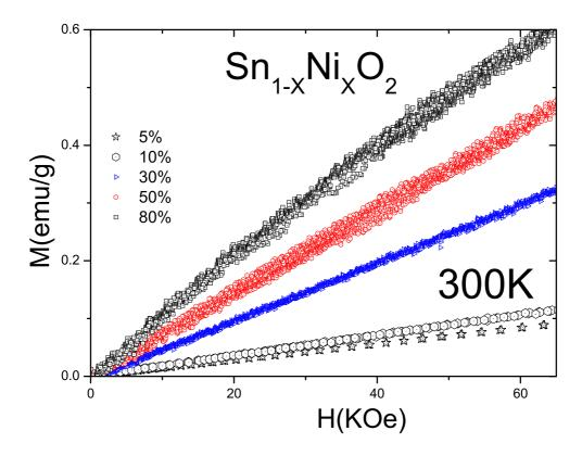
Figura 5.8: Medidas de magnetização em função do campo obtidas em 300K para amostras com concentração de Ni acima de 3%.
