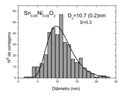
Figura 4.19: Histograma para uma amostra de  $SnO_2$  dopado com 5% de Ni
