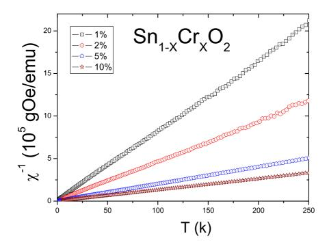
Figura 5.25: Medidas da inversa da susceptibilidade para a serie de  $SnO_2$  dopadas com Cr
