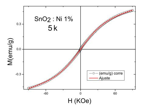
Figura 5.10: Ajuste da curva de magnetização em função do campo usando a função de Brillouin para a amostra de  $SnO_2$  dopado com 1% de níquel.
