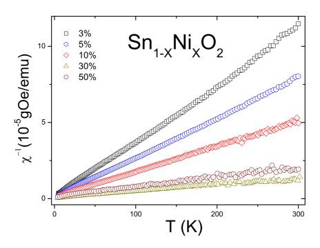
Figura 5.13: Inversa da susceptibilidade v<br/>s. temperatura para a serie de  $SnO_2$  dopados com Ni.
