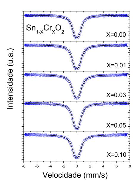
Figura B.1: Espectro Mössbauer obtidos em temperatura ambiente para a serie de  $SnO_2$  dopado com Cr.
