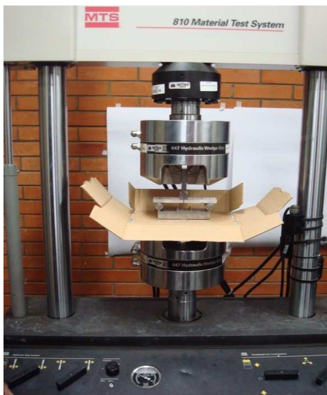
Figura 2.7- Ensaio de flexão de três pontos
