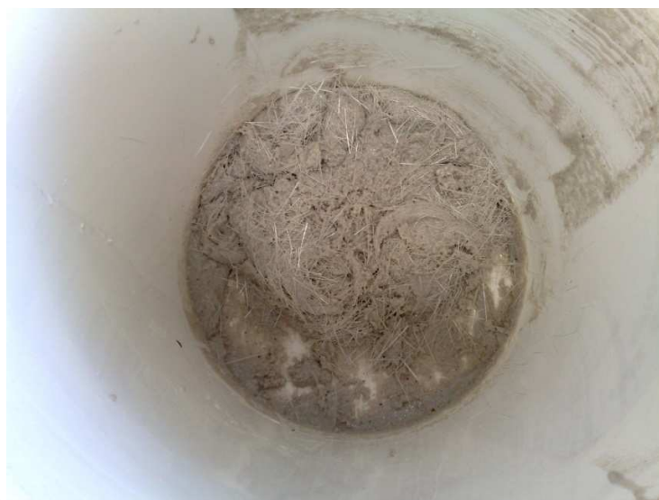
Figura 2.1- Massa de mármore sintético acrescida de fibra de vidro, antes da mistura.
