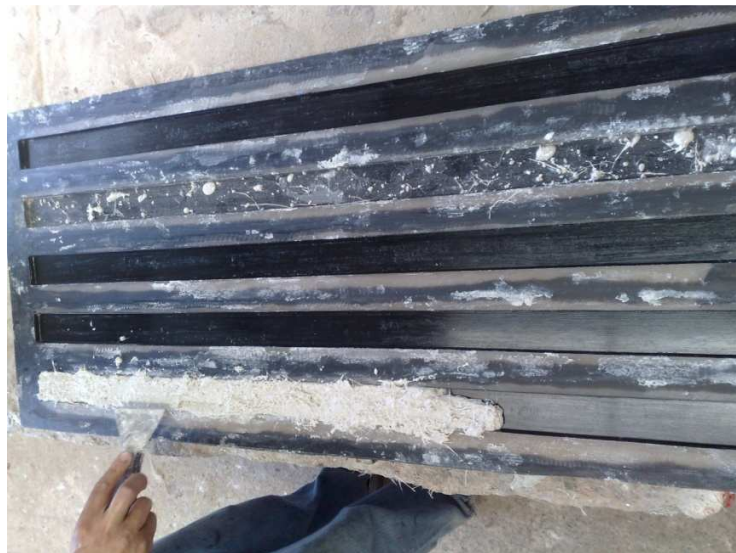
Figura 2.3 - Moldagem da massa de mármore sintético com fibra de vidro
