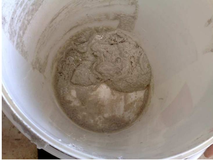
Figura 2.2 Massa de mármore sintético, após mistura com fibra de vidro.
