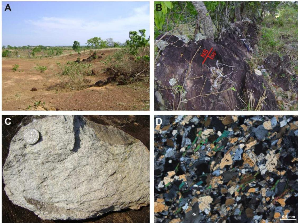
Figura 5.10: Extensas coberturas detrítico-lateríticas (A), Zona de Cisalhamento Fazenda Nova de direção NS (B), amostra macroscópica (C) e microscópica (D) do quartzo muscovita xisto (milonito) da Zona de Cisalhamento Fazenda Nova, onde: QZ (quartzo) e Ms (muscovita).
