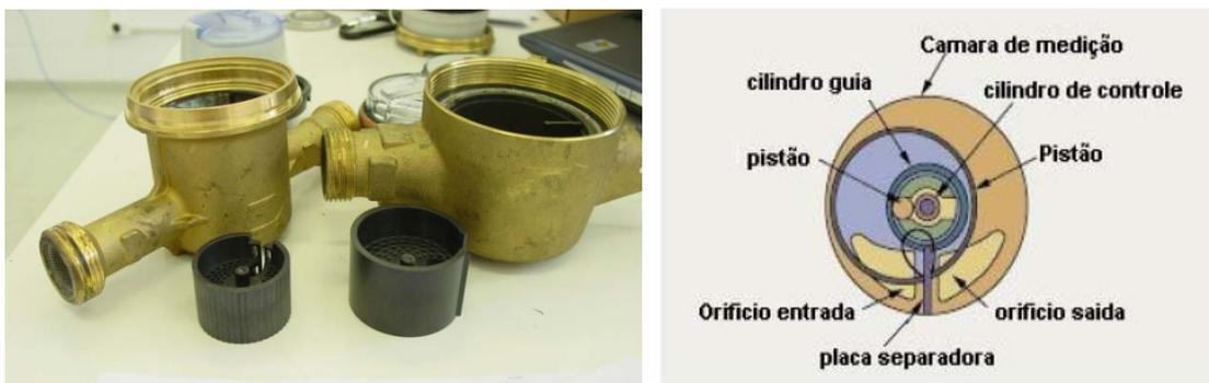
Figura 3.10 – (a) Hidrômetro volumétrico - câmara e pistão oscilante; (b) Características do hidrômetro de pistão oscilante (Frangipani, 2005)
