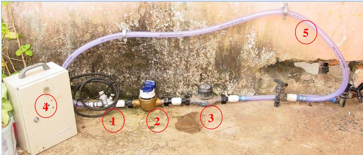
Figura 4.2– Instalação dos equipamentos para registro de vazão e pressão (1 = VRP; 2 = Hidrômetro volumétrico; 3 = Hidrômetro velocimétrico original; 4 = Caixa contendo o data logger de vazão e o de pressão e baterias auxiliares; 5 = mangueira flexível)
