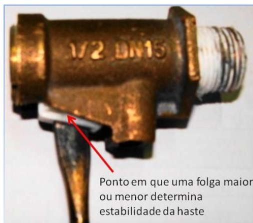
Figura 5.3 – Detalhe da cabeça da bóia 1 – folga no mecanismo de encaixe da haste
