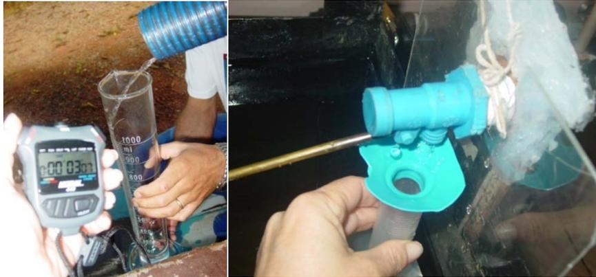
Figura 4.7 – Volumes sendo coletados na saída do vertedor e diretamente na saída da bóia
