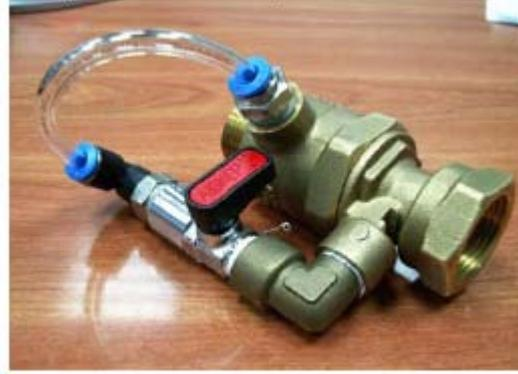
Figura 3.21 – (a) Soluções para substituição de torneiras bóia: (b) Válvula magnética (esquerda) e redutor de vazão não medida por pressão diferencial (Rizzo, 2007)
