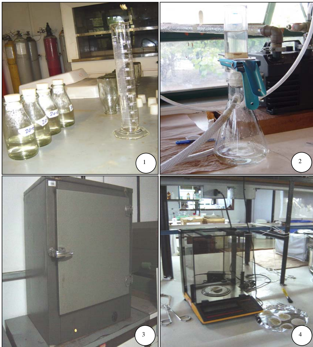
Figura 6.6 – Etapas das análises de amostras em laboratório: 1 – Medição do volumes da amostra a ser filtrada; 2 – filtração da amostra; 3 – secagem dos papéis de filtro em estufa; 4 – pesagem das amostras secas.
