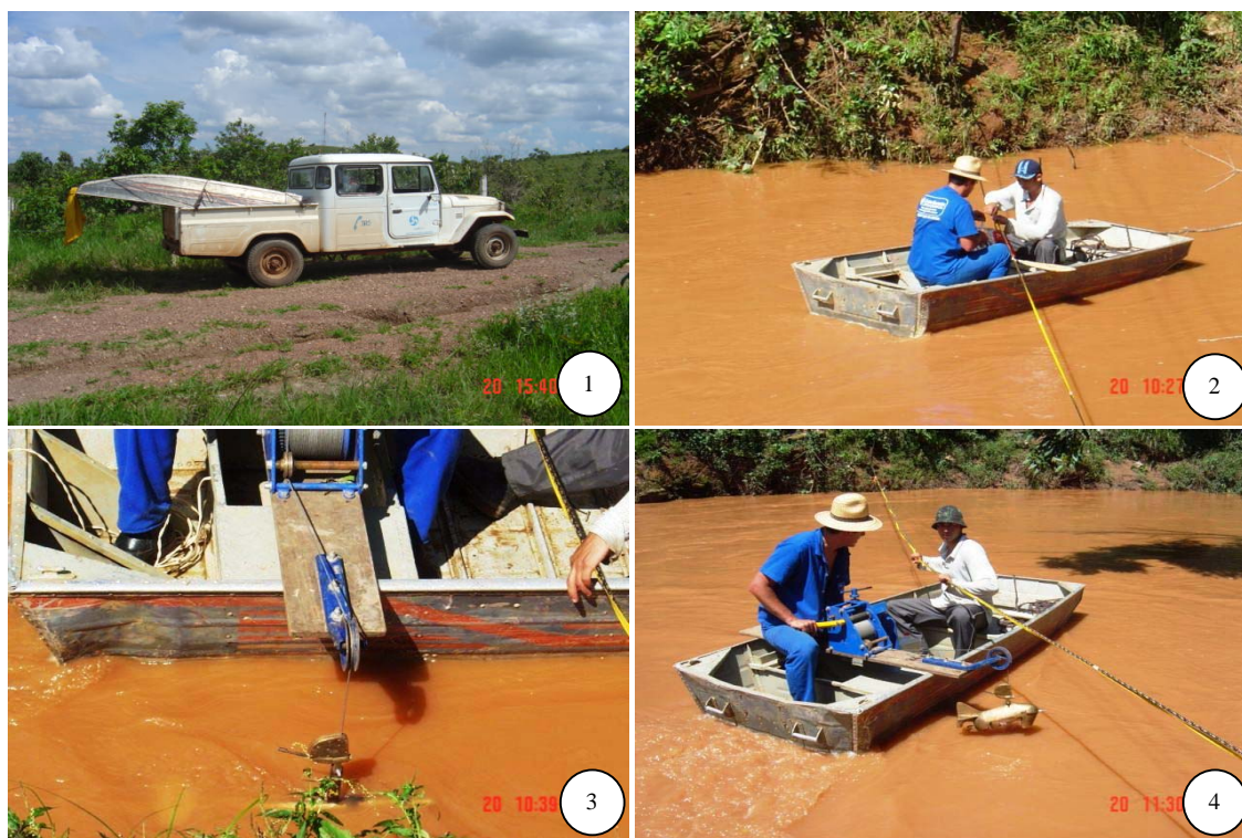
Figura 6.5 – Algumas das etapas de medição de vazão seguida da coleta de amostras de sedimentos em suspensão realizados a barco: 1 – transporte do barco até a estação; 2 – instalação da trena na seção; 3 – medição da velocidade nas verticais; 4 – coleta de amostras de água para análise sedimentológica.
