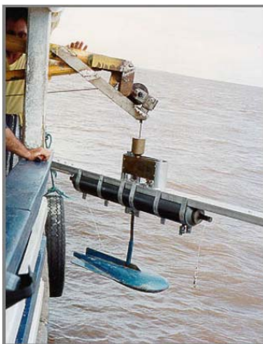
Figura 3.5 – Coletor instantâneo de amostra d'água (Carvalho et al. , 2000a).
