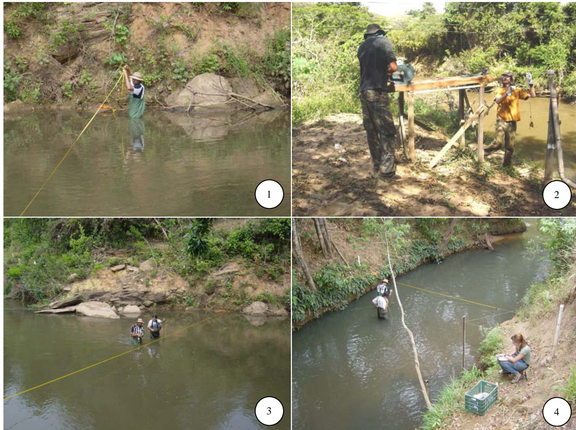
Figura 6.4 – Algumas das etapas da coleta de amostras de sedimentos em suspensão realizados a vau: 1 – Instalação da trena na seção; 2 – instalação do guincho no teleférico; 3 – medição da profundidade nas verticais; 4 – coleta de amostras.
