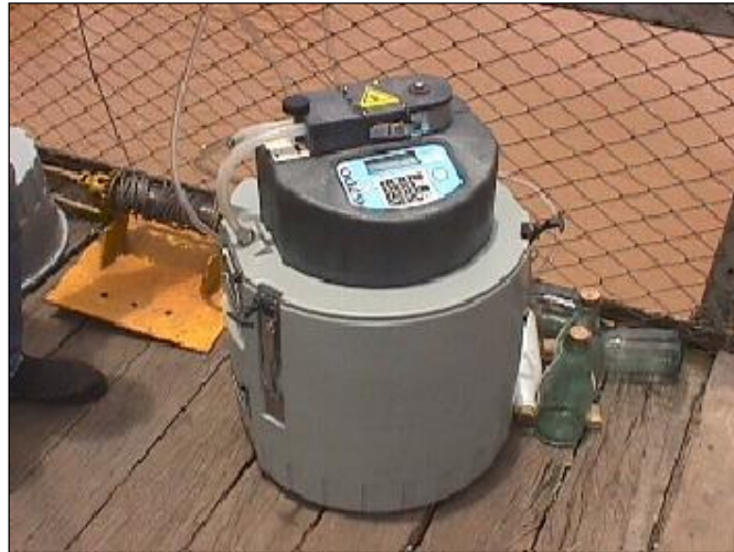
Figura 4.1 – Amostrador programável 6700 FR - ISCO (Coiado, 2001a).
