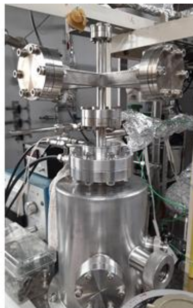
Fig. 4.3. Diagrama esquemático adaptado de Sumino et al. (2001) e fotografia mostrando o porta amostras e o forno de tântalo (Ta) que são utilizados nas análises por fusão. Os porta amostras têm 2 “braços” e cada um deles acomoda até 5 amostras de ~0,5 g. A amostra a ser analisada é movida com o auxílio de ímãs, que são utilizados para mover o porta amostras até a cavidade que dá acesso ao cadinho de molibdênio (Mo). Como as amostras são “lançadas” no cadinho, as análises devem ser realizadas de forma sequencial, partindo da primeira localizada mais próxima à cavidade até a última mais distante da mesma.
