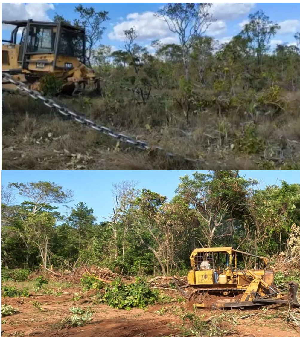
Figura 10: Uso de correntão para remoção da vegetação nativa em áreas de Cerrado.
