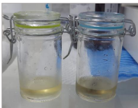
Fig. 14 – Potes de vidro hermeticamente fechados contendo mistura de ferridrita sintética com HEPES e sulfato amônico de ferro (II).
