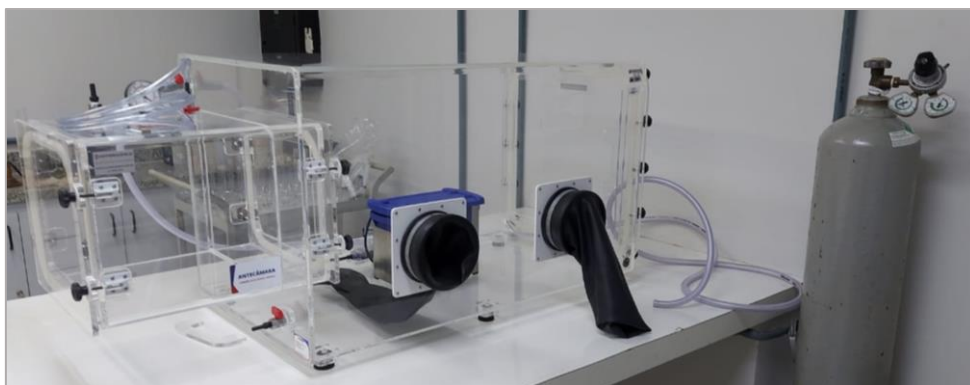
Fig. 13 – Gloove box utilizada para realização do experimento, com controle de atmosfera (cilindro de N 2 ), nas dependências do LAGEQ/UnB.
