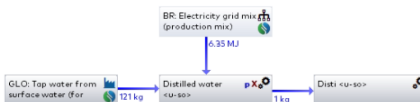
Figura 7 – Diagrama resumido da produção de água destilada modelado no software LCA for Experts.
