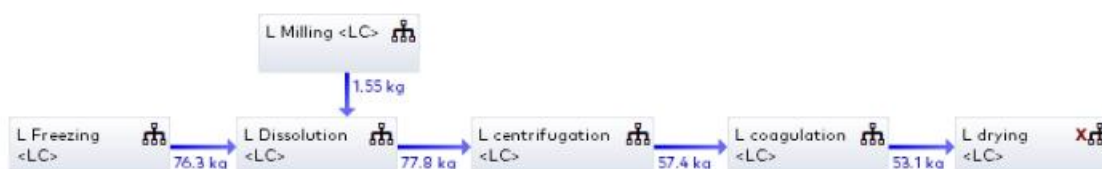
Figura 17 – Diagrama resumido da produção do RCF – AgNPs pelo cenário 1 modelado no software LCA for Experts.
