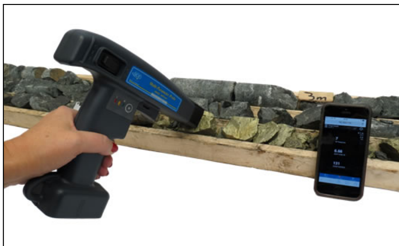
Figura 4.4: Fotografia de aquisição de dados do equipamento MPP-EM2S+ da GDD Instrumentation . Fonte: https://www.gddinstrumentation.com/mpp-probe .
