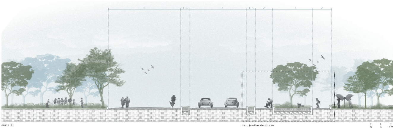
Figura 17: Corte urbano longitudinal: perfil viário, passeios e zoneamento de infraestrutura verde.
