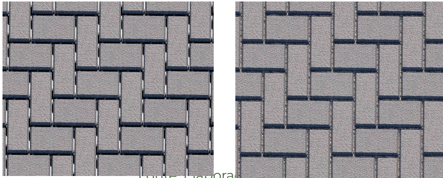
Figura 12, 13 - Piso intertravado com raio para percolação e inserção de areia como rejunte.
