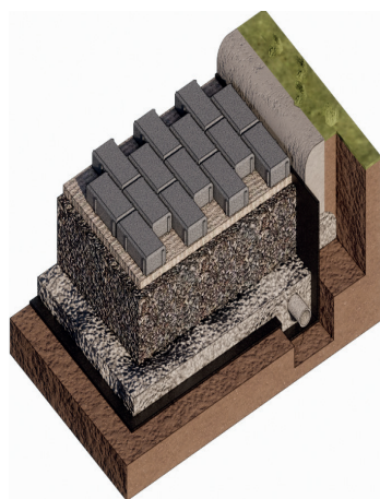
Figura 10 - Sub-base; dreno e meio-fio.
