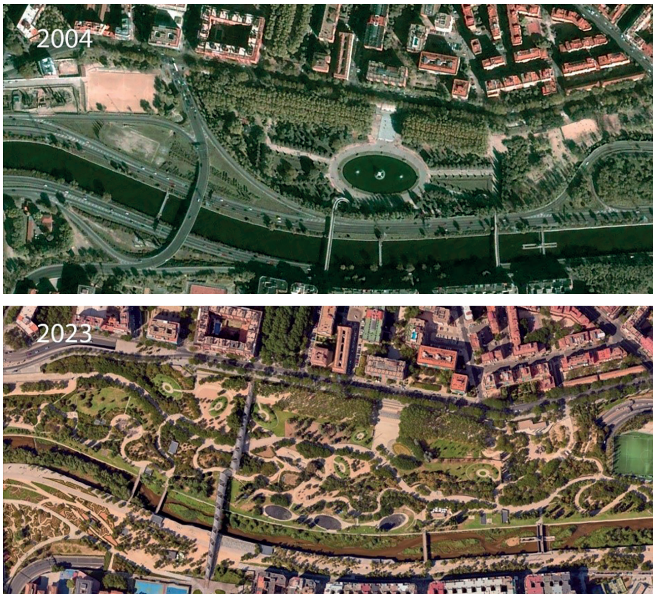
Figura 8: Trecho da via M-30 antes e após sua demolição e realização do projeto Madrid Río.
