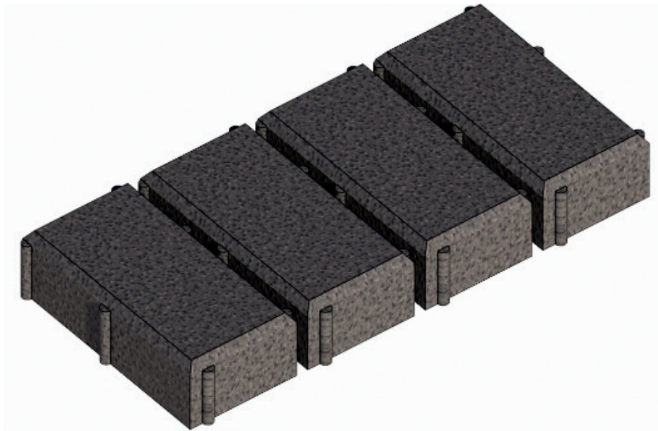
Figura 1 - Pavimento bloco intertravado de concreto maciço com juntas alargadas.
