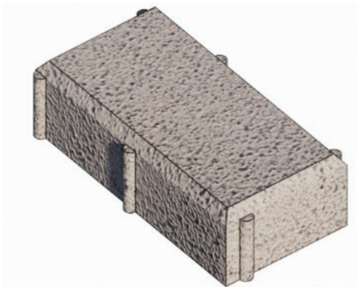
Figura 2 - Pavimento bloco intertravado de concreto permeável.
