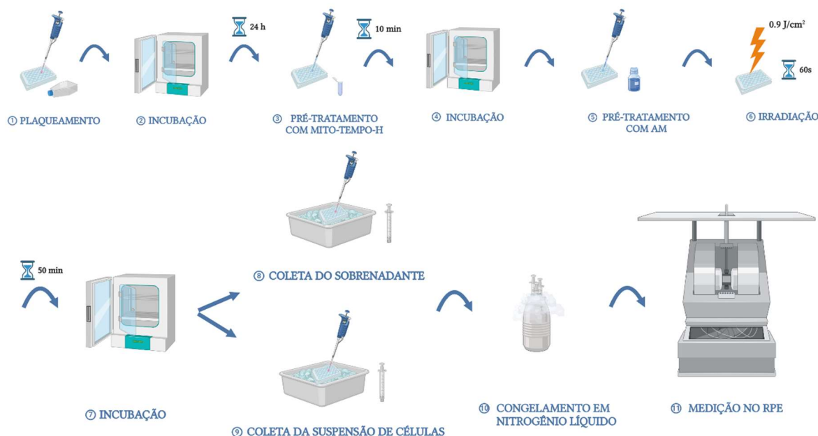
Figura 11 – Esquema metodológico para avaliação da produção de superóxido mitocondrial. Fonte: Autoria própria.
