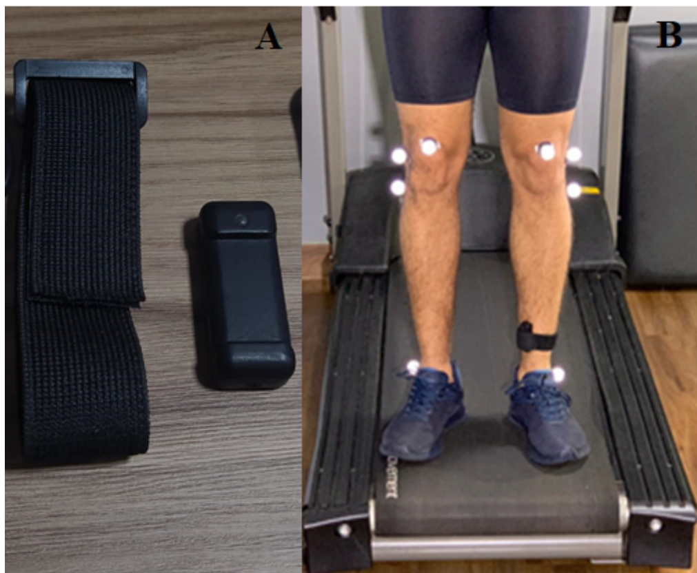
Figura 5. Instrumento utilizado para avaliação da aceleração vertical da tíbia e cadência. (A) Acelerômetro Tgforce e velcro utilizado para posicionar o dispositivo na tíbia. (B) Acelerômetro Tgforce posicionado no aspecto anteromedial da tíbia (B).
