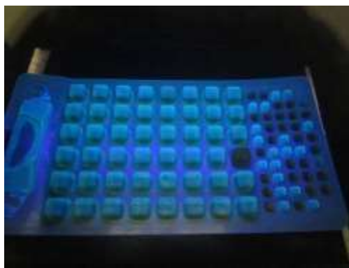
Figura 8 – Etapa de análise laboratorial da qualidade da água para verificação bacteriológica. Fonte: Própria, 2023.
