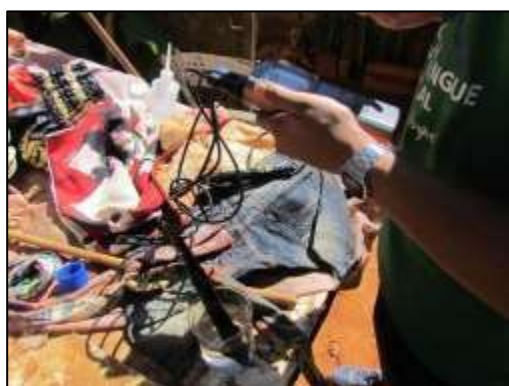
Figura 5 – Aferição da qualidade da água pela sonda multiparâmetro. Fonte: Própria, 2023.
