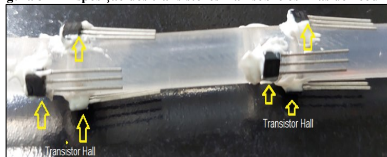
Figura 34 - Disposição dos transistores Hall sobre os ímãs de neodímio
