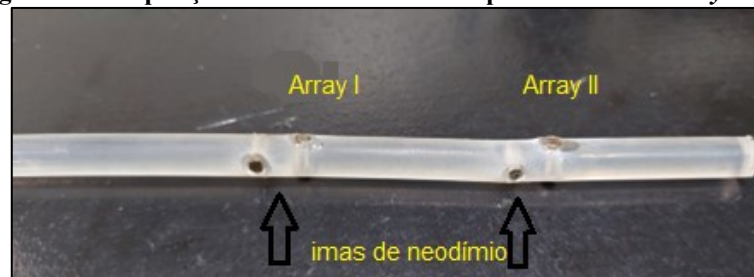
Figura 33 - Disposição dos ímãs de neodímio para formar os array sensor
