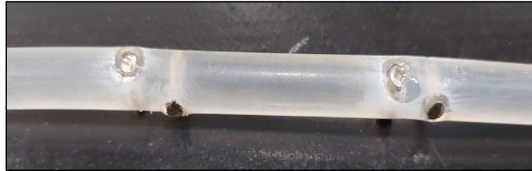
Figura 32 - Fixação do ímã de neodímio no bastonete de silicone
