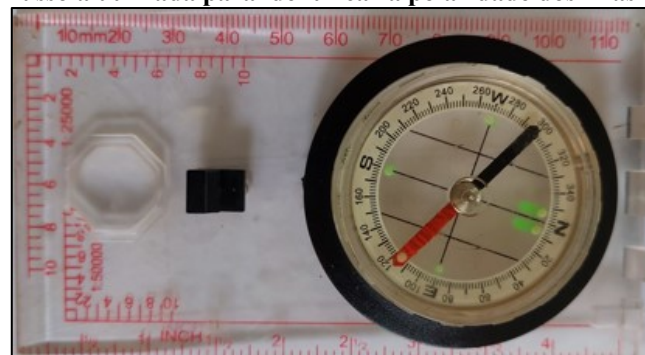
Figura 3 - Bússola utilizada para identificar a polaridade dos ímãs de neodímio
