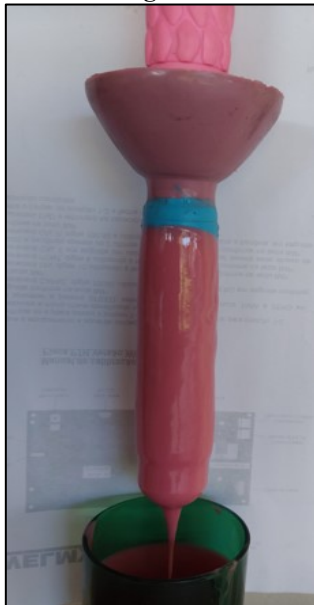
Figura 44 - Sonda sendo mergulhada na borracha de silicone
