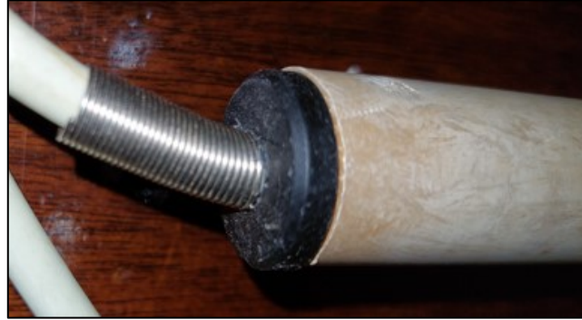
Figura 5 - Mola inserida para melhorar a flexibilidade do cabo
