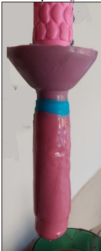
Figura 45 - Sonda finalizada após secagem da borracha de silicone
