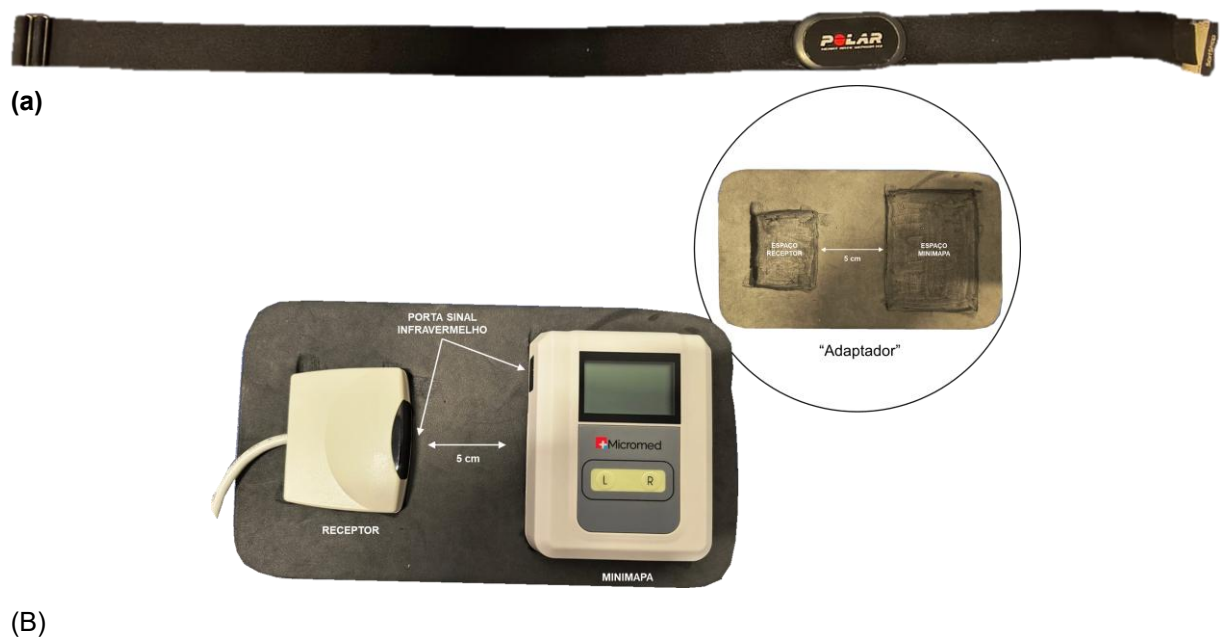
Figura 06 – (a) Cinta elástica com cardiofrequencímetro WindLink e (b) MINIMAPA com “adaptador”.
