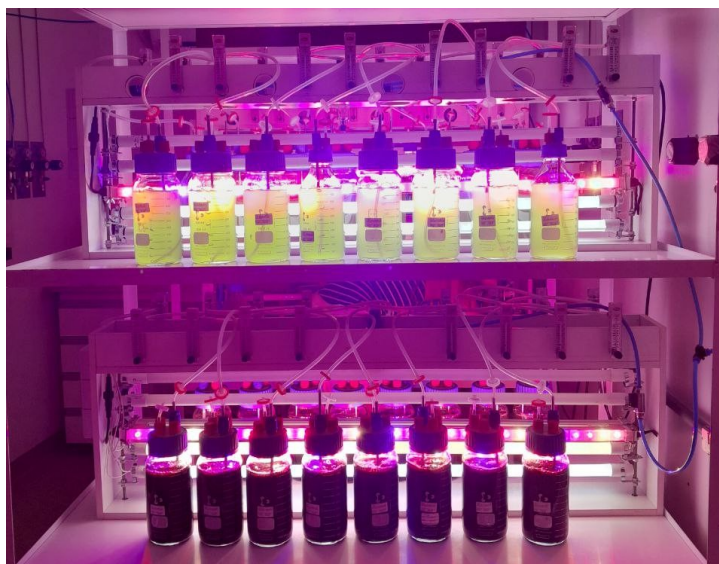
Figura 7. Modelo de cultivo utilizado para o crescimento comparativo realizado em 1L de meio. Foi feita quadruplicatas de cada condição para cada cepa analisada.
