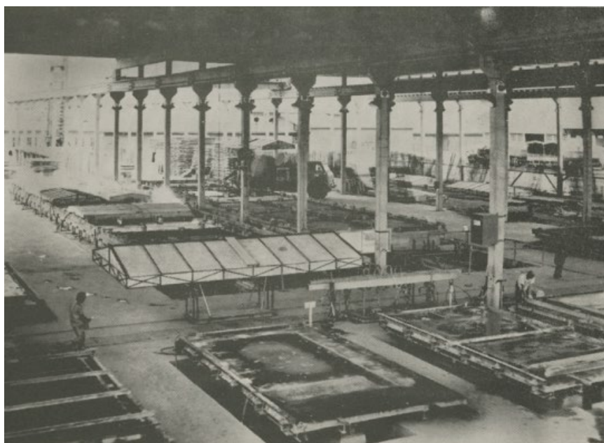
Figura 4. Linha de fabricação de pré-moldados da Rabello. Catálogo da Construtora Rabello S.A.
