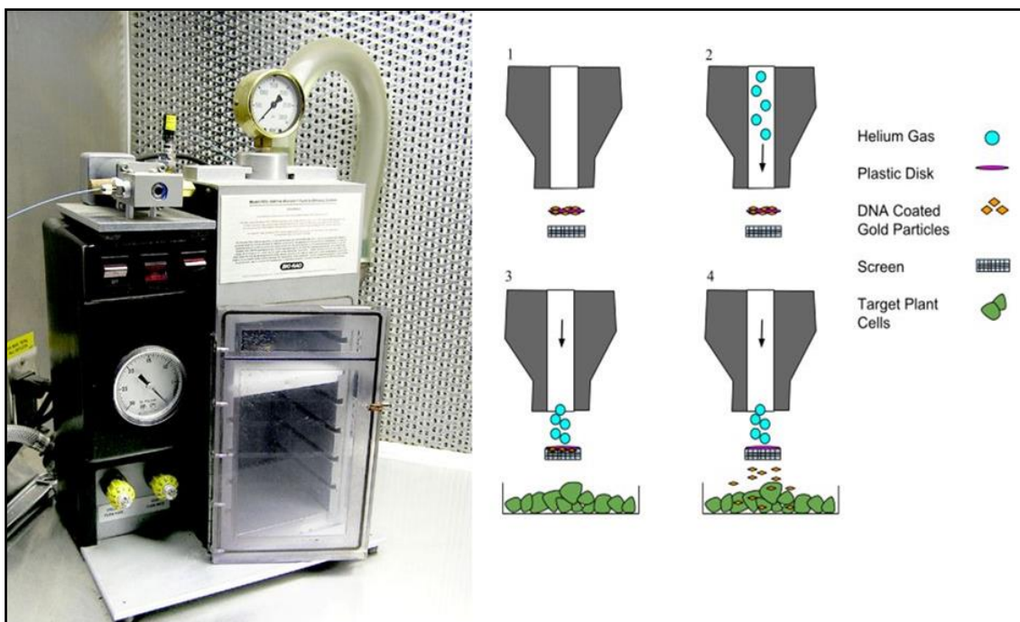
Figura 1. Bombardeador ou acelerador de partículas. Esquema representando a biobalística, método de transferência direta de genes mais usado para transformar células vegetais. Fonte: google imagens (2017).
