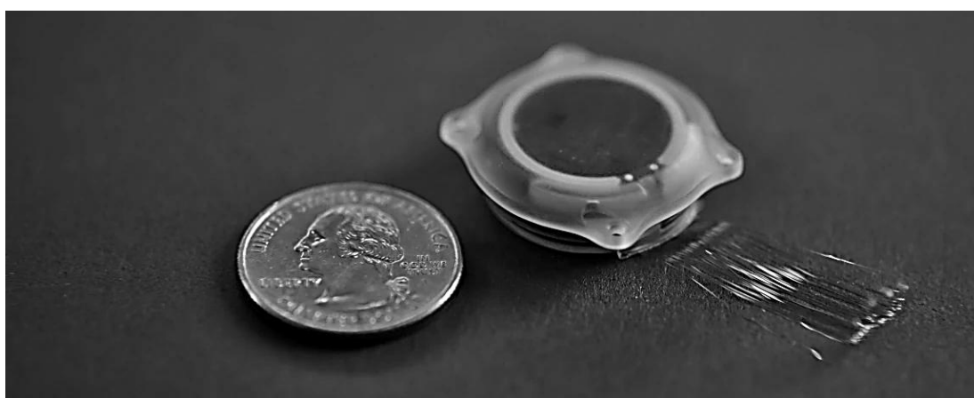
Imagem 12 - Implante Neuralink N1 (“The Link”) desenvolvido pela Neuralink ao lado de uma moeda. Fonte: Neuralink (2024).
