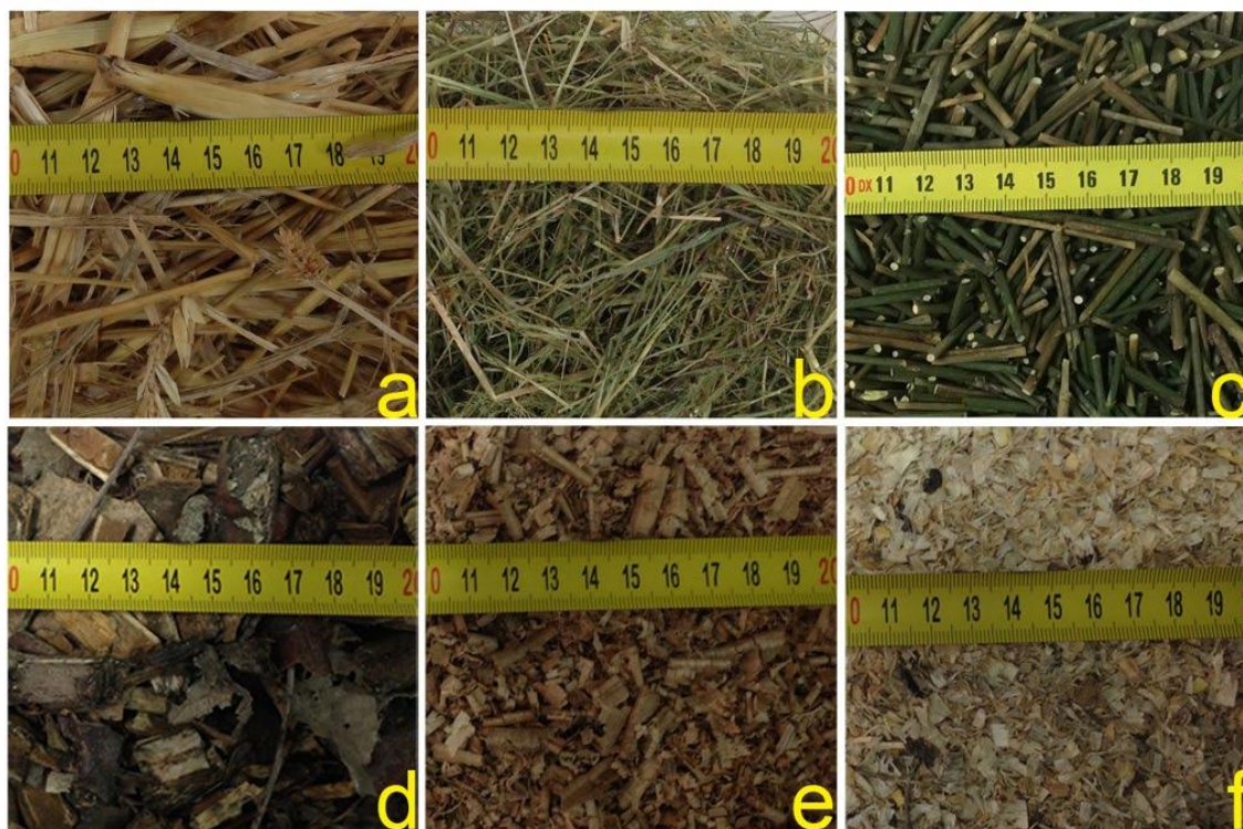
Figura 5: Materiais testados: (a) palha, (b) feno, (c) broom (d) plant litter, (e) aparas de madeira de castanheiro de grão grosso e (f) aparas de madeira de choupinho de grão fino. Fonte: Iannace (2017)
