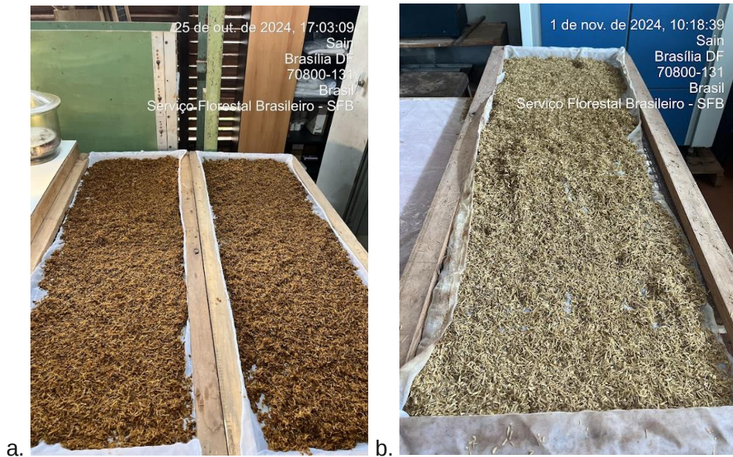
Figura 57: Processo de secagem das partículas granulometria G1. (a) Imediatamente após a lavagem. (b) Sexto dia de secagem. Fonte: Elaboração própria
