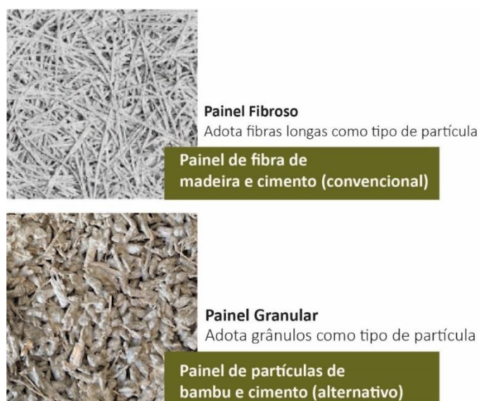
Figura 86: Infográfico de apresentação do painel convencional de fibra de madeira e cimento e o painel convencional estudado de grânulos de bambu e cimento
