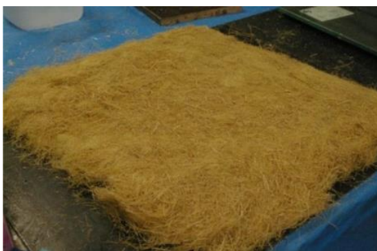
Figura 42: Fibras de bambu tratadas em solução de NaOH e orientadas de forma randômica.
