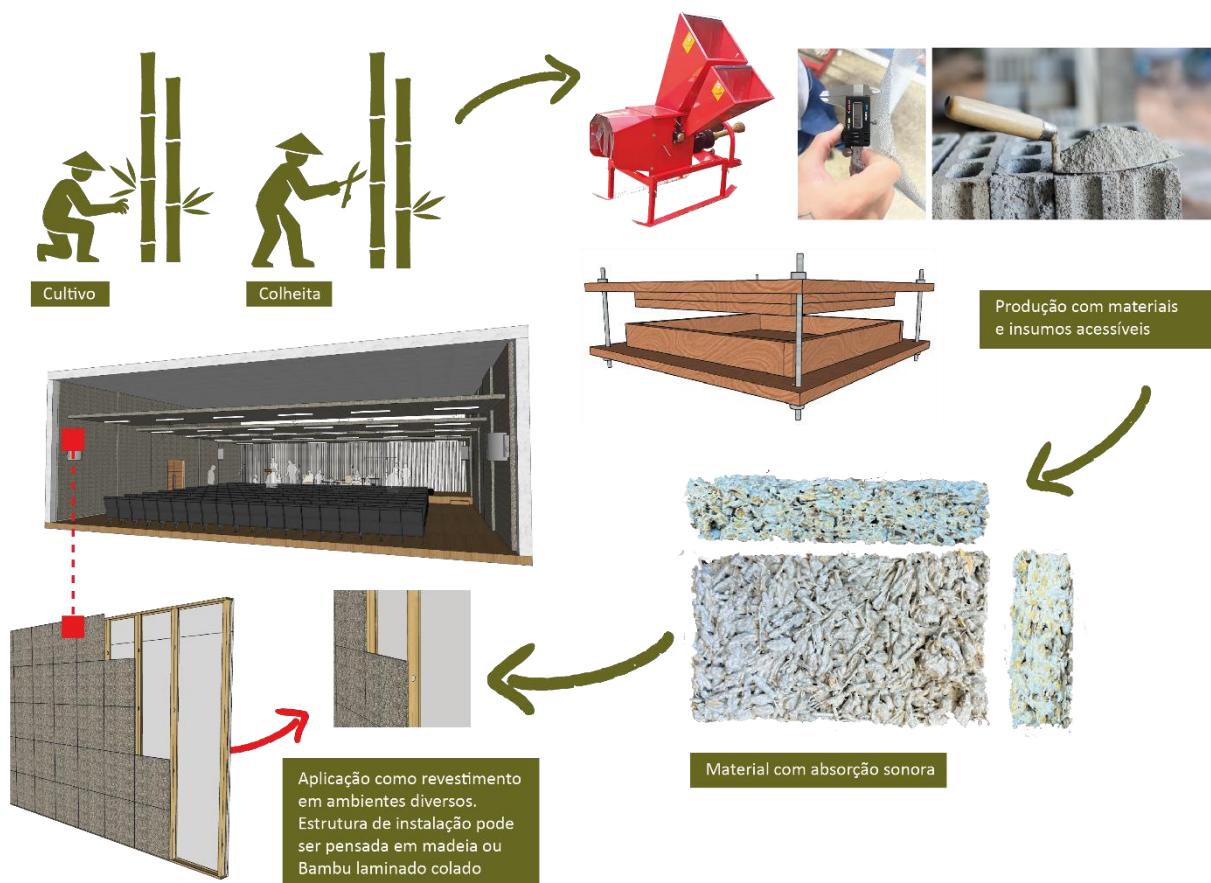
Figura 99: Diagrama de etapas de produção do painel de bambu e cimento Fonte: Elaboração própria
