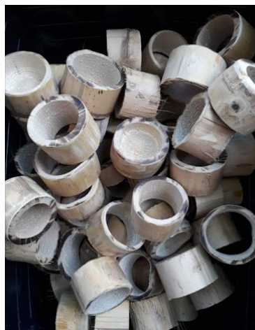
Figura 51: Colmos de bambu seccionados em peças de comprimento de 5cm Fonte: Elaboração própria
