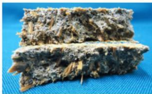
Figura 32: Uma amostra do bioconcreto de bambu Fonte: Caldas et al. ; (2019)
