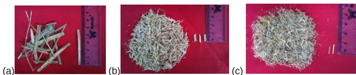
Figura 46: Granulometria das partículas a: Lã, b: média, c: fina.
