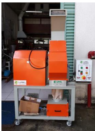
Figura 52: Moinho de martelo Fonte: Elaboração própria
