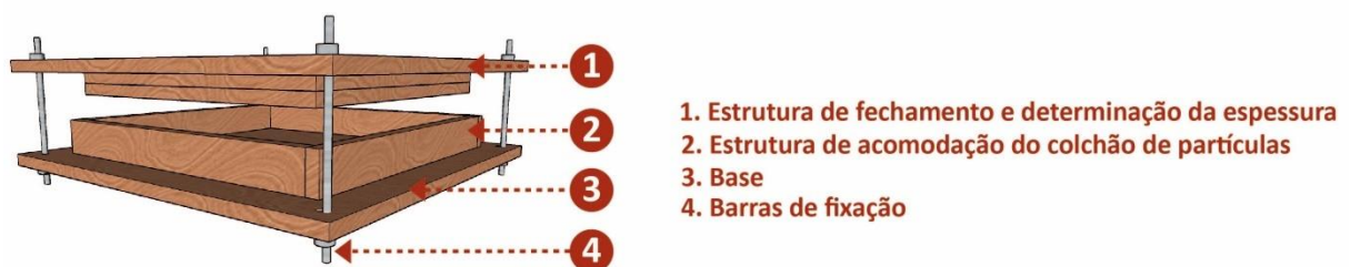
Figura 59: Esquema das prensas manuais para painéis Fonte: Elaboração própria
