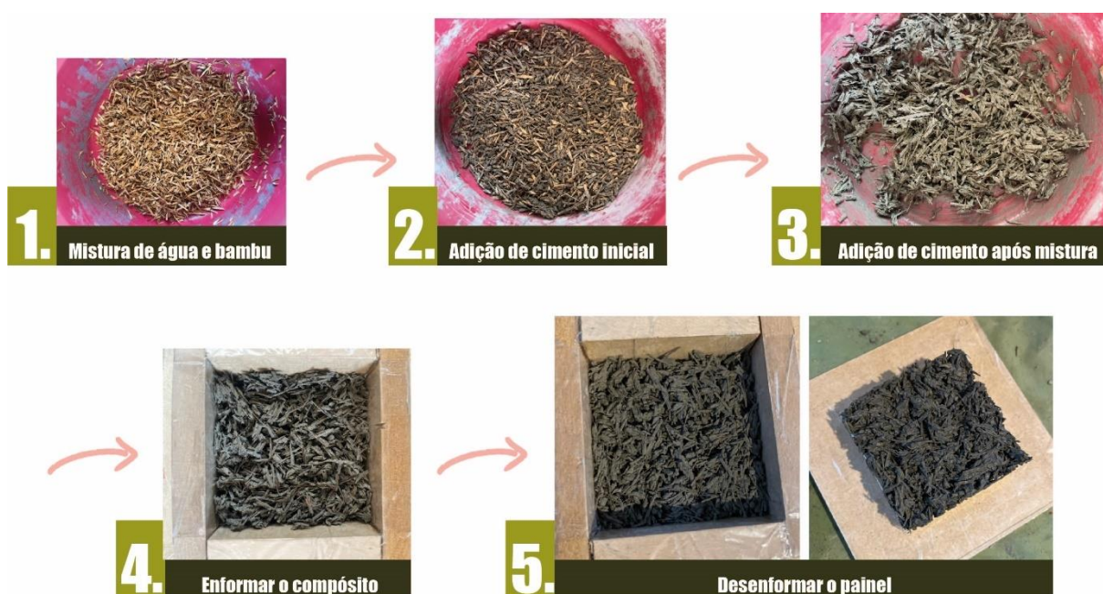
Figura 62: Fluxo de produção dos painéis
