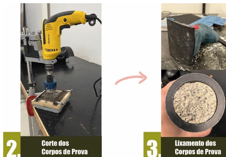
Figura 63: Ilustração dos procedimentos de beneficiamento dos corpos de prova Fonte: Elaboração própria
