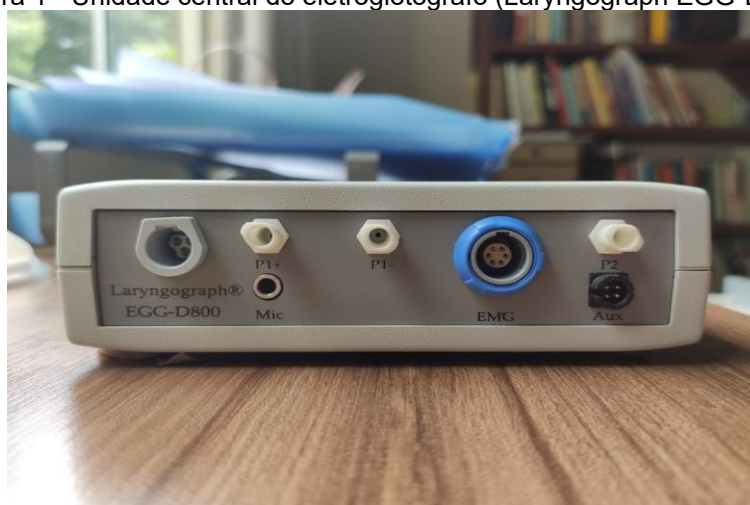
Figura 1 - Unidade central do eletroglotógrafo (Laryngograph EGG-D800)
