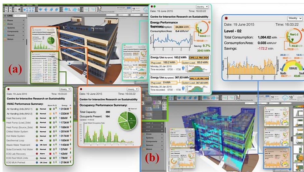
Figura 8 - Sistema proposto por Jaffary (2016) para gestão do edifício demonstrando análises para o edifício completo (a) e para pavimentos selecionados (b).
