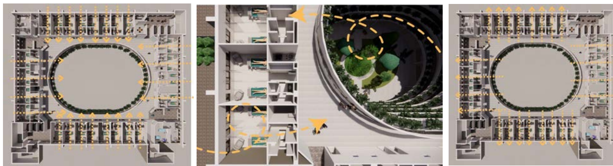
Figura 6 - Planta baixa mostrando o fluxo da ventilação
