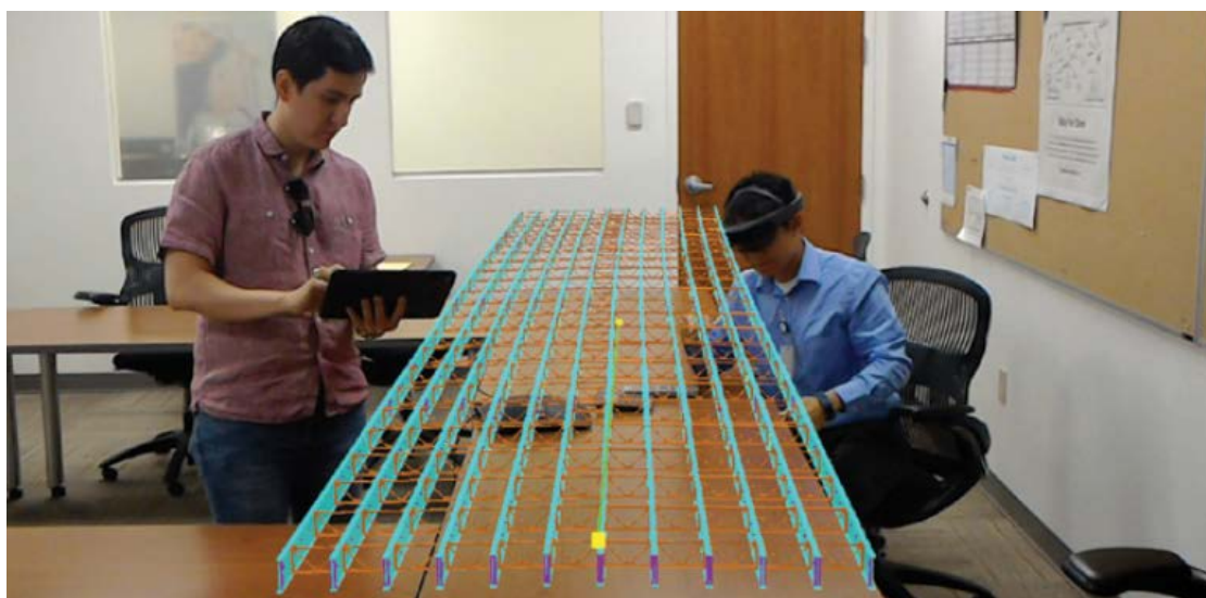
Figura 2 – Montagem de demonstração da visualização de elemento estrutural tridimensional pela realidade aumentada.
