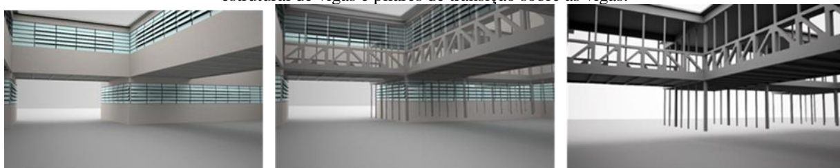
Figura 9 – Acesso principal e estrutura. Notar a ausência de pilares de sustentação do pavimento superior e o jogo estrutural de vigas e pilares de transição sobre as vigas.
