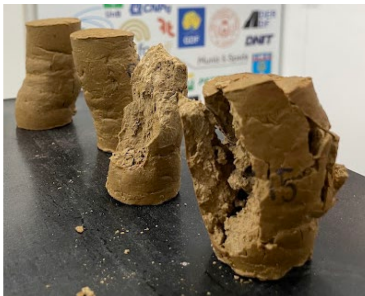
Figura 5.6. Corpos de prova B50 após ruptura. A partir do primeiro plano: 45, 30, 15 e 7 dias, respectivamente.
