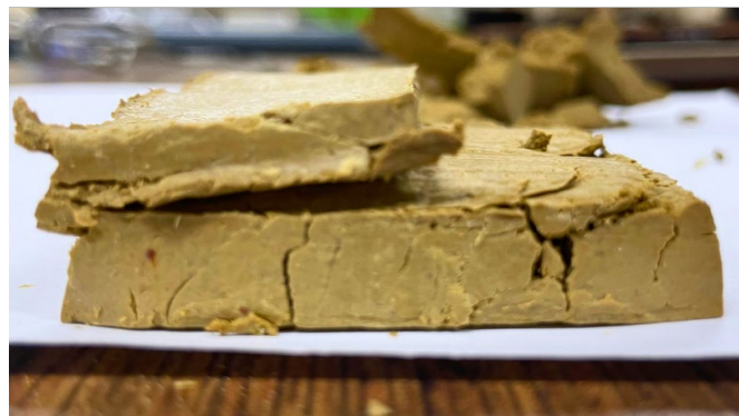
Figura 5.13. Corpo de prova B25 com 15 dias de cura após a ruptura
