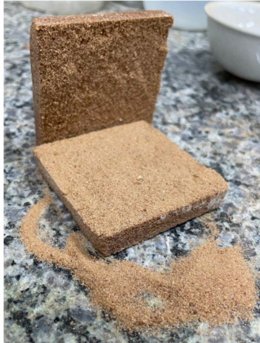
Figura 4.11. SP25 7 dias de dia, após ruptura.
