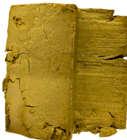
Figura 5.12. Corpos de prova com 4 dias de cura, após a ruptura. (a) Imagem lateral do CP após ruptura. (b) Imagem superior do CP após ruptura.
