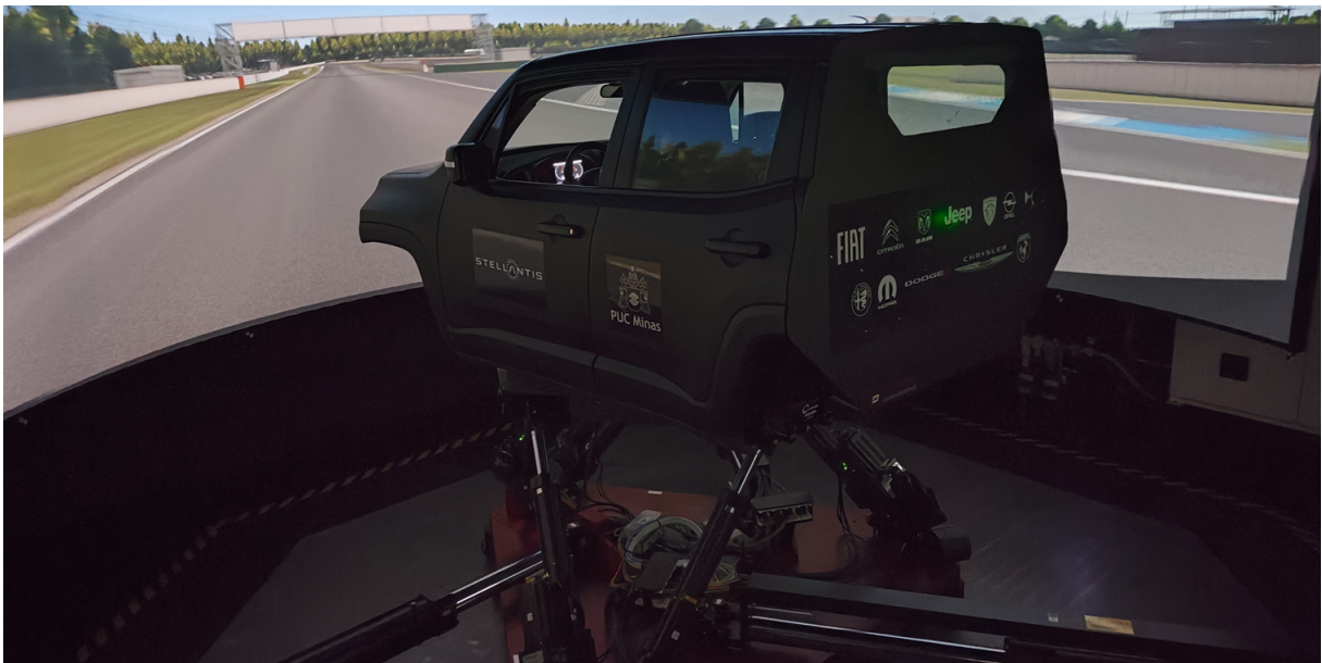
Figura 34 – Simulador dinâmico veicular DIM 150 utilizado nos testes de ESC virtual com pilotos.
