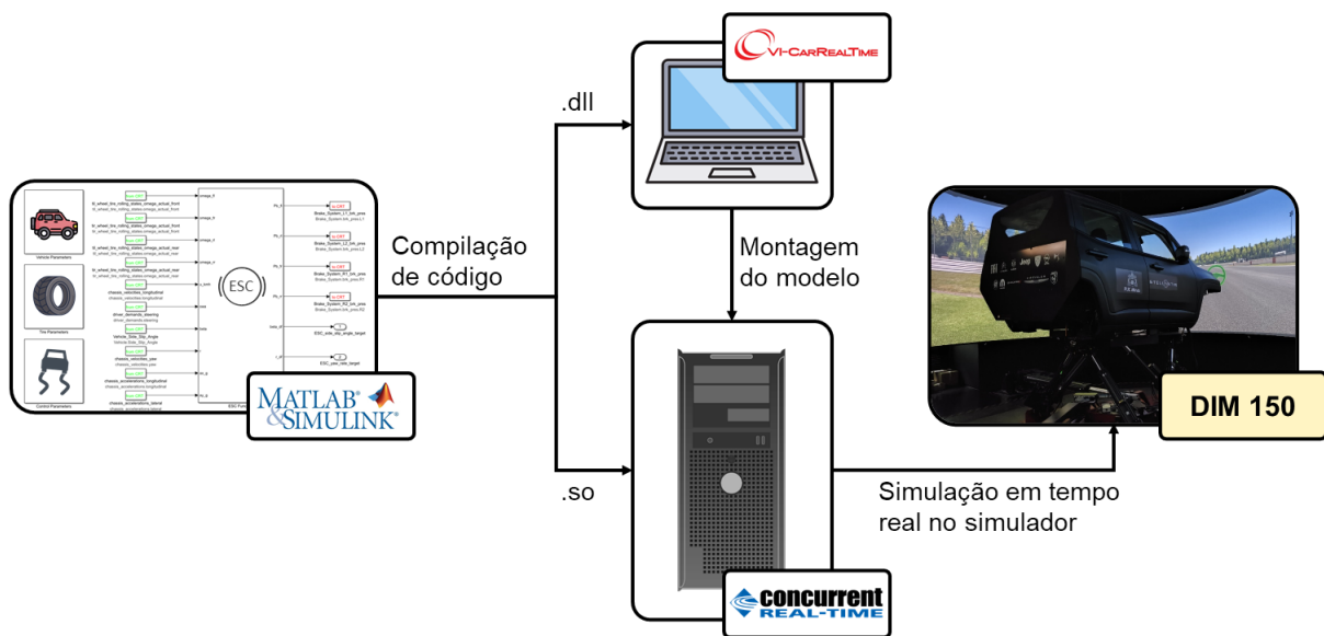
Figura 35 – Diagrama do processo de compilação do modelo Simulink do controlador para as máquinas de simulação.
