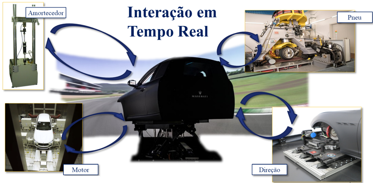
Figura 3 – Conceção integrada HIL e DIL no desenvolvimento da dinâmica veicular (Adaptado de Boreanaz (2021)).
