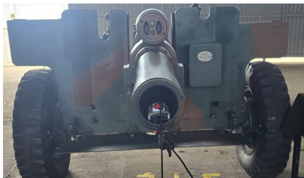
Figura 5.15: Fixação do sensor ao obuseiro.
