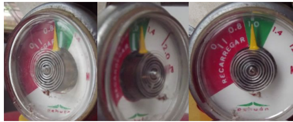
Figura 2.6: O erro de paralaxe ilude o observador, informando necessidade de recarga (Fonte: Elaborado pelo autor).
