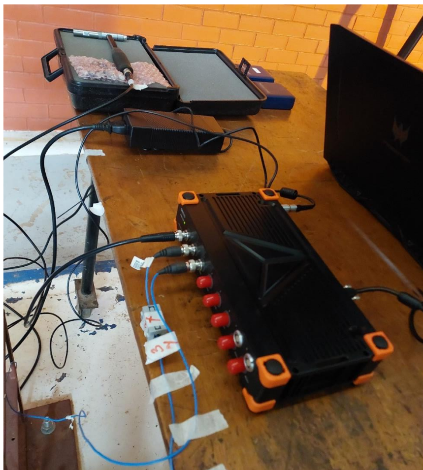
Figura 4.7 – Identificação das entradas utilizadas no sistema modular de aquisição.
