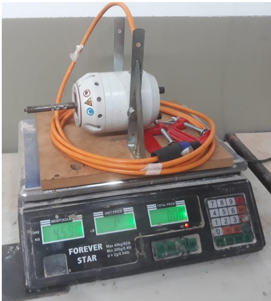
Figura E.12 – Massa do shaker e dos sargentos utilizados (4,598 kg).
