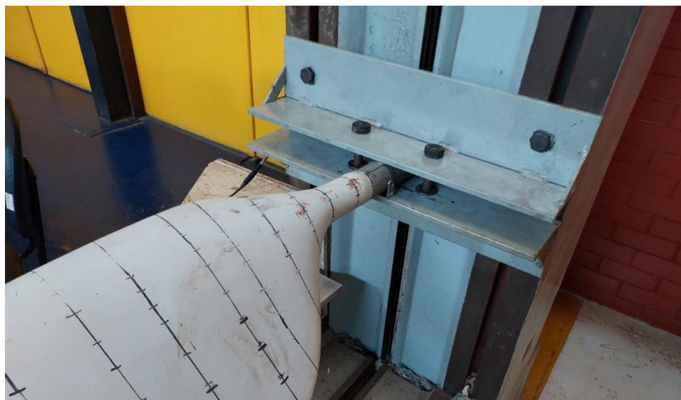
Figura 4.37 – Detalhe de fixação e cunhamento da pá eólica.
