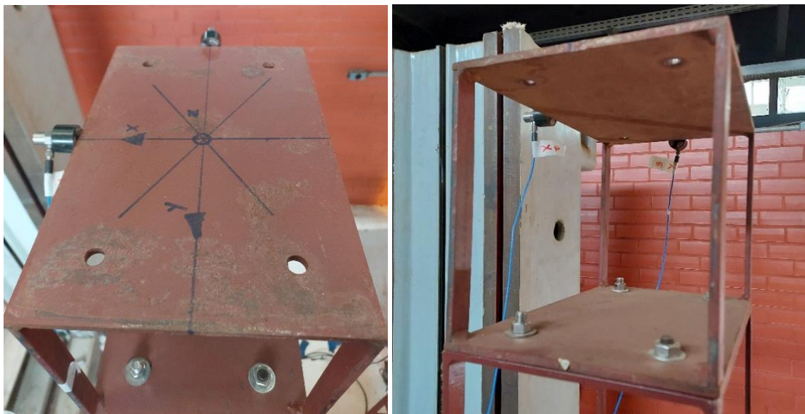
Figura 4.6 – Locação dos acelerômetros na fase 1.
