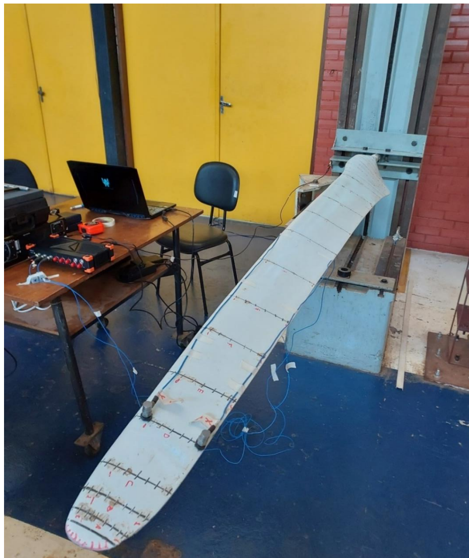
Figura 4.36 – Vista frontal da pá eólica engastada ao suporte inercial GDS.
