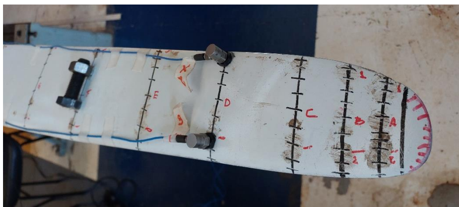
Figura 4.41 – Massa de 130g adicionada no ponto F.
