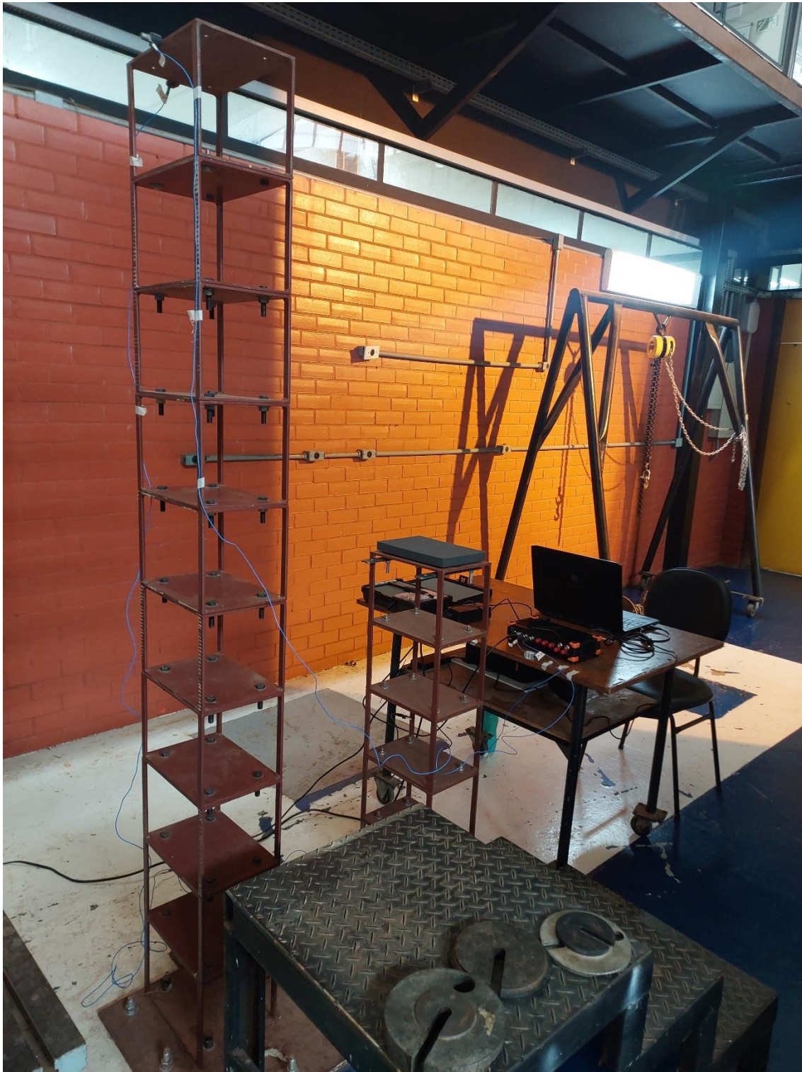
Figura 4.11 – Estrutura de aquisição de dados usada na fase I dos ensaios do Shear Building .
