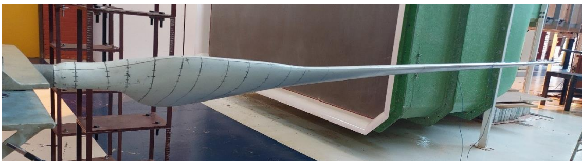
Figura 4.35 – Vista posterior da pá eólica engastada ao suporte inercial GDS.
