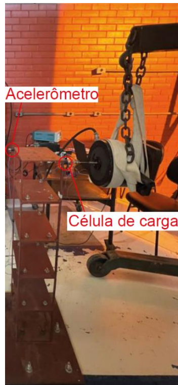
Figura 4.14 – Shaker utilizado por Tavares (2024).
