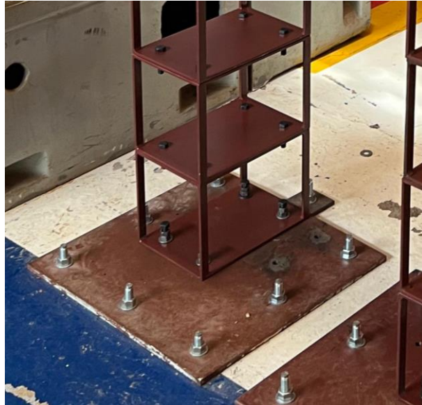
Figura 4.3 – Ancoragem do modelo à laje de reação.
