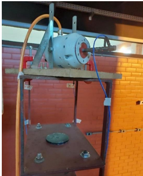
Figura 4.16 – Fixação do Shaker (45º) no topo da estrutura, com massa adicionada no 9º andar.
