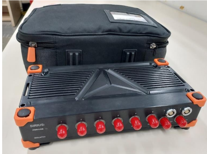
Figura 4.4 – Sistema modular de aquisição SIRIUS Modular (Dewesoft).
