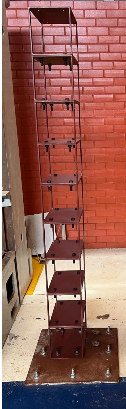
Figura 4.2 – Shear Building com dez pavimentos.
