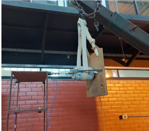
Figura 4.15 – Tentativa de fixação do Shaker externamente a estrutura.
