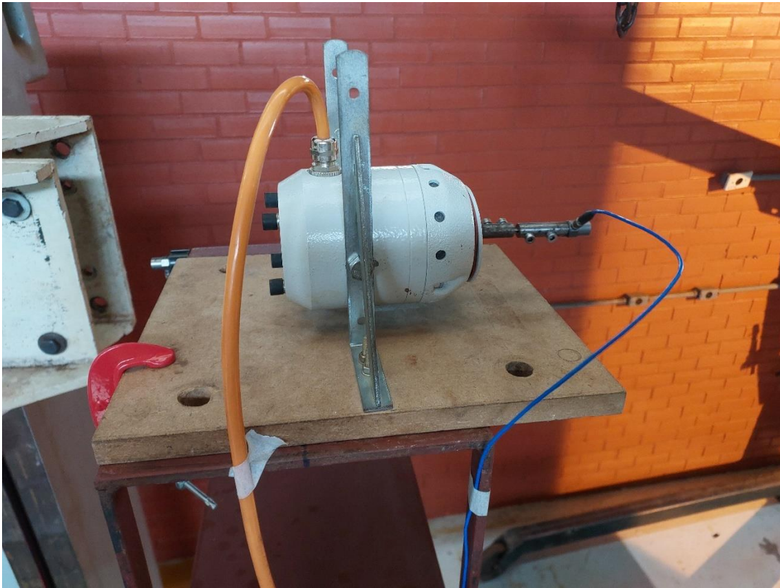
Figura 4.18 – Shaker posicionado no topo da estrutura com acelerômetro conectado.
