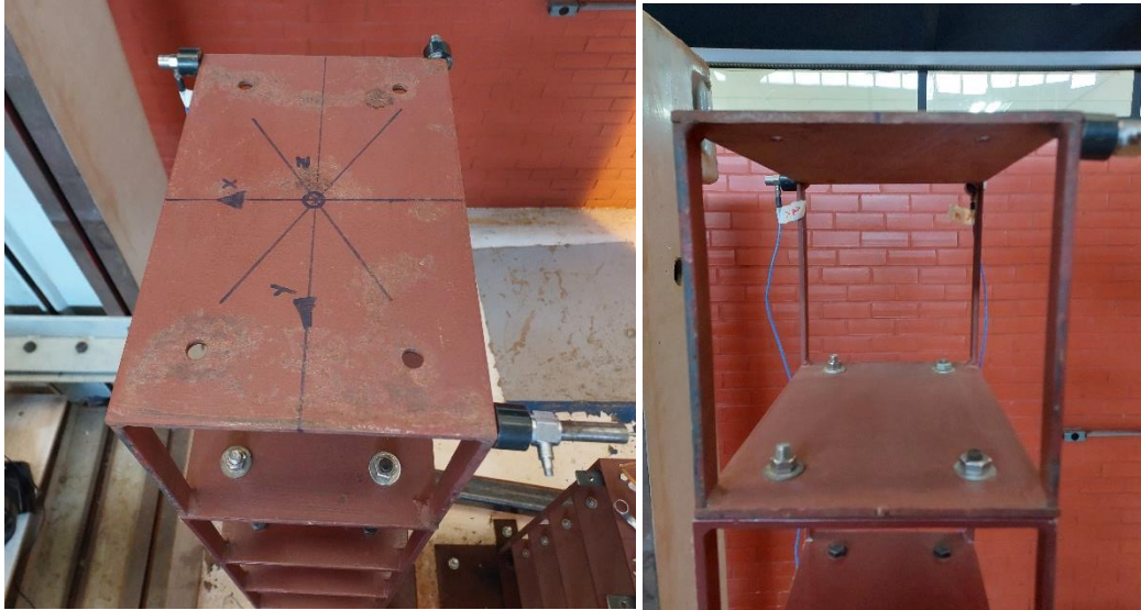
Figura 4.13 – Posicionamento dos acelerômetros em x e y na fase II dos ensaios.
