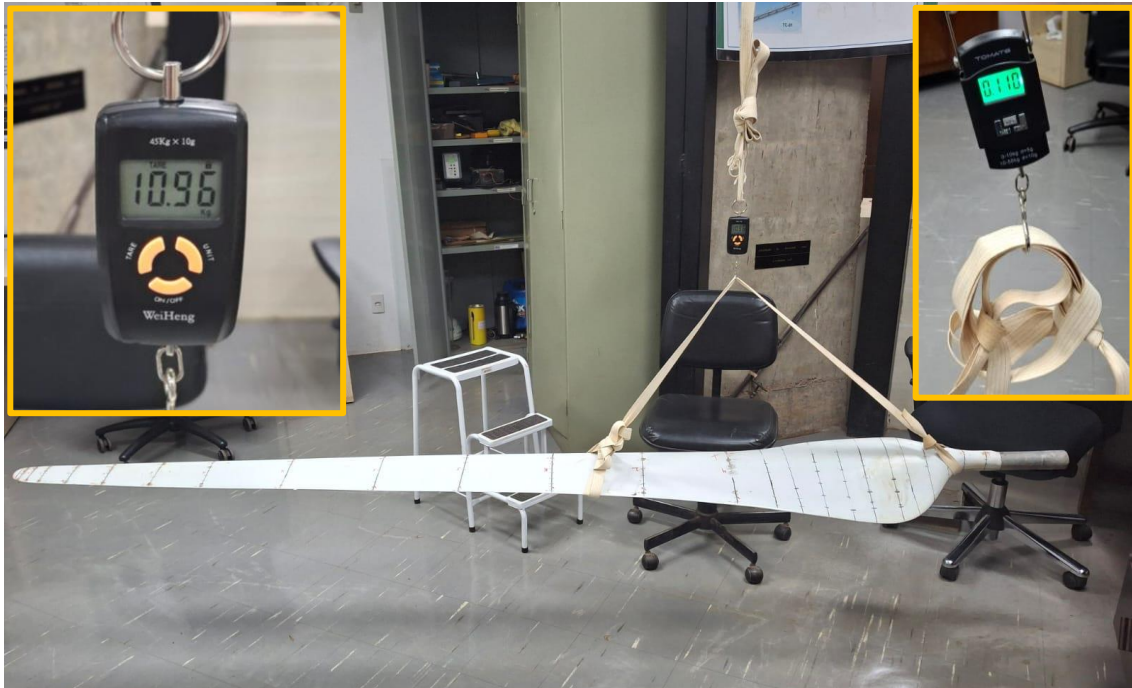
Figura 4.34 – Medição da massa da estrutura.
