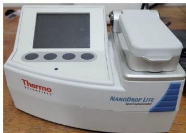
Figura 6. Equipamento de NanoDrop usado para análise das concentrações de DNA nas amostras dos fungos.
