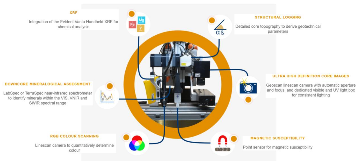
Figura 19. Esquema dos sensores integrados no BoxScan , um sistema avançado de escaneamento de testemunhos desenvolvido para aquisição automatizada de parâmetros geotécnicos e geoquímicos. O equipamento é composto por uma câmera linear de alta resolução RGB, utilizada para capturar imagens detalhadas das amostras, permitindo a análise visual e a correlação de texturas. Além disso, conta com um espectrômetro de infravermelho próximo (NIR), essencial para a identificação mineralógica ao longo das faixas espectrais VIS, VNIR e SWIR. Para a caracterização química, o BoxScan incorpora um analisador de fluorescência de raios X (XRF), possibilitando a determinação elementar precisa. A detecção de propriedades magnéticas é realizada por um sensor pontual de susceptibilidade magnética, fundamental para a diferenciação litológica e a identificação de variações associadas a mineralizações. Complementando o sistema, um scanner a laser linear registra a topografia detalhada do testemunho, fornecendo informações estruturais para análises geotécnicas e modelagem tridimensional.
