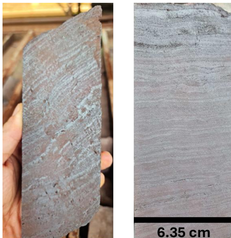
Figura 75. Amostras de testemunho de HC, apresentando o bandamento principal preservado.
