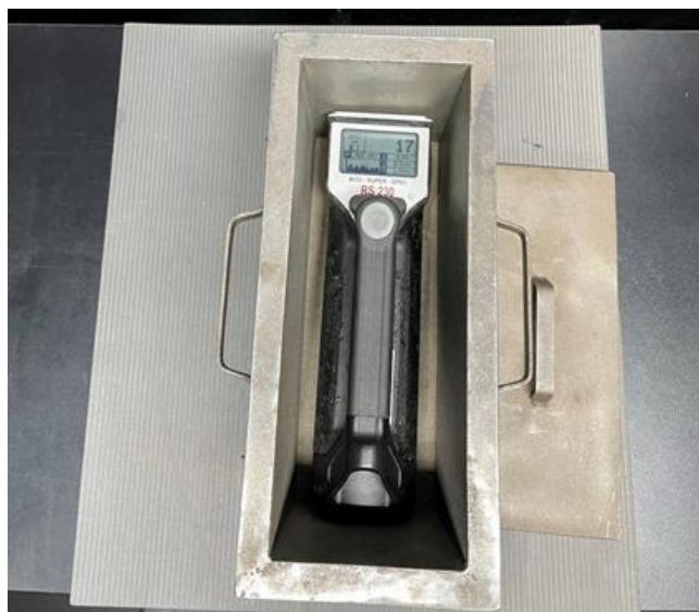
Figura 17. Gamaespectrômetro portátil RS-230, da Radiation Solutions Inc. , utilizado dentro da caixa isolante, constituída em grande proporção por chumbo não radiogênico.
