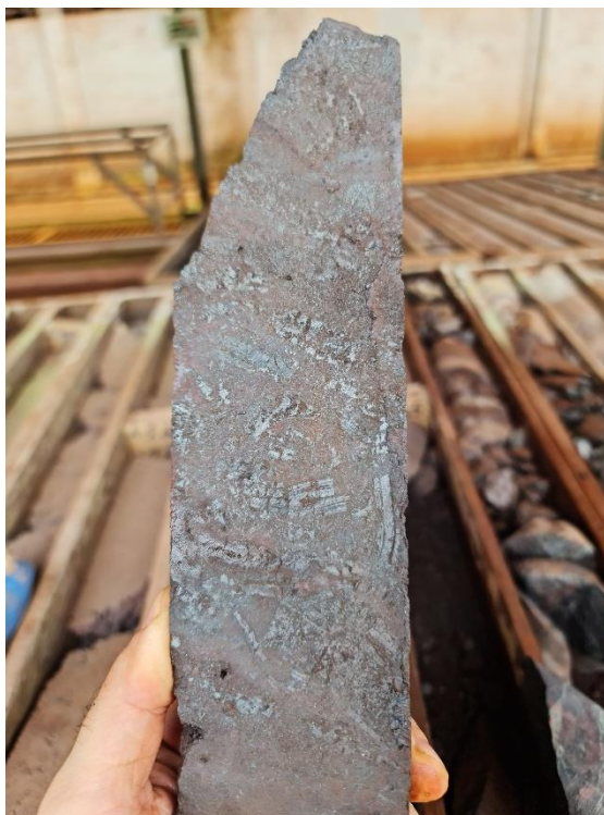
Figura 74. Amostra de HC brechado. Notar as bandas reliquias rotacionadas.
