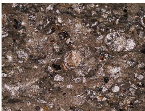
Figura 22. Foraminíferos planctônicos. Extraclastos de plagioclásio e piroxênio presentes no sedimento pelágico. Aumento de 10x.
