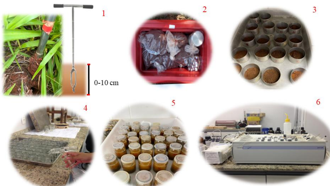
Figura 6. Etapas para realização das coletas e extração do sobrenadante do solo. (1) amostragem de solo com o trado holandês; (2) homogeneização e transporte; (3) pesagem solo úmido e seco pós estufa, para o espaço poroso preenchido por água; (4) SNAP CAPS com 50 ml de solução a base de cloreto de potássio (KCL); (5) solução de KCL mais 15g de solo; (6) análise final no Analisador de Fluxo de Injeção (FIA).
