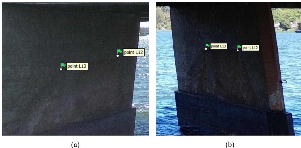
Figura 3.12 – Exemplo de marcadores no Agisoft Metashape® em fotos de diferentes posições. (Fonte: autor)
