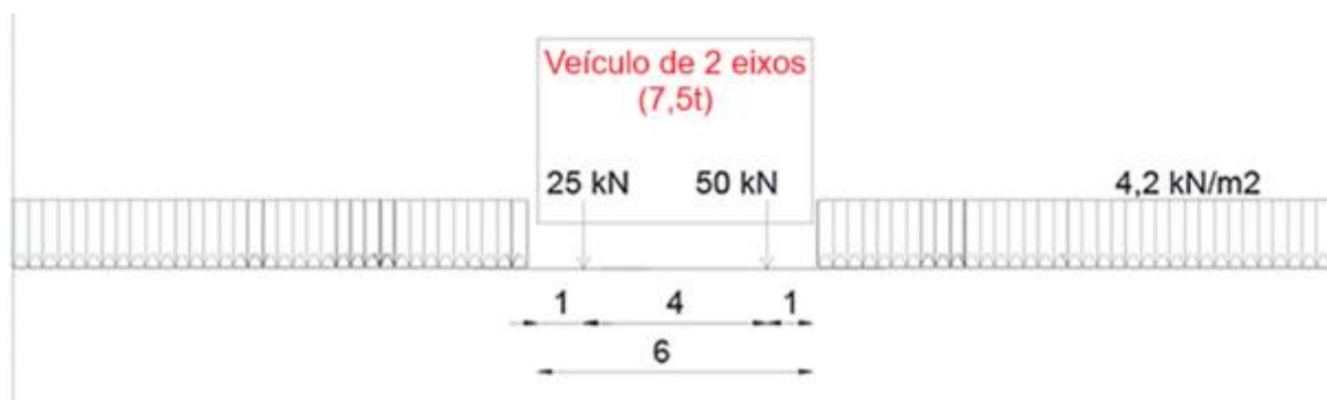
Figura 3.15 – Trem-tipo para veículos leves – 7,5 toneladas. (Fonte: MIMS, 2022, traduzido).
