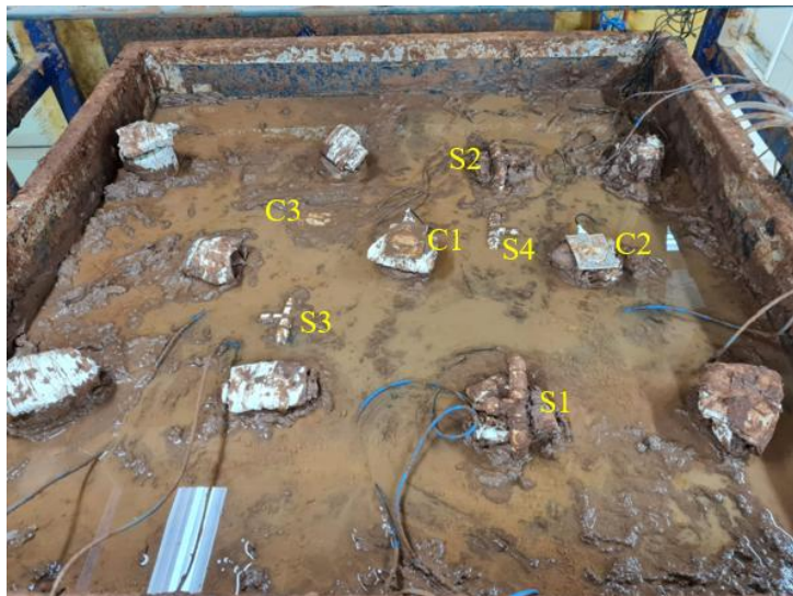
Figura 3.17. Colunas granulares encamisadas instaladas no solo mole dentro da caixa de ensaio.
