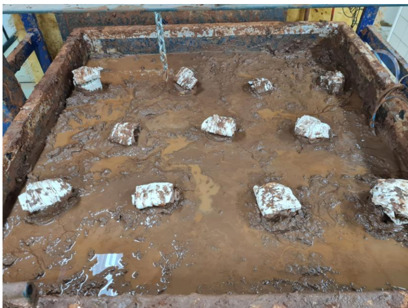
Figura 3.16. Colunas granulares encamisadas instaladas no solo mole dentro da caixa de ensaio.
