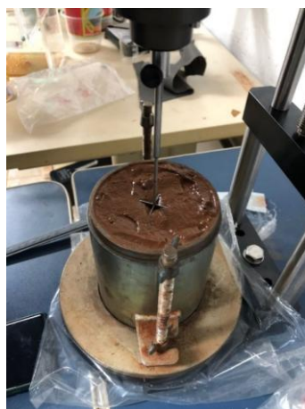
Figura 3.4. Ensaio de palheta aplicado no solo mole argiloso
