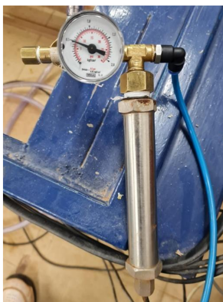
Figura 3.12. Processo de calibração dos transdutores de poropressão
