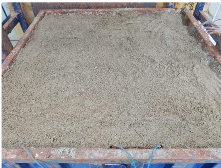
Figura 3.18. Colocação do aterro na caixa de ensaio.
