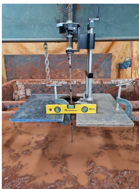
Figura 3.15. Ensaio de palheta para a medição da resistência não drenada ( S_u ) do solo mole dentro da caixa de ensaio.
