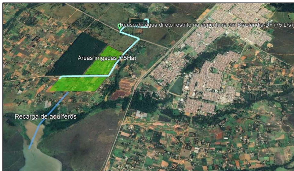
Figura 24 - Representação da ETE Brazlândia croqui de sistema de Abastecimento de Água de Reúso (SAAR) para propriedades do assentamento rural Maranhá
