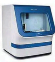
Separação dos fragmentos por Eletroforese Capilar.
