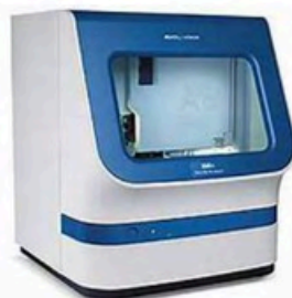
Separação dos fragmentos por Eletroforese Capilar.
