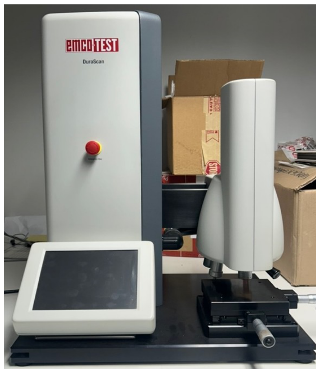
Figura 8: Microdurômetro, DuraScan 20, utilizado para mensurar a MV das amostras.
