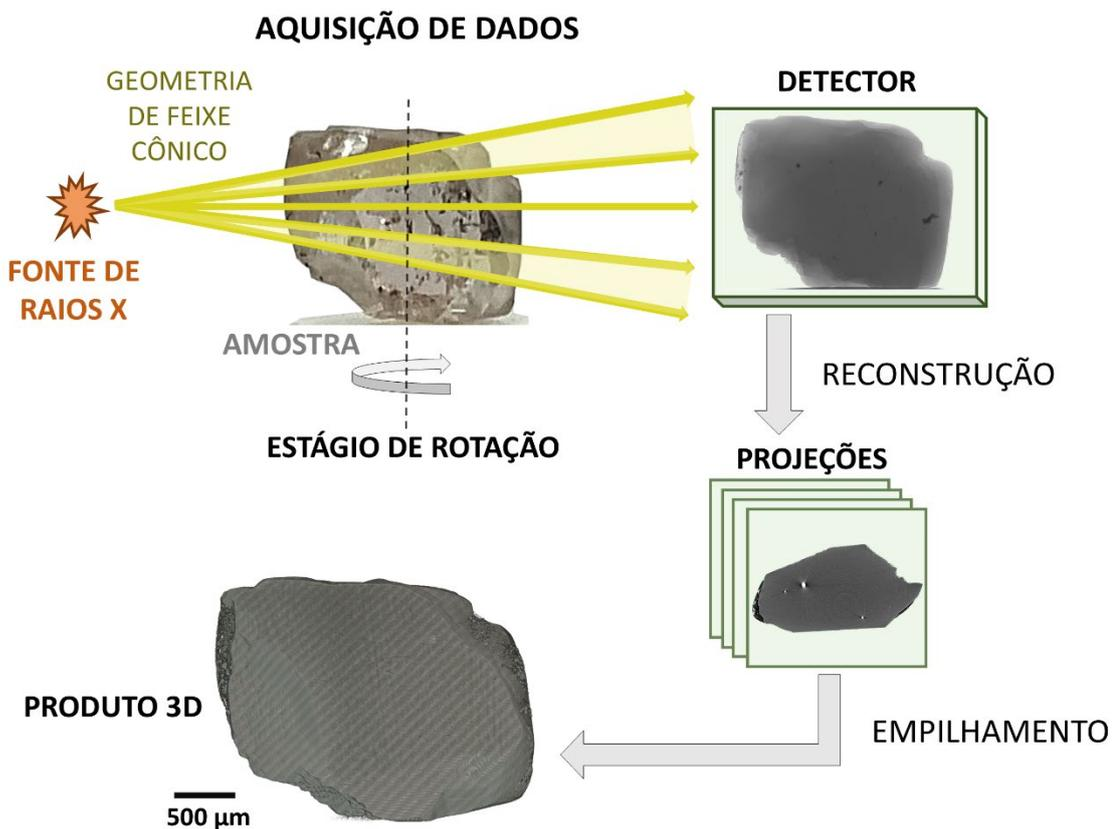
Figura 9. Etapas de aquisição e geração de dados no microtomógrafo Skyscan 1172 (Bruker). A amostra é girada para a captura de projeções em diferentes ângulos, cujas imagens 2D são reconstruídas para gerar uma visualização 3D (Fonte: adaptado de Guntoro *et al.*, 2019).
