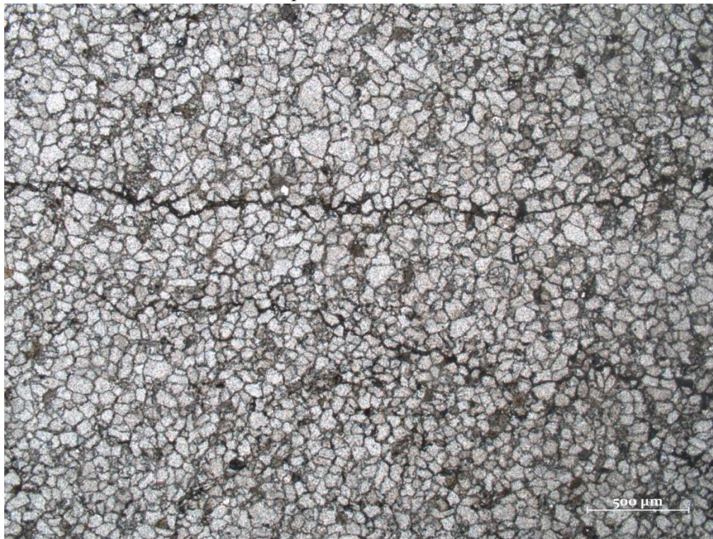
Figura 4.12 - Quartzito com dupla porosidade. Predomínio da porosidade intergranular sobre a fraturada, evidenciando intemperismo avançado. Os grãos de feldspato apresentam-se alterados e parcialmente removidos.
