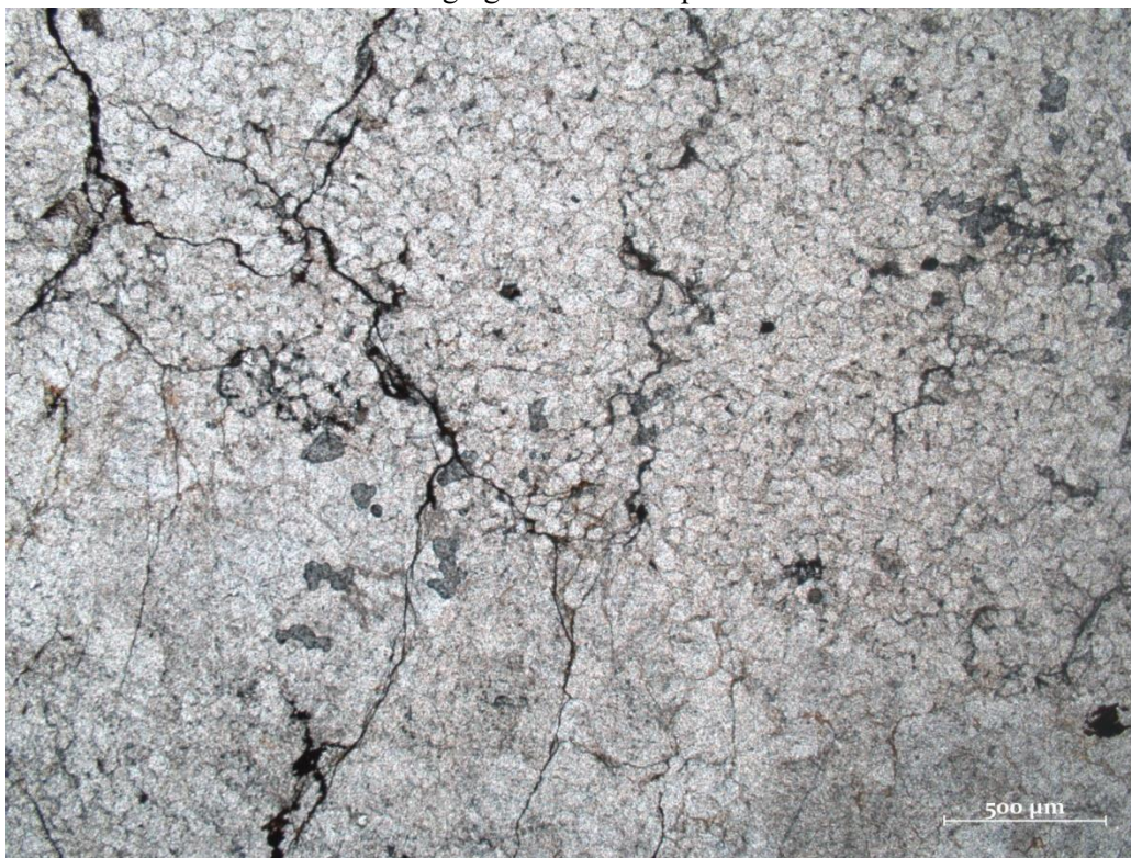
Figura 4.14 - Contato de aquífero de dupla porosidade com poros matriciais e intergranulares (porção superior da imagem), com porção intensamente silicificada e micro fraturada classificada como meio exclusivamente fraturado (porção inferior).
