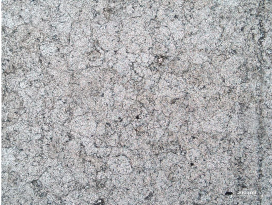
Figura 4.10 - Quartzito fraturado e silicificado. Porosidade exclusivamente secundária planar, com poros primários completamente cimentados por quartzo.
