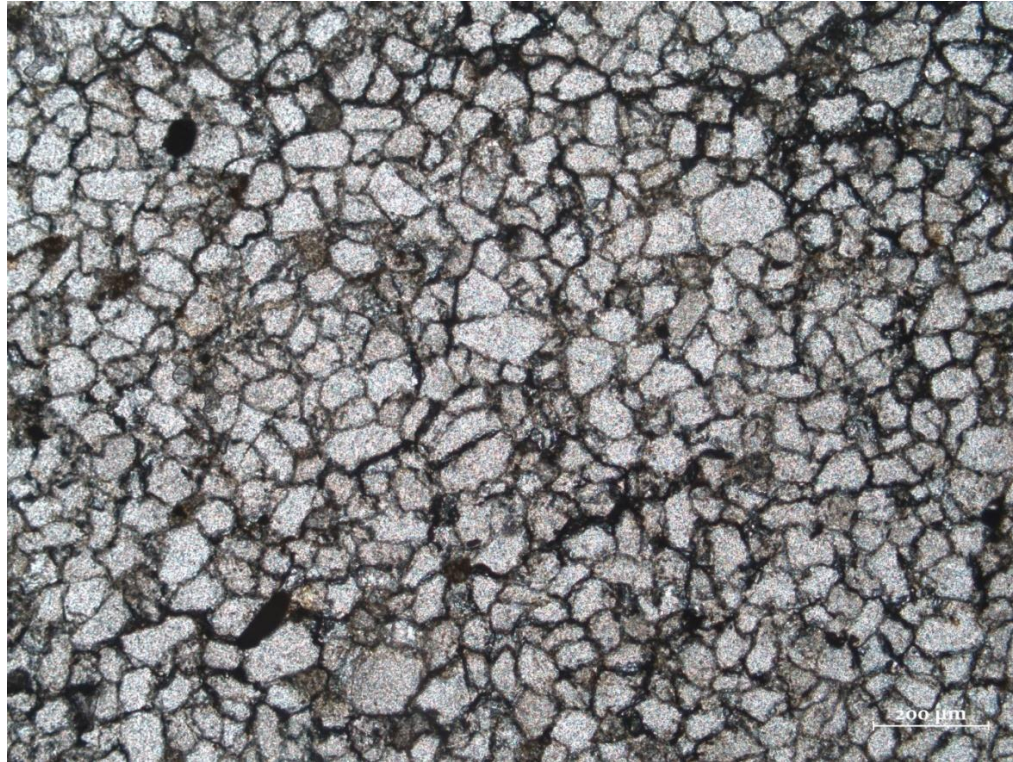
Figura 4.13 - Quartzito intensamente intemperizado. Porosidade exclusivamente intergranular, com matriz desagregada e fraturas pouco ativas.
