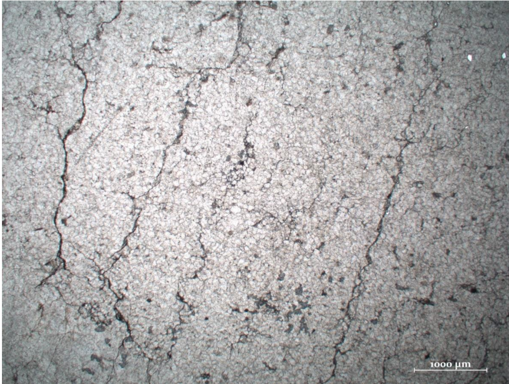
Figura 4.11 - Quartzito com início de abertura de porosidade intergranular. A dissolução parcial do cimento gera poros residuais entre os grãos. A porosidade secundária planar também é evidente nos planos oxidados.
