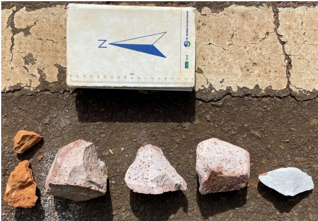
Figura 4.4 - Sequência de amostras mesoscópicas de quartzito que ilustra a sequência contínua de alteração e evolução da porosidade, do nível mais intemperizado (friável), com visível desagregação dos grãos e perda de coesão, que predomina porosidade intergranular, até o nível mais maciço fortemente silicificado (compacto) com porosidade única planar secundária. A sequência evidencia a heterogeneidade textural e estrutural típica da dupla porosidade, fundamental para o comportamento hidrogeológico do aquífero R 3 /Q 3 .
