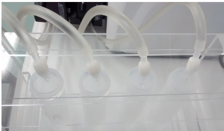
Figura 23. Frascos de PFA e cartuchos de extração na etapa de recuperação dos ETR com HCl 6 mol/L.
