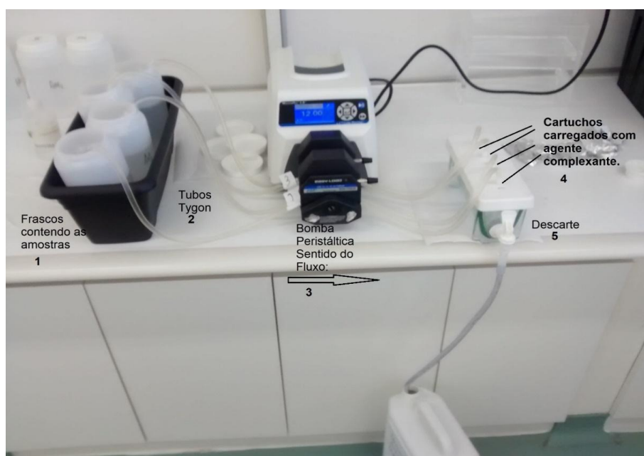
Figura 22. Sistema de extração de ETR em águas naturais com os seus componentes indicados.
