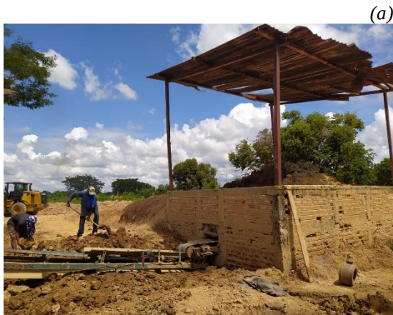
Figura 79: Material na caixa alimentadora (a) e seguindo por correia transportadora enquanto são retiradas as raízes presentes no material na Empresa C (b).
