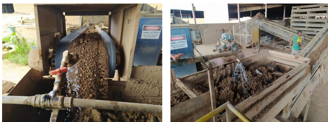
Figura 67: Ajuste da quantidade de água necessária no misturador na Empresa A.
