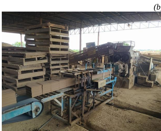
Figura 69: Material passando pela extrusora (a) e material passando pela etapa de corte na Empresa A (b).
