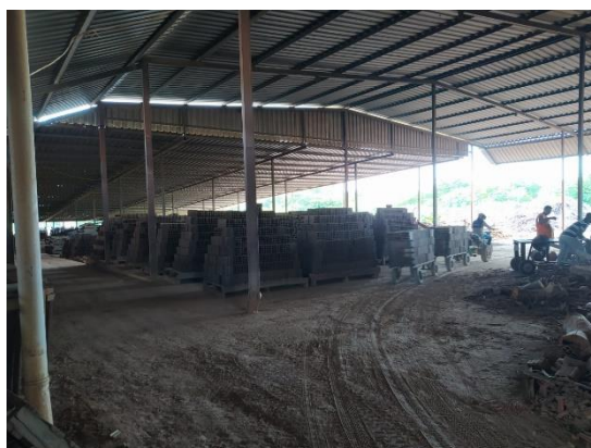
Figura 70: Peças fabricadas são mantidas em temperatura ambiente, no interior do galpão, sem incidência de luz solar ou vento para secagem na Empresa A.
