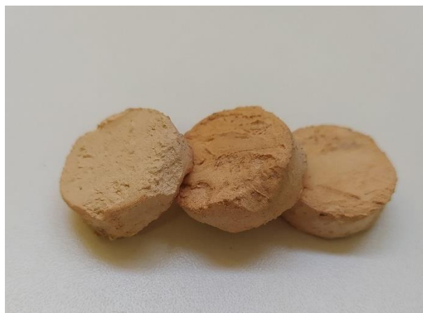
Figura 21: Discos das pastas a serem ensaiadas no Ensaio R 3 .
