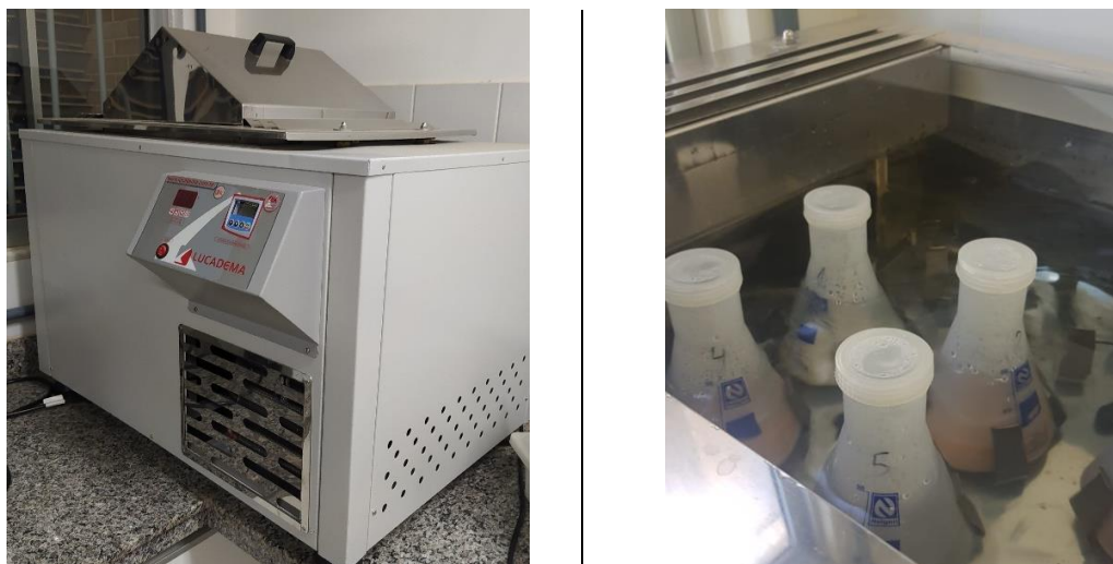
Figura 19: Amostras em Erlenmeyer polimérico sob banho-maria termostatzado com agitação tipo “dubnoff”.
