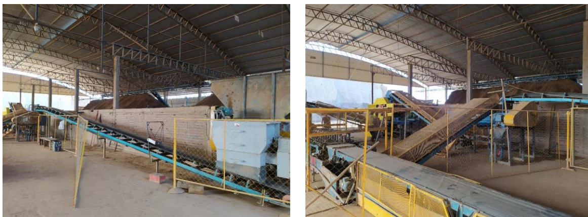
Figura 75: Material seguindo por correia do misturador até o laminador na Empresa B.
