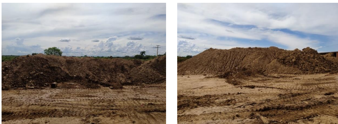
Figura 65: Argila coletada pela Empresa Cerâmica A depositada a céu aberto.
