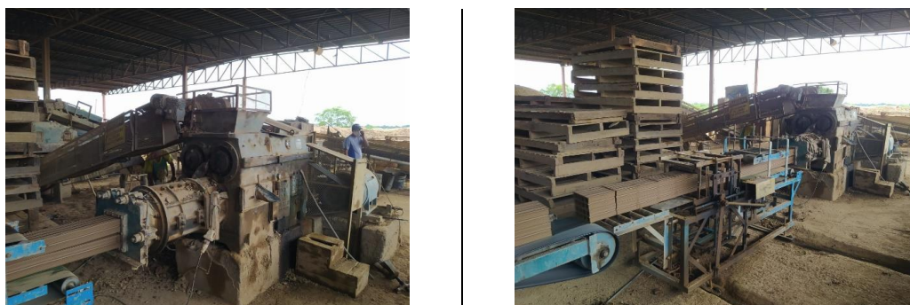
Figura 9: Massas argilosas in natura passando pela extrusora (esquerda) e na sequência passando pela etapa de corte (direita).
