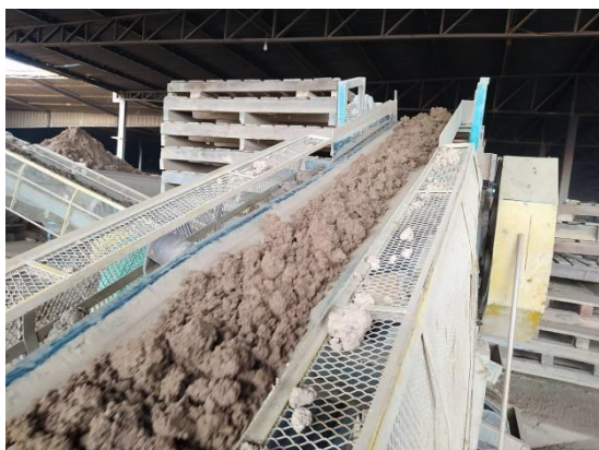
Figura 68: Material seguindo por correia do misturador até o laminador (a) e material passando no laminador na Empresa A (b).
