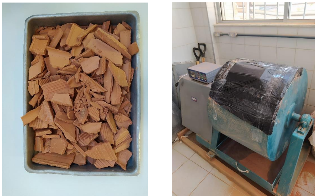
Figura 16: Blocos danificados fragmentados (esquerda) e aparelho de abrasão Los Angeles (direita).
