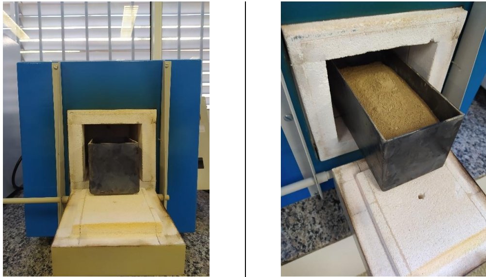
Figura 14: Amostras calcinadas em recipiente metálico na mufla até atingir a temperatura de 800 °C.
