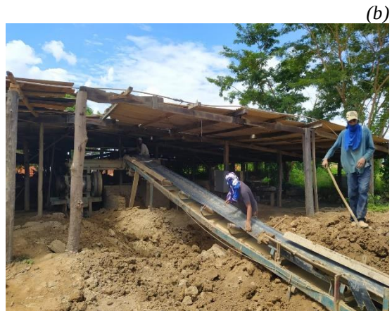
Figura 79: Material na caixa alimentadora (a) e seguindo por correia transportadora enquanto são retiradas as raízes presentes no material na Empresa C (b).
