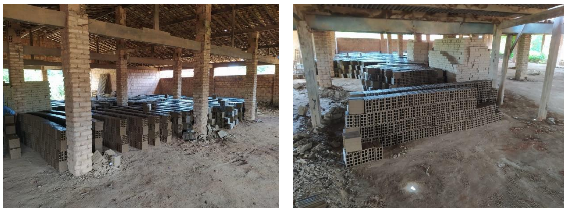
Figura 82: Peças fabricadas pela Empresa B sendo mantidas em galpão para a secagem.
