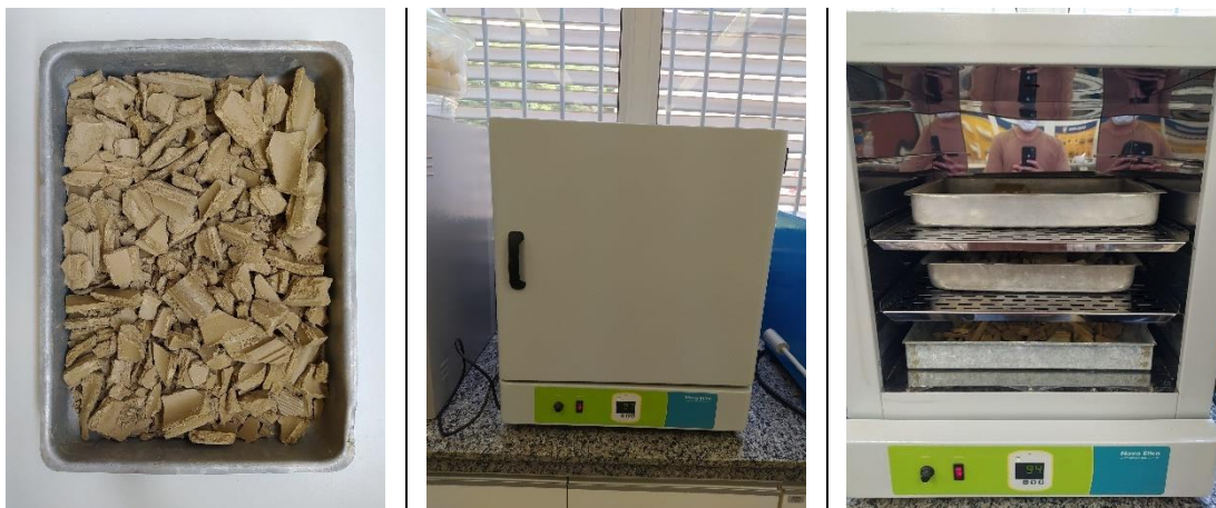
Figura 10: Fragmentos de blocos extrudados úmidos acondicionados em estufa para secagem.
