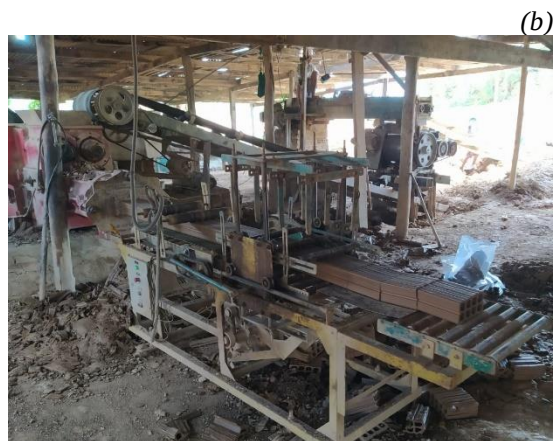
Figura 81: Material saindo da extrusora (a) e etapa de corte mecanizado na Empresa B (b).
