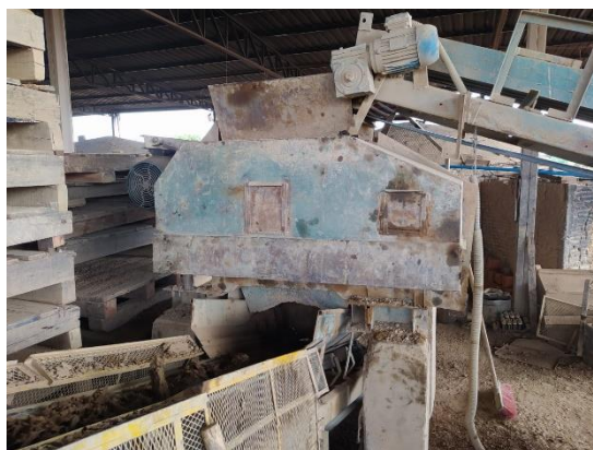
Figura 68: Material seguindo por correia do misturador até o laminador (a) e material passando no laminador na Empresa A (b).
