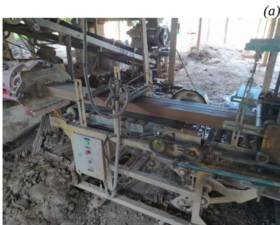
Figura 81: Material saindo da extrusora (a) e etapa de corte mecanizado na Empresa B (b).
