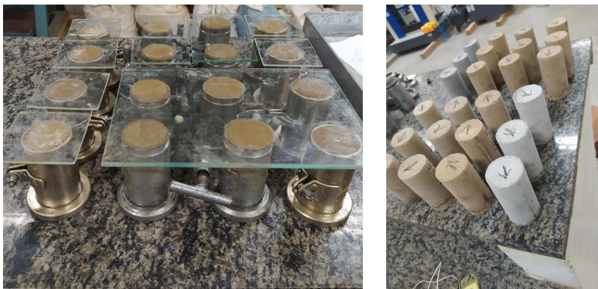
Figura 24: Corpos de prova de argamassas para o ensaio de índice de desempenho (ID).
