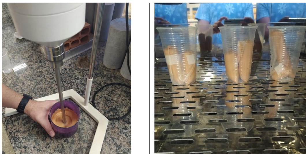
Figura 20: Mistura de pastas para o teste R 3 (esquerda) e pastas moldadas em recipientes plásticos na estufa (direita).
