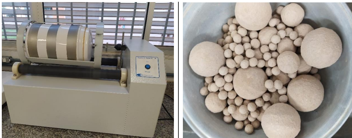
Figura 12: Jarro e moinho de bolas (esquerda) e esferas de alumina de diferentes diâmetros (direita).
