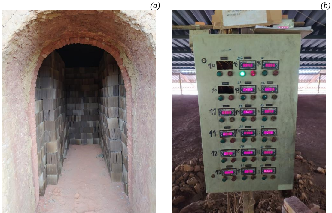
Figura 72: Blocos secos dentro de uma das câmaras do forno cedan antes do início da queima (a) e painel de controle de temperatura de piso e teto de algumas câmaras do forno cedan da Empresa Cerâmica A (b).
