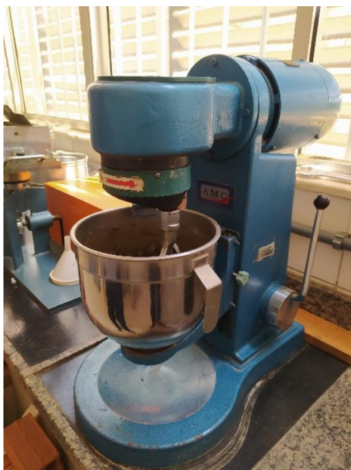
Figura 22: Mistura mecânica para preparo de argamassas para o ensaio de índice de desempenho (ID).
