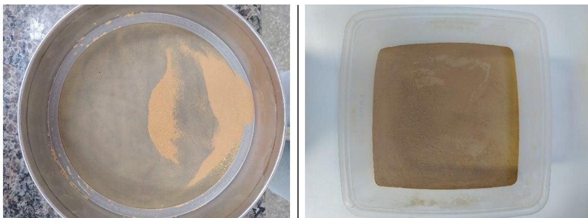
Figura 13: Argila in natura sendo peneirada na malha de 150 \mu\text{m} (esquerda) e material após o peneiramento (direita).
