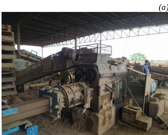
Figura 69: Material passando pela extrusora (a) e material passando pela etapa de corte na Empresa A (b).
