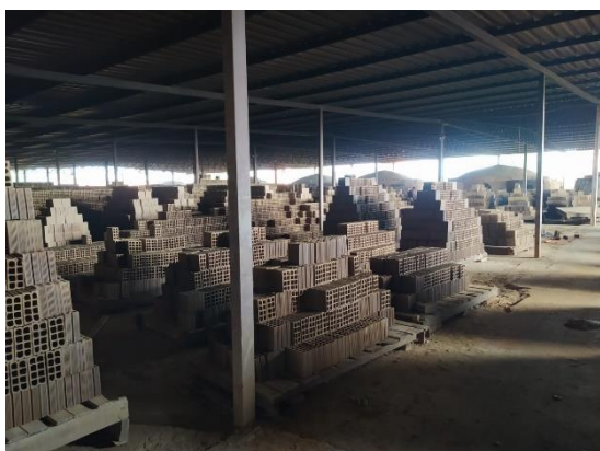
Figura 70: Peças fabricadas são mantidas em temperatura ambiente, no interior do galpão, sem incidência de luz solar ou vento para secagem na Empresa A.
