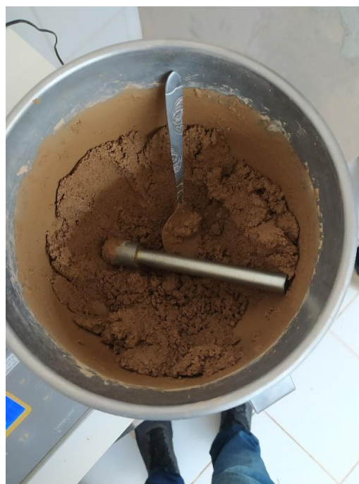
Figura 22: Mistura mecânica para preparo de argamassas para o ensaio de índice de desempenho (ID).
