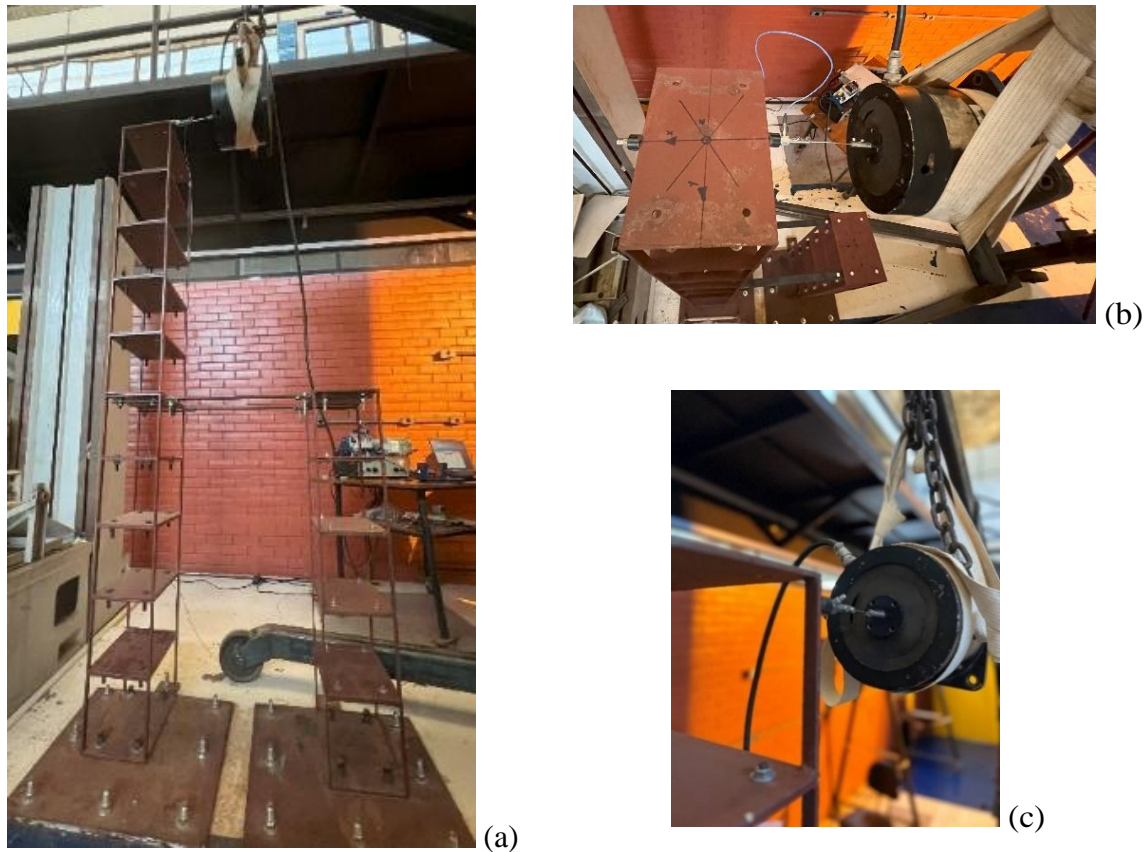
Figura 6.36– Ensaio com excitador de vibração nos edifícios acoplados, em (a) ensaio excêntrico; em (b) vista superior do ensaio sem excentricidade; em (c) detalhe da fixação do excitador no ensaio excêntrico.
