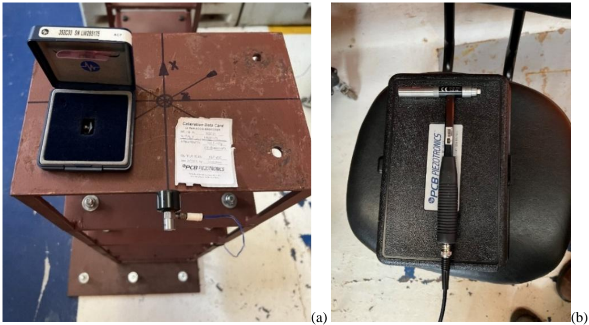
Figura 6.5– Sensores utilizados para os ensaios em vibração livre: (a) acelerômetro e (b) martelo de impacto ambos PCB Piezotronics.
