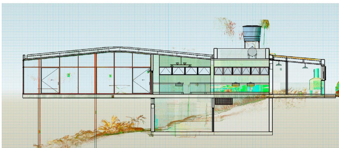
Figura 24 — Corte longitudinal do modelo HBIM da Casa de Vidro, sobreposto com a imagem de nuvem de pontos. Em preto: vista wireframe do modelo BIM, em cores: nuvem de pontos
