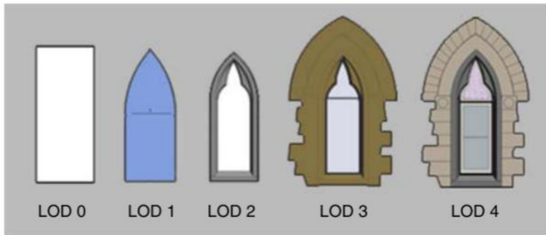
Figura 17 — Nível de detalhamento CIMS para uma janela
