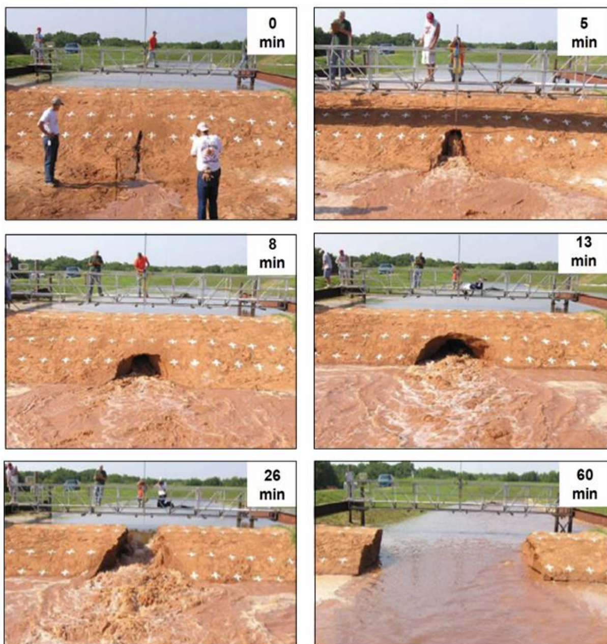
Figura 6 – Evolução da ruptura do modelo de barragem em larga escala (Hanson et al. , 2010).
