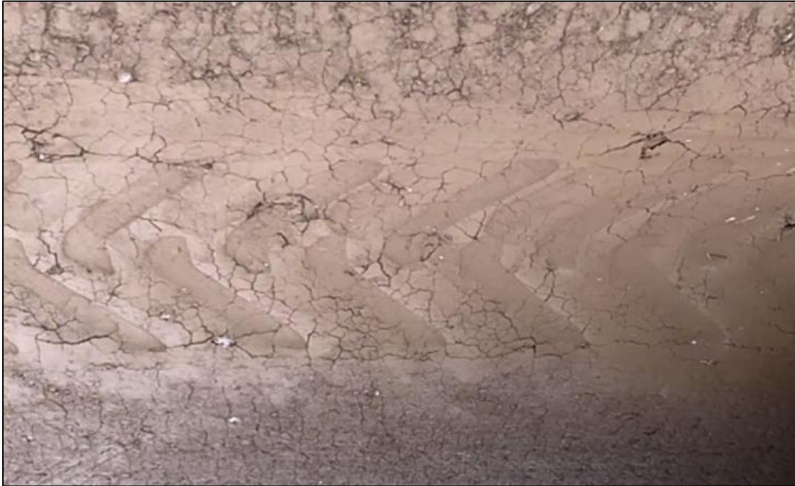
Figura 4.13 – Presença de “borrachudo” na 6ª camada do aterro experimental compactado após a realização de seis passadas
