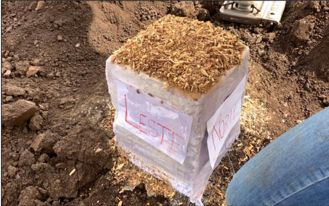
Figura 4.10 – Bloco indeformado 01, com dimensões de 35x35x35cm
