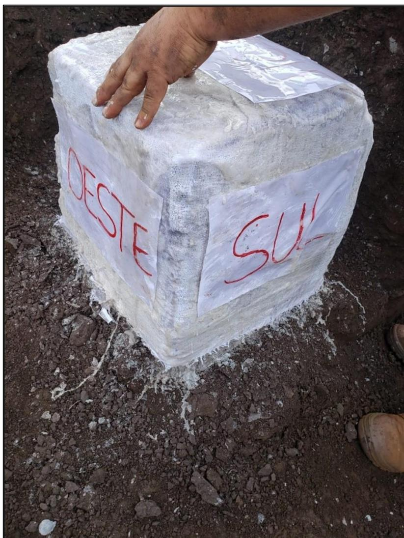
Figura 4.14 – Bloco indeformado 02, com dimensões de 35x35x35cm
