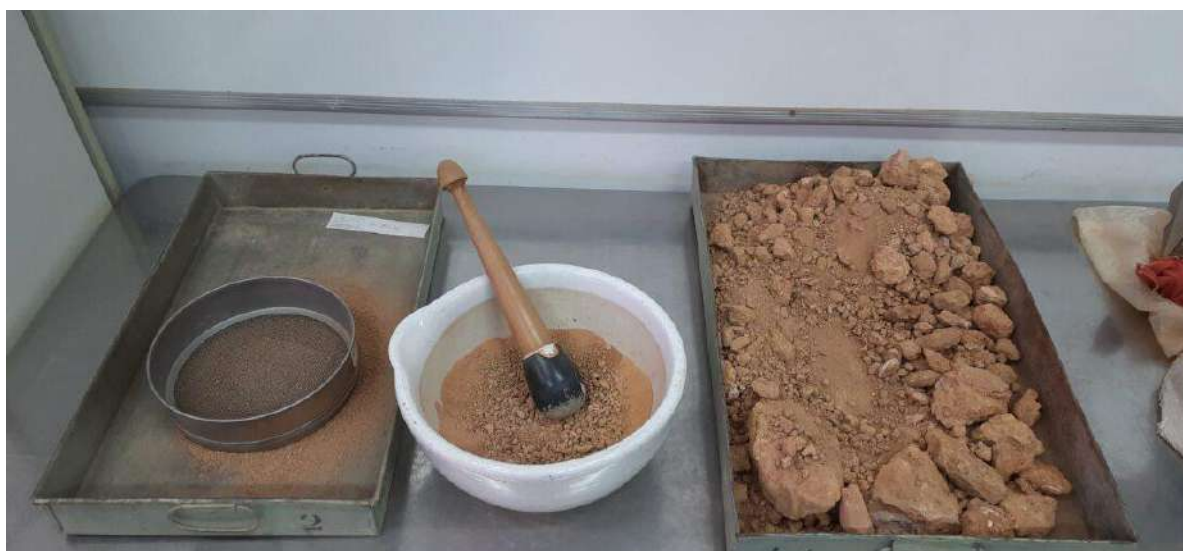
Figura 3.32 - Destorroamento do solo.
