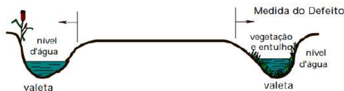
Figura 2.29 - Drenagem lateral inadequada com severidade alta (ODA, 1995).
