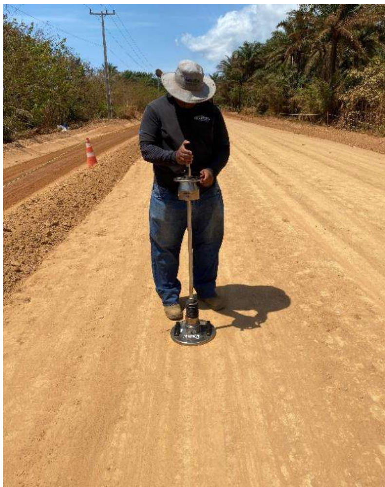
Figura 3.60 - Medidas de deflexão com o LWD após a implantação da seção 1.
