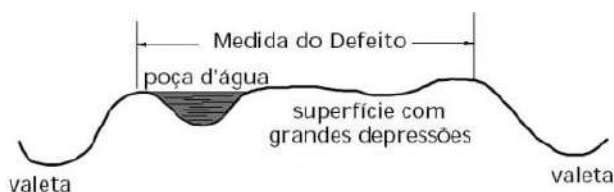
Figura 2.26 - Seção transversal inadequada com severidade alta (ODA, 1995).
