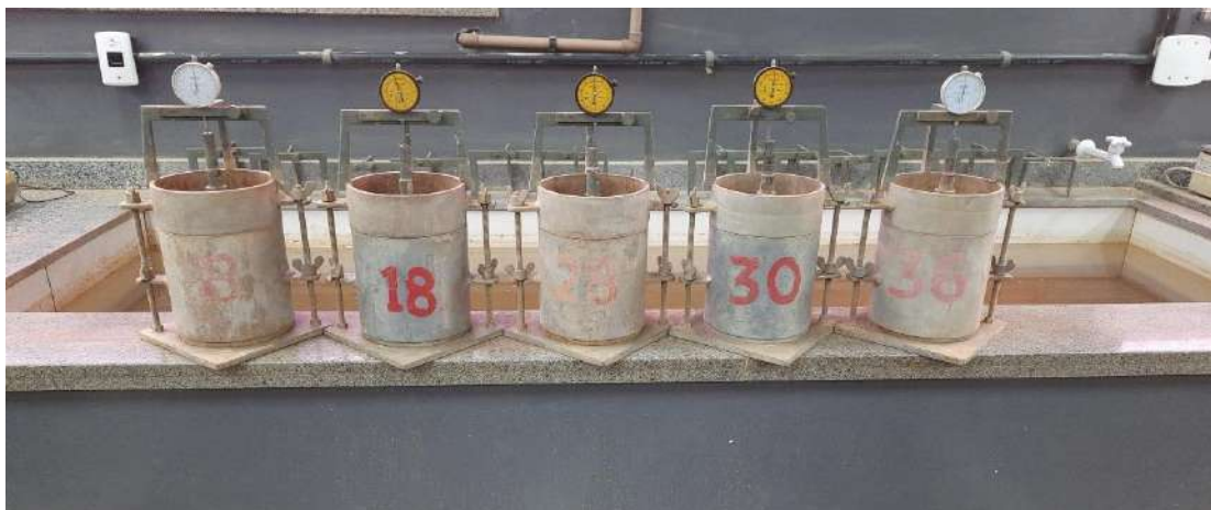
Figura 3.51 - Preparo dos cilindros para imersão em tanque para ensaio de CBR e expansão.
