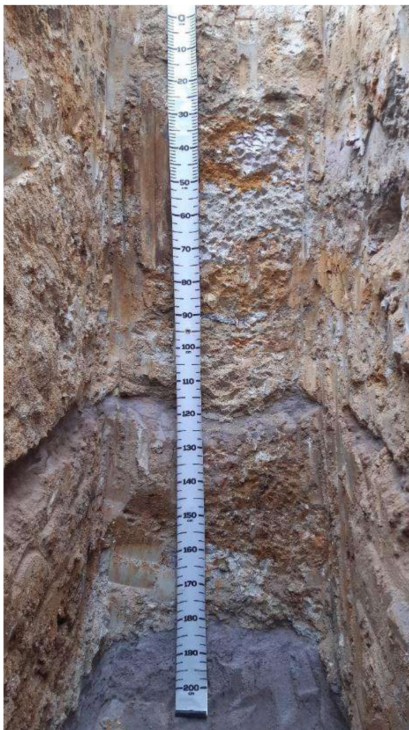
Figura 3.42 - Perfil de solo na trincheira escavada no leito do segmento experimental (T2).
