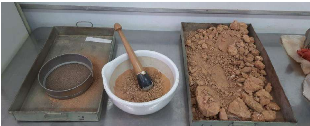
Figura 3.48 - Destorroamento do solo.
