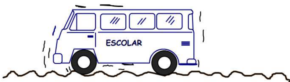
Figura 2.30 - Corrugações nas estradas não pavimentadas (ODA, 1995).
