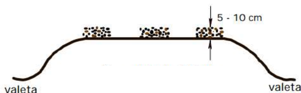
Figura 2.36 - Segregação de agregados com severidade média (ODA, 1995).
