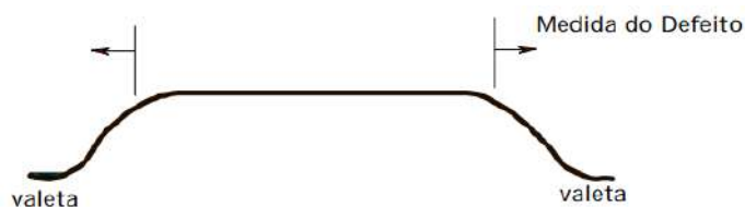
Figura 2.27 - Drenagem lateral inadequada com severidade baixa (ODA, 1995).
