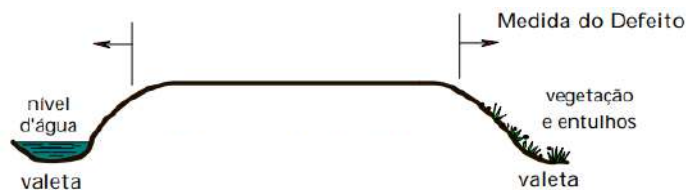
Figura 2.28 - Drenagem lateral inadequada com severidade média (ODA, 1995).
