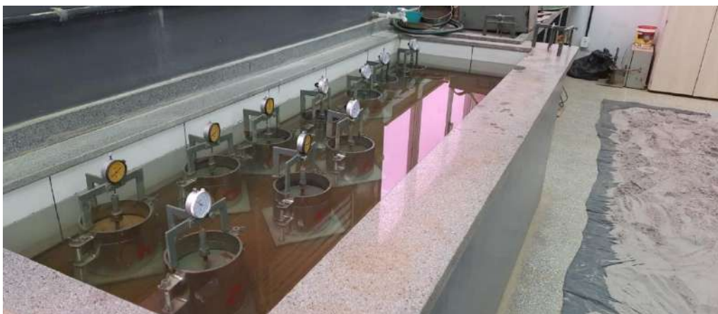
Figura 3.52 - Cilindros imersos no tanque para ensaio de CBR e expansão.
