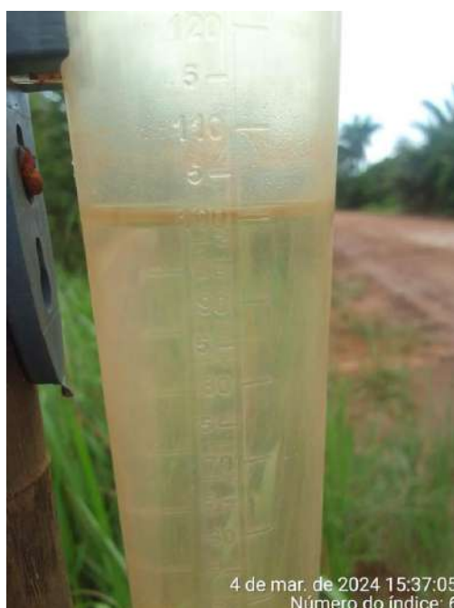
Figura 4.46 - Medida de pluviômetro analógico instalado na região do segmento experimental.
